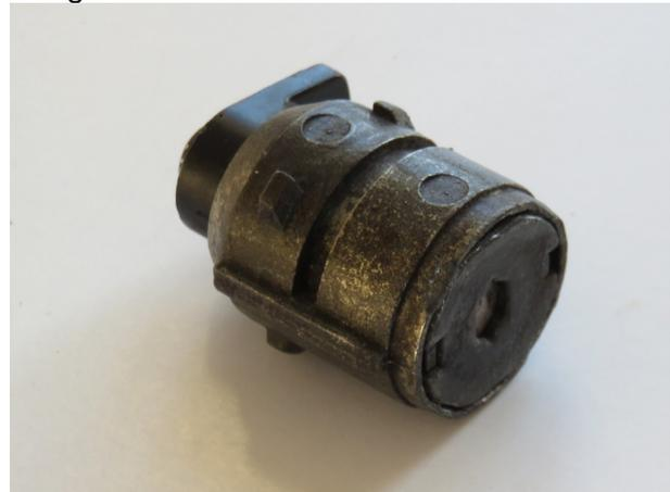
Schutzklappe und Deckel einsetzen, Gehäusekante wieder an Deckel anpressen. Schließhaken und Sprengring ansetzen. Schloß evtl wieder in die Plastikfassung einklipsen.
