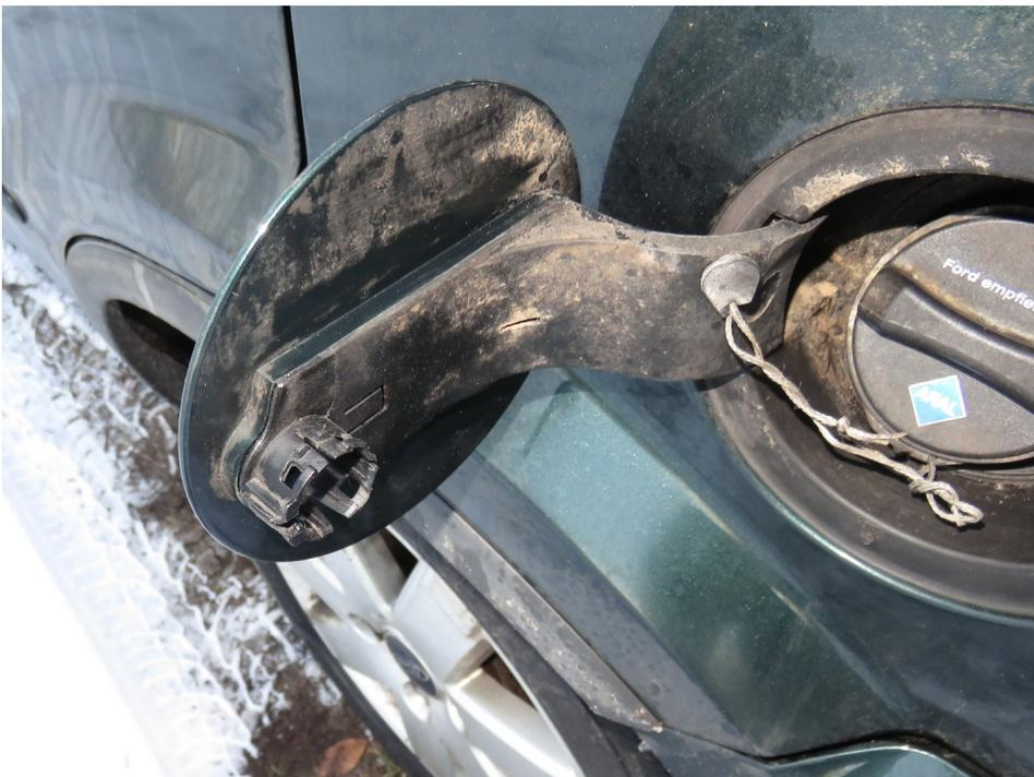
Schließhaken mit Sprengring lösen
