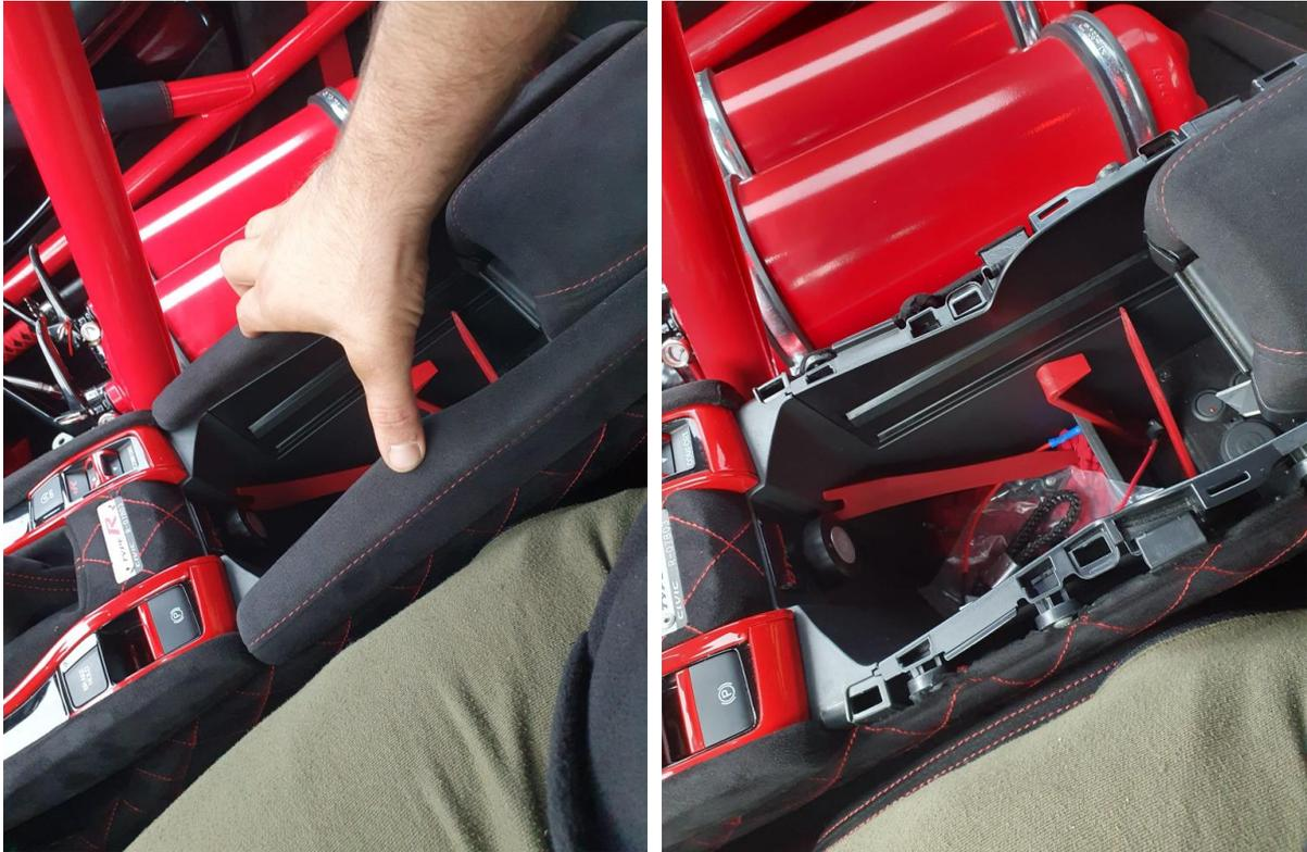
Im zweiten Schritt muss die Seitenverkleidung um den Schaltknauf demontiert werden. Dazu diese bitte nach oben ziehen.
