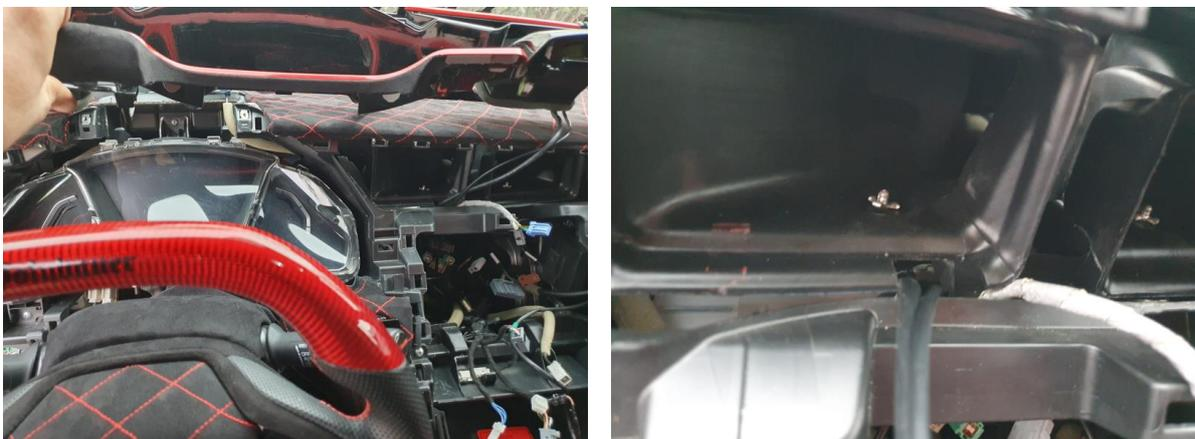
Das rote Kabel des OBD-Steckers muss mit dem Sicherungsadapter an einem Steckplatz mit Zündungsplus verkabelt werden.
