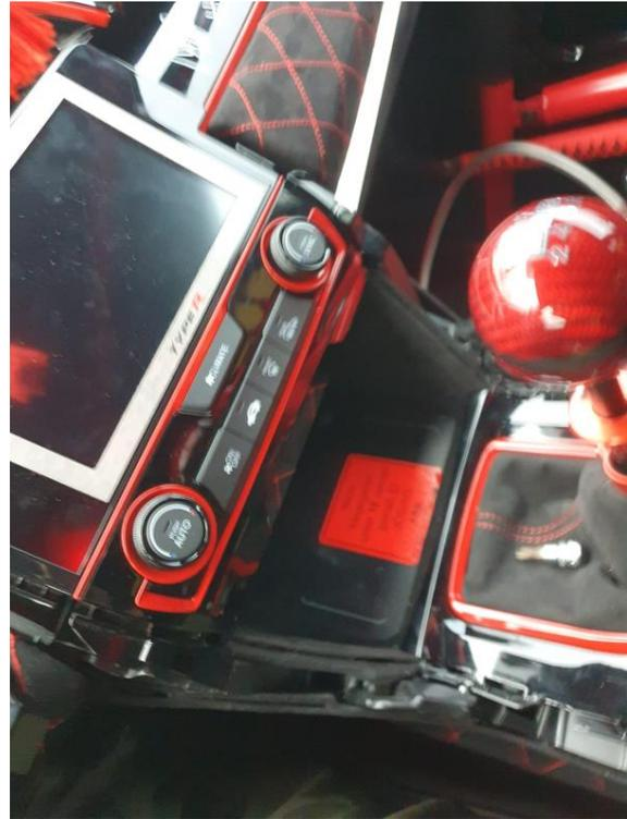
Nun kann die Lüftungseinheit an beiden Seiten gepackt und zu dir gezogen werden. Anschließend können die Stecker auf der Rückseite vorsichtig entfernt und die Lüftungseinheit bei Seite gelegt werden.
