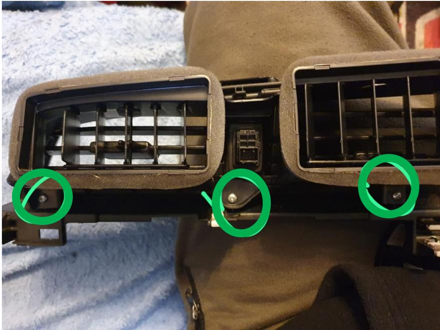
Nun müssen noch die Lamellen aus der Lüftung entfernt werden. Dazu müssen diese nach vorne herausgezogen werden.
