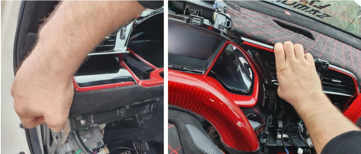
Ziehe die Abdeckung so weit heraus, dass du den rückseitigen Stecker für den Warnblinkerschalter lösen kannst. Hast du diesen gelöst, kannst du die Blende vollständig abnehmen.
