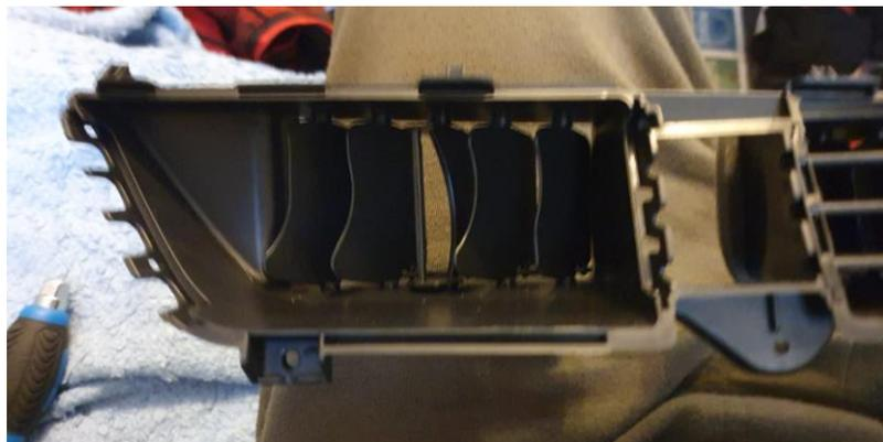
Nun kannst du die Kabel von hinten durch die Lamellen führen und an deinem Datendisplay anstecken. Und dieses in Position drücken.
