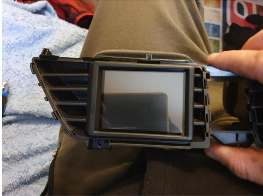
Nun kannst du, bevor du alles wieder in umgekehrter Reihenfolge zusammenbaust, kurz die Zündung einschalten und das Display auf Funktion prüfen. Ist diese gegeben kannst du das Fahrzeug komplettieren und bist fertig.
