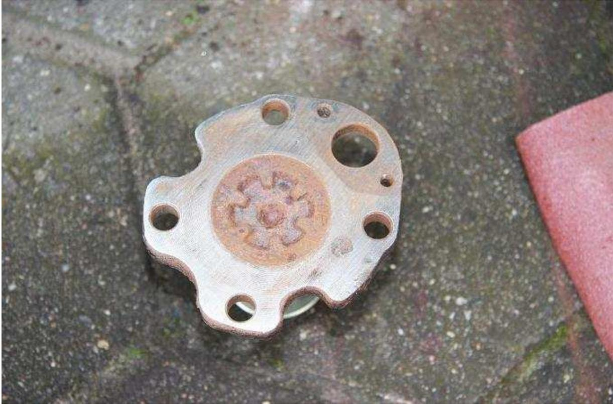
Anlagefläche Achszapfen abschmiegeln
