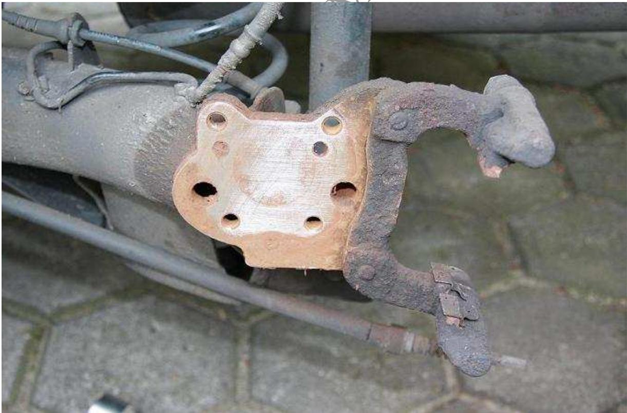
Anlagefläche Achse abschmiegeln
