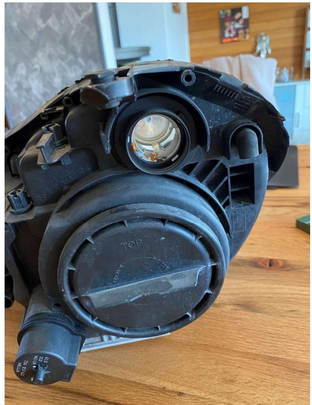
7. Dichtmasse an den 3 Reflektorhaltestellen entfernen
