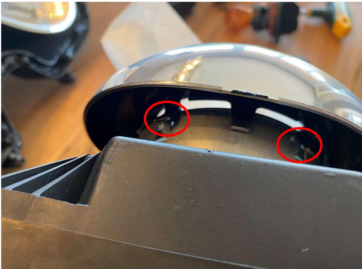
14. Kunststoffrahmen entfernen (4 Schrauben Torx 20)
