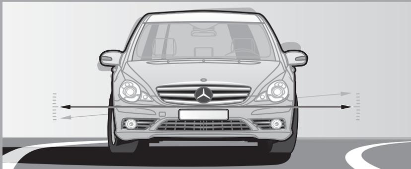
**AIRMATIC-Paket.** Die Luftfederung arbeitet mit dem Adaptiven Dämpfungs-System ADS, das die Stoßdämpferkraft automatisch an die Fahrsituation anpasst. Dadurch lassen sich Wank- und Nickbewegungen – z. B. bei schneller Kurvenfahrt oder auf schlechter Straße – reduzieren.
