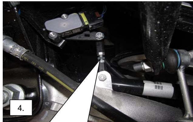
Fahrzeug gegen Wegrollen sichern und Motor starten. Eibach Regelstange über die Einstellschraube, soweit zusammendrehen (1 Umdrehung ca. 8mm) bis der Höhenstand lt. Teilegutachten, siehe Seite 19, Punkt IV.7 und 8 erreicht wird. Beide Seiten der Eibach Regelstange kontern.
