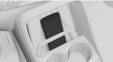
Das Mobiltelefon hochkant und mittig hinter der Haltespange einsetzen und bis zum Anschlag nach unten schieben. Das Display des Mobiltelefons muss nach oben zeigen.
