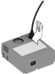
3. Ventilkappe am Rad abschrauben und das Verbindungsstück des Schlauchs auf das Ventil schrauben.
