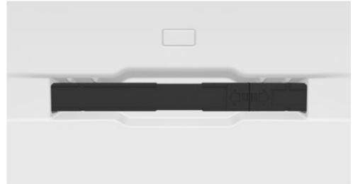
Die Unterbringung des Warndreiecks ist auf der Innenseite der Heckklappe vorgesehen. Das Warndreieck zur Seite schieben und herausnehmen.
