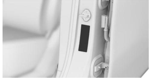
Die Reifenfülldruckangaben befinden sich an der Türsäule der Fahrertür.
