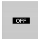
In der Instrumentenkombination wird OFF angezeigt. Der Antrieb ist ausgeschaltet und die Betriebsbereitschaft eingeschaltet.
