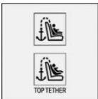
Das entsprechende Symbol zeigt den Befestigungspunkt für den oberen Haltegurt.
