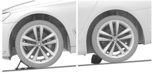
Wenn bei leichtem Gefälle ein Radwechsel durchzuführen ist, Keile und andere geeignete Gegenstände, z. B. Steine, entgegen der Roll-richtung unter die Räder der Vorder- und Hinterachse legen.
