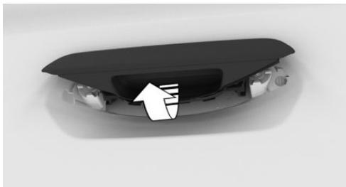
2. Türschloss mit dem integrierten Schlüssel gegen den Uhrzeigersinn entriegeln.
