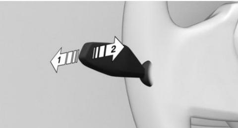
Den Blinkerhebel nach vorn drücken, Pfeil 1, oder bei eingeschaltetem Fernlicht den Blinkerhebel nach hinten ziehen, Pfeil 2.
