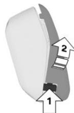
2. Batteriegehäuse zur Seite aus dem Fahrzeugschlüssel herausziehen.
