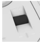
Rändelrad in der Mittelkonsole drücken. Das Control Display und die Instrumentenkombination leuchten auf.
