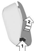
2. Integrierten Schlüssel an der offenen Seite des Fahrzeugschlüssels herausschieben.
