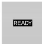
Die Anzeige READY zeigt an, dass das Fahrzeug fahrbereit ist.
