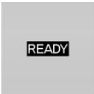
Die Anzeige READY zeigt an, dass das Fahrzeug fahrbereit ist.
