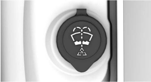
Der Behälter für die Waschflüssigkeit befindet sich unter der Frontklappe.
