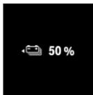
Bei eingeschalteter Betriebsbereitschaft und Fahrbereitschaft wird dauerhaft in der Instrumentenkombination der verfügbare Ladezustand der Hochvolt-Batterie in Prozent angezeigt.
