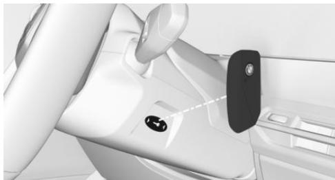
Wenn der Fahrzeugschlüssel nicht erkannt wird, kann die Fahrbereitschaft nicht eingeschaltet werden.
