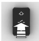
Schalter nach oben drücken und halten, bis die Initialisierung abgeschlossen ist:
