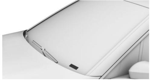
Die Fahrzeug-Identifizierungsnummer befindet sich zusätzlich hinter der Frontscheibe.
