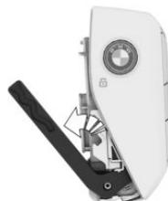
3. Integrierten Schlüssel aus dem Fahrzeugschlüssel entnehmen.
