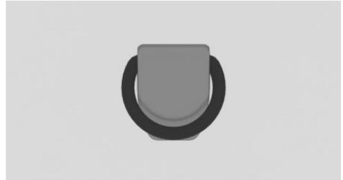
Die Verzurrösen befinden sich an den Seitenwänden im Gepäckraum.
