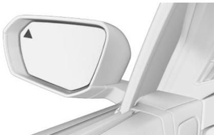
Die Leuchte im Außenspiegel blinkt, wenn von den hinteren Sensoren Fahrzeuge erkannt werden und sich das eigene Fahrzeug rückwärts bewegt.
