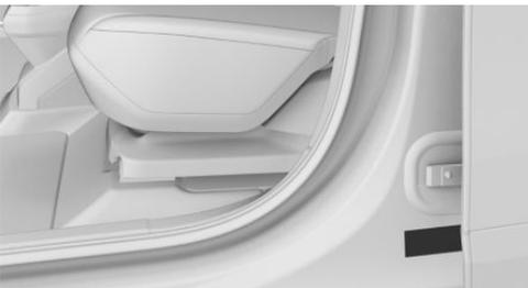
Die Fahrzeug-Identifizierungsnummer befindet sich auf dem Typenschild auf der linken Fahrzeugseite.
