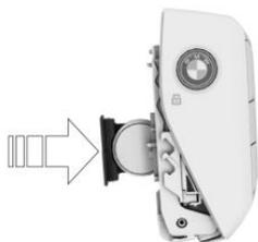
6. Abdeckung in den Fahrzeugschlüssel einsetzen.
