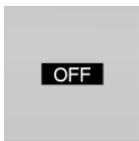
Der Schriftzug OFF in der Instrumentenkombination zeigt an, dass die Fahrbereitschaft ausgeschaltet und die Betriebsbereitschaft eingeschaltet ist.
