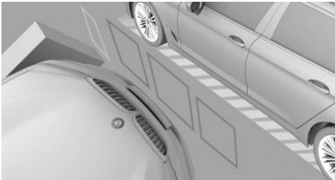
Zum Schutz der Fahrzeugflanken werden Hindernismarkierungen seitlich am Fahrzeug dargestellt.
