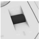
Rändelrad in der Mittelkonsole gedrückt halten, bis die Anzeige OFF in der Instrumentenkombination erlischt.
