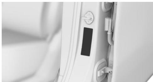
Die Reifenfülldruckangaben befinden sich auf dem Reifenfülldruckschild an der Türsäule der Fahrertür.
