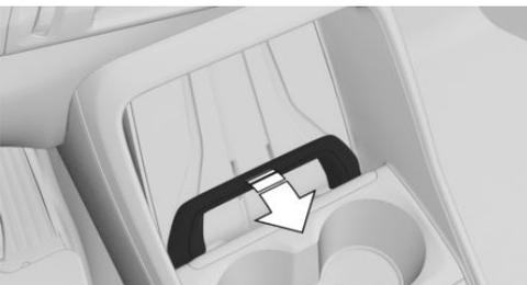
Um das Einsetzen und das Entnehmen eines Mobiltelefons zu erleichtern, kann die Haltespange geöffnet werden.
