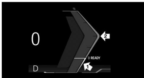
Zeiger im Bereich Pfeil 1: Anzeige für Energierückgewinnung durch Ausrollen oder beim Verzögern.
