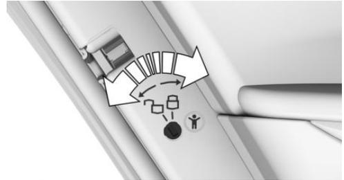
Sicherungsschalter an den Fondtüren mit dem integrierten Schlüssel entriegeln oder verriegeln.
