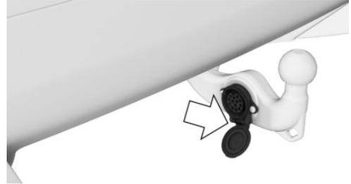
Die Anhängersteckdose befindet sich an der Anhängerkupplung.
