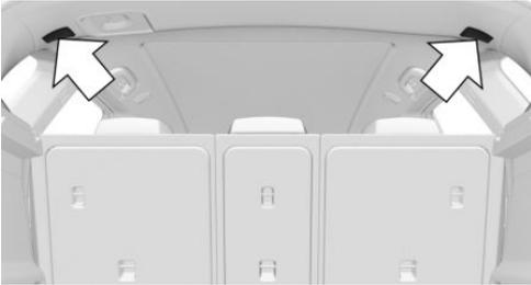
3. Die beiden oberen Befestigungsstifte des Gepäckraumtrennnetzes jeweils bis zum Anschlag in die Aufnahmen stecken, Pfeile 1, und nach vorn schieben.
