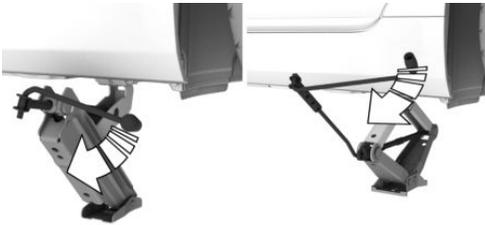
4. Die Hand vom Wagenheber nehmen, sobald der Wagenheber unter Last steht und die Wagenheberkurbel oder den Hebel mit einer Hand weiter drehen.
