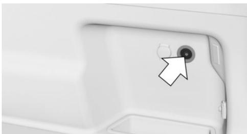
Die Taste zum Aus- und Einschwenken des Kugelkopfs befindet sich im Gepäckraum.
