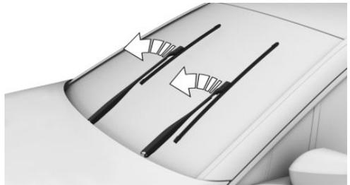
3. Taste drücken, Pfeil 1, Wischerblatt ein wenig im Uhrzeigersinn drehen und nach vorn herausziehen, Pfeil 2.
