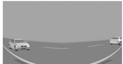
Gelbe Linien in der Bildschirmdarstellung kennzeichnen die Stoßfänger des eigenen Fahrzeugs.
