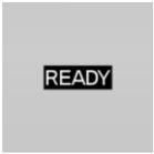
Bei eingeschalteter Fahrbereitschaft wird in der Instrumentenkombination READY angezeigt.
