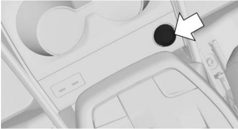
Eine Steckdose befindet sich in der Mittelkonsole. Die Abdeckung abziehen.
