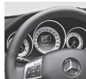
Display mit TFT-Technologie im Kombiinstrument (ELEGANCE)
