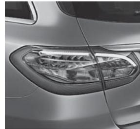
zweiteilige Heckleuchten inklusive Schluss-, Brems- sowie Nebelabschlusslicht in LED-Technik
