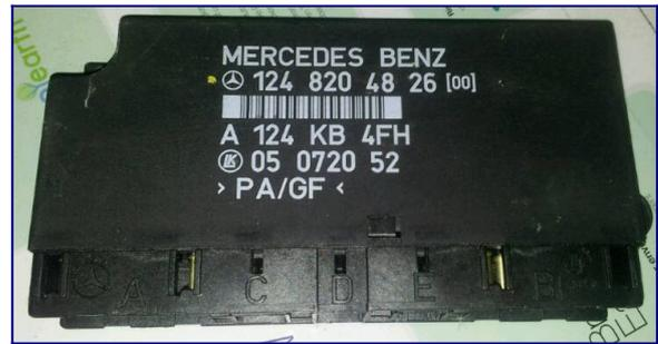
Einbauort unter der Rückbank Fahrerseite. Für die Komfortschließung gibt es ggf. einen extra ZV-Kabelbaum, der die Schlossendschalter (nicht bei Code 885 „IR-FB“) zu Port D führt.
