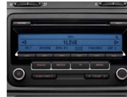
Das **Radio „RCD 310“** hat ein CD-Laufwerk, acht Lautsprecher und die Multimediale Buchse AUX-IN, spielt Dateien im MP3- oder WMA-Format ab und besitzt eine Ausgangsleistung von 4 x 20 Watt.
