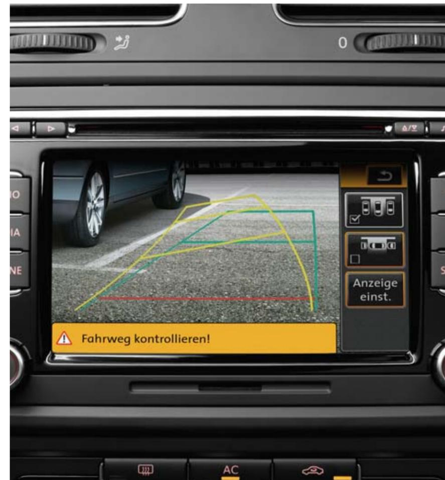
Auf dem Radio- bzw. Navigationsdisplay wird die elektronisch entzerrte Real-Live-Darstellung der **Rückfahrkamera** in der Heckklappe wiedergegeben. Durch freie Sicht hinter das Fahrzeug wird das Einparken so verbessert und vereinfacht.
