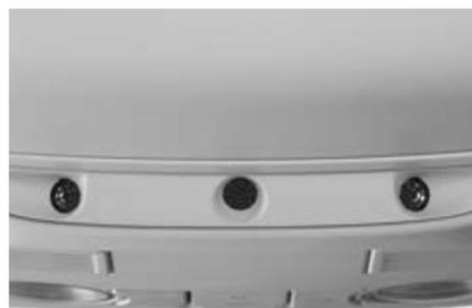
Die **Diebstahlwarnanlage „Plus“** verfügt im Innenleuchtenmodul des Dachhimmels über eine Innenraumüberwachung. Inklusiv elektronischer Wegfahrsperrung und Abschleppschutz.
