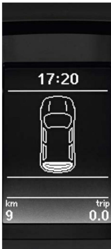
Die **Multifunktionsanzeige „Plus“** zeigt z. B. Durchschnittsgeschwindigkeit und -verbrauch, Fahrtzeit und Standheizungseinstellung an. Des Weiteren können Sie sehen, ob die Türen offen oder geschlossen sind, sowie Sprache und Maximalgeschwindigkeit der Reifen festlegen.
