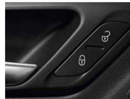
Die **Zentralverriegelung mit Innenschließfunktion** ist mit einem einfachen Knopfdruck aktivierbar.
