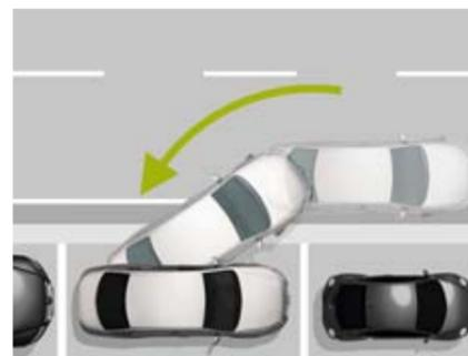
Der **Parklenkassistent „Park Assist“** scannt mit Ultraschallsensoren die Umgebung auf Fahrer- bzw. Beifahrerseite und unterstützt Sie beim Einparken.
