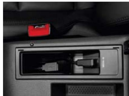
Die **Multimedienbuchse MEDIA-IN** mit USB-Schnittstelle ermöglicht den Anschluss externer Audioquellen und deren Bedienung über das jeweilige Radio oder Radio-Navigationssystem.
