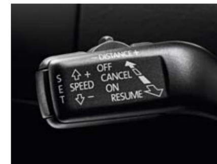
Ab 30 km/h hält die **Geschwindigkeitsregelanlage** Ihr gewähltes Tempo konstant und trägt auf diese Weise vor allem auf längeren Strecken zum entspannten Fahren bei.
