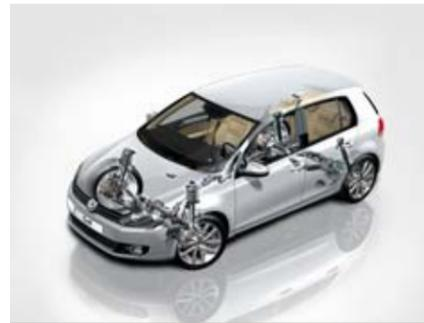
Die adaptive Fahrwerksregelung **DCC** stellt innerhalb von Millisekunden jeden Dämpfer individuell auf die Fahrbahn und die Fahrsituation ein. Per Knopfdruck entscheiden Sie, wie straff oder komfortabel das Fahrwerk eingestellt sein soll. Dabei können Sie zwischen den drei Stufen **SPORT**, **NORMAL** und **COMFORT** wählen. In der Einstellung **SPORT** wird zusätzlich die Lenkungscharakteristik an eine sportliche Fahrweise angepasst.
