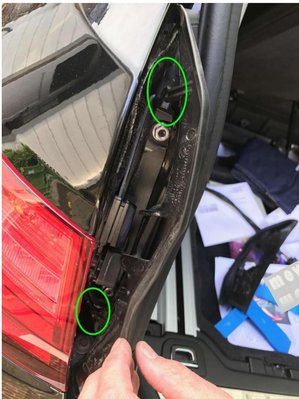
Seitlich unterschieben und nach links außen und zum Körper hin aushebeln...nicht durchgängig...dann weiter nächstes Bild
