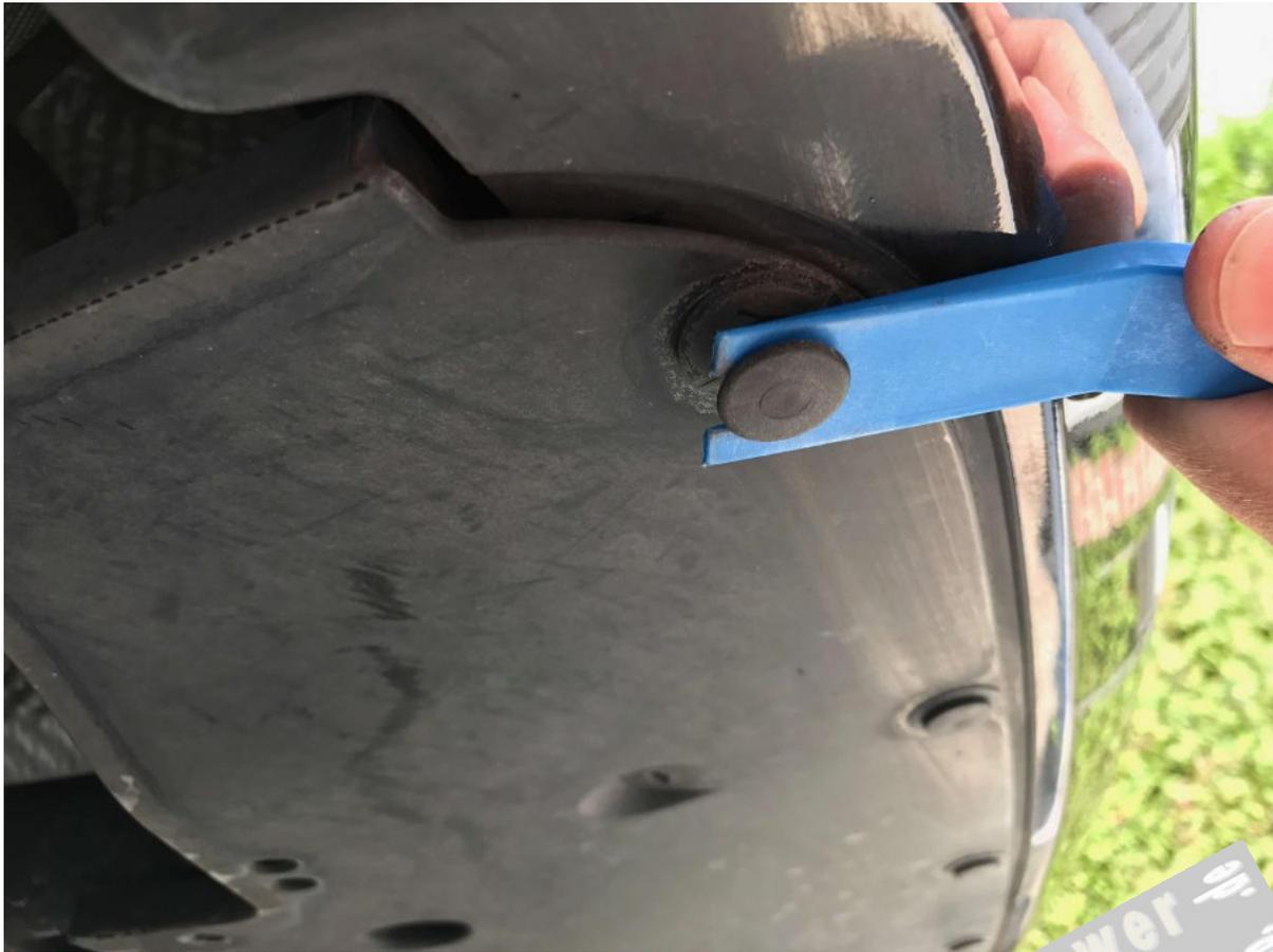
8er Schrauben lösen und entnehmen
