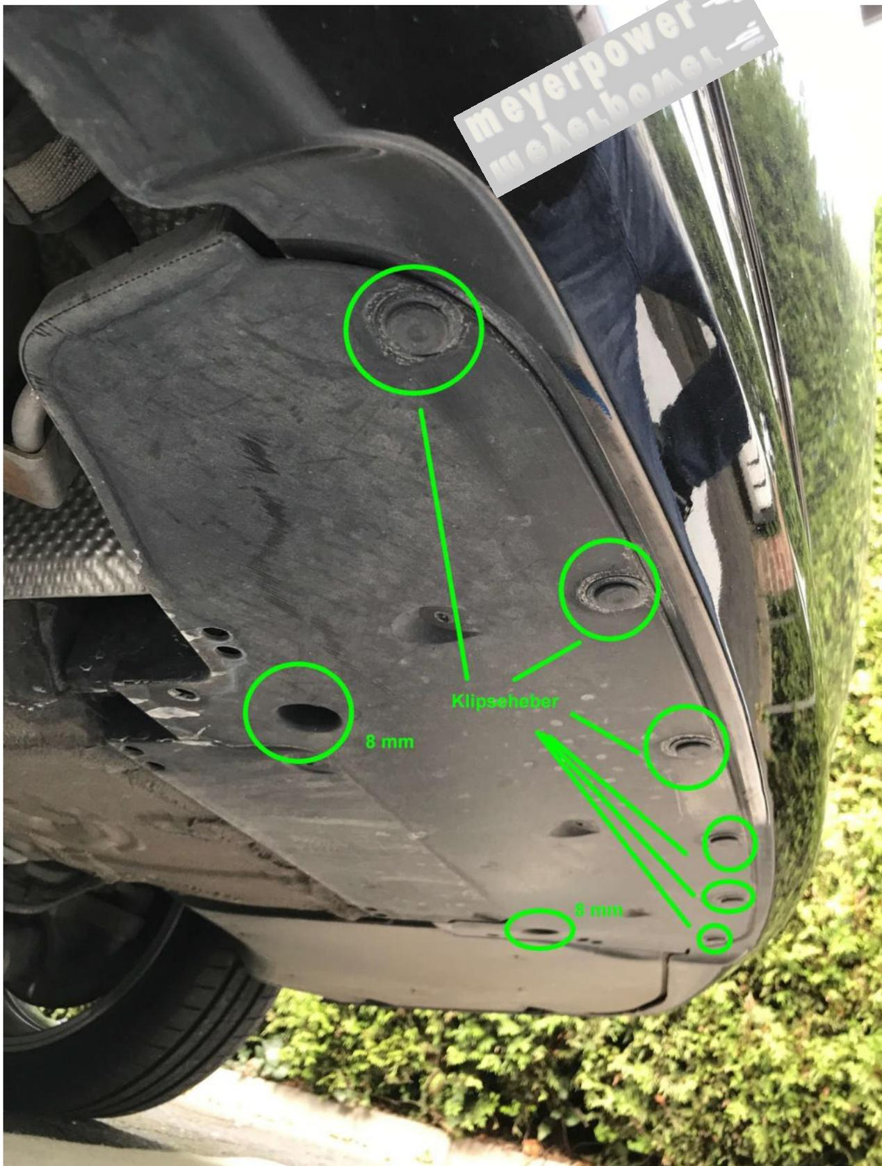
Mit dem passenden Werkzeug die Spreiznieten lösen und dann herausziehen – Diese können später wieder verwendet werden.
