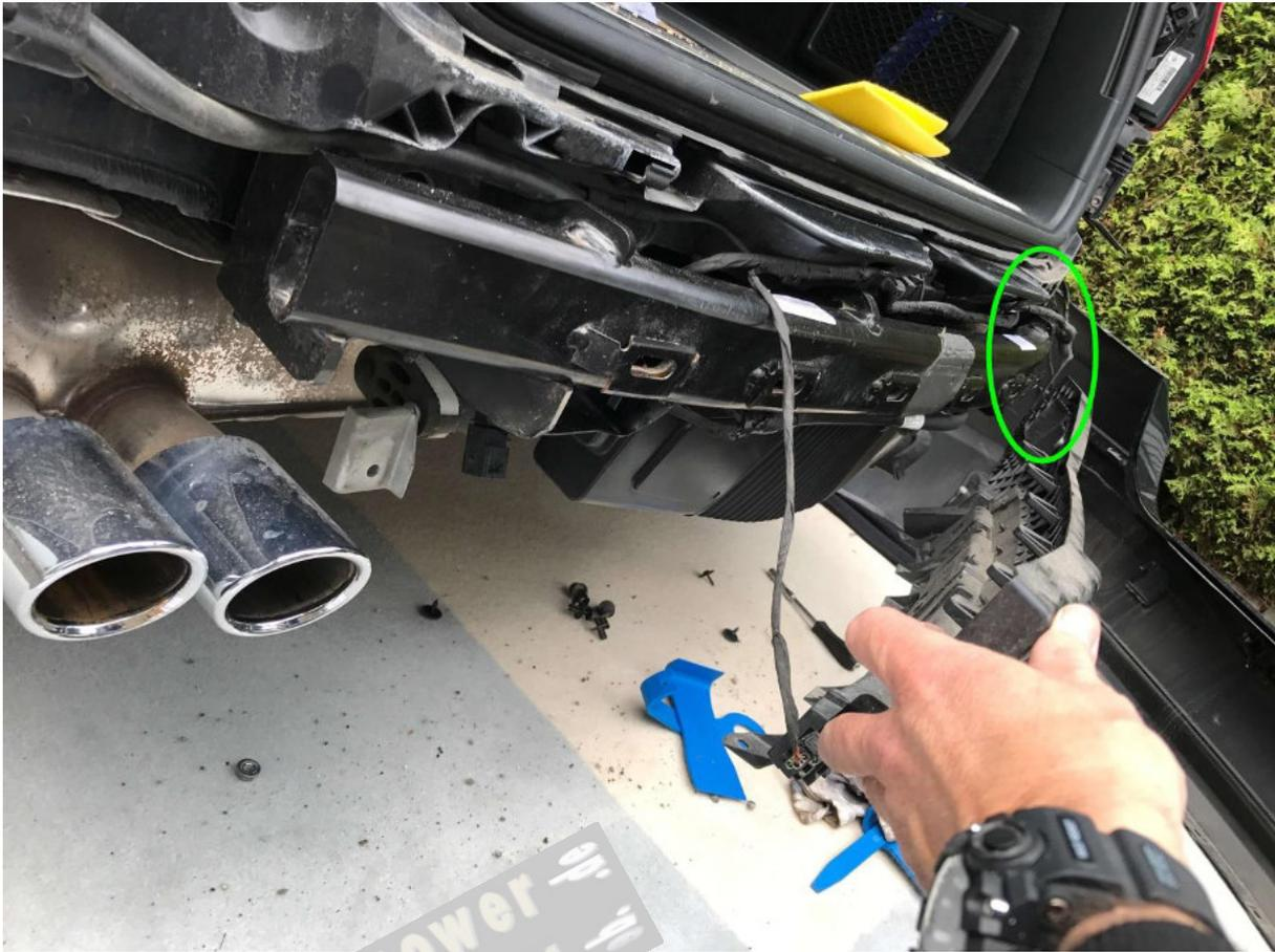
Nun kann der alte Stahlträger der Stoßstange entfernt werden...hierzu mit einer Knarre und entsprechender Nuss alle erforderlichen Schrauben lösen:
