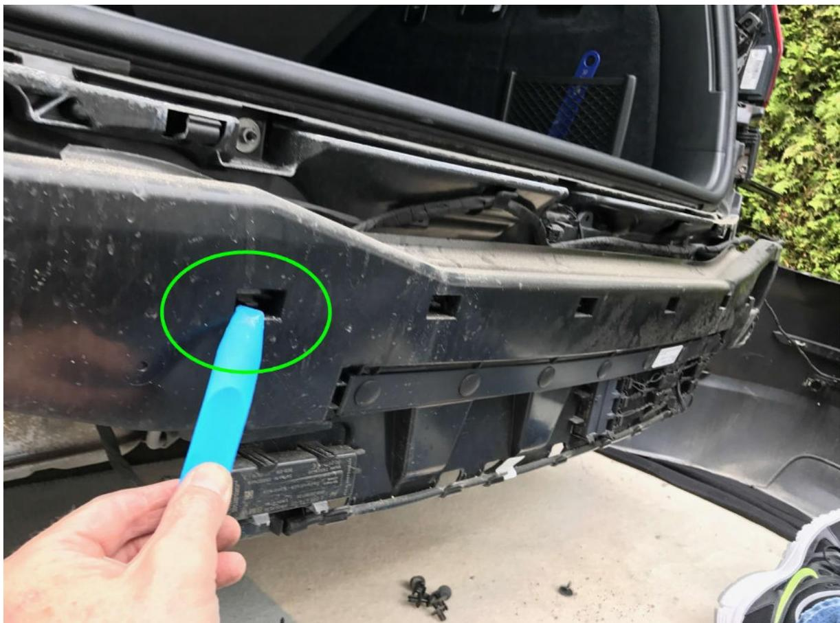
Sind alle Klipse geöffnet, ist Halter abnehmbar und kann im Kofferraum abgelegt werden – Achtung bzgl. eventueller Verkabelungen und Kabelbefestigungen!
