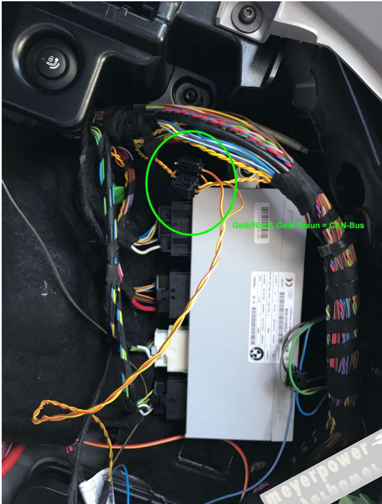
Der Stromverteiler im hinteren Seitenfach muss nun gelöst werden – Genaue Bezeichnung laut original EBA Stromverteile HR (Z2). Drei 8mm Schrauben sind zu lösen.
