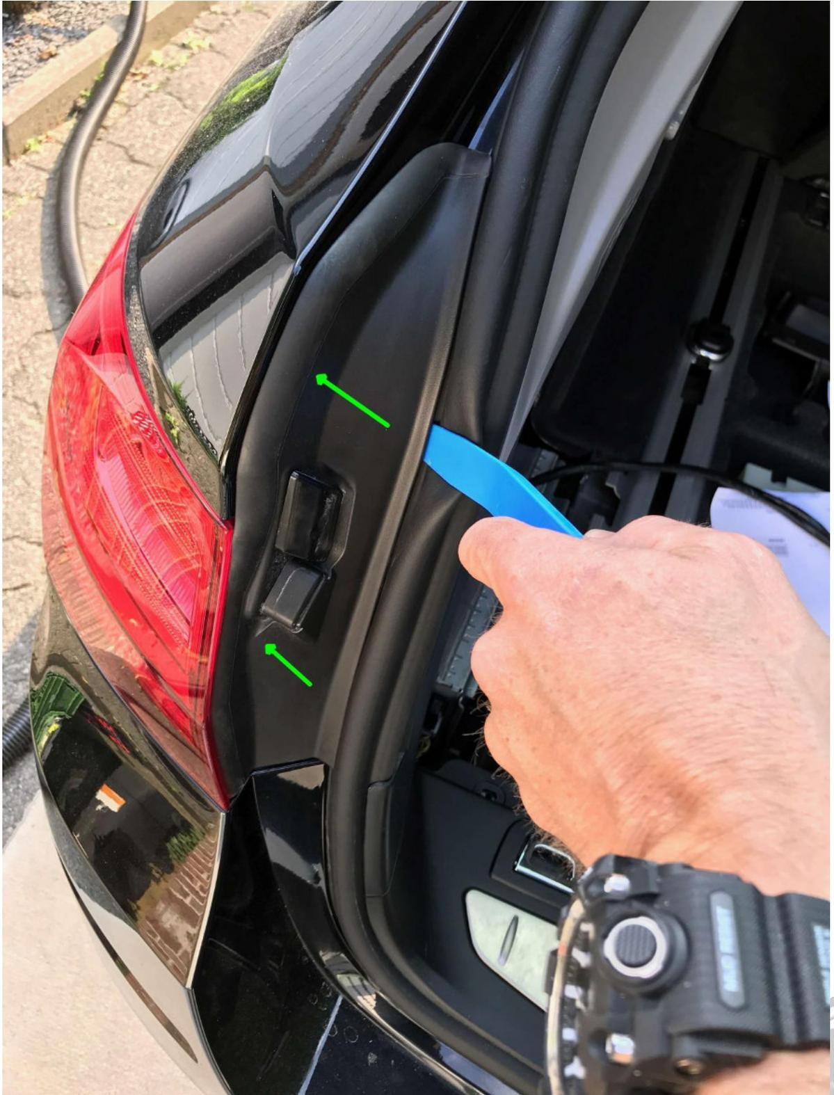
...nun unten ansetzen und leicht nach vorne und schräg oben ziehen....ggfls. den Schritt vorher wiederholen, bis sich die Abdeckung aus den Verankerungen löst.
