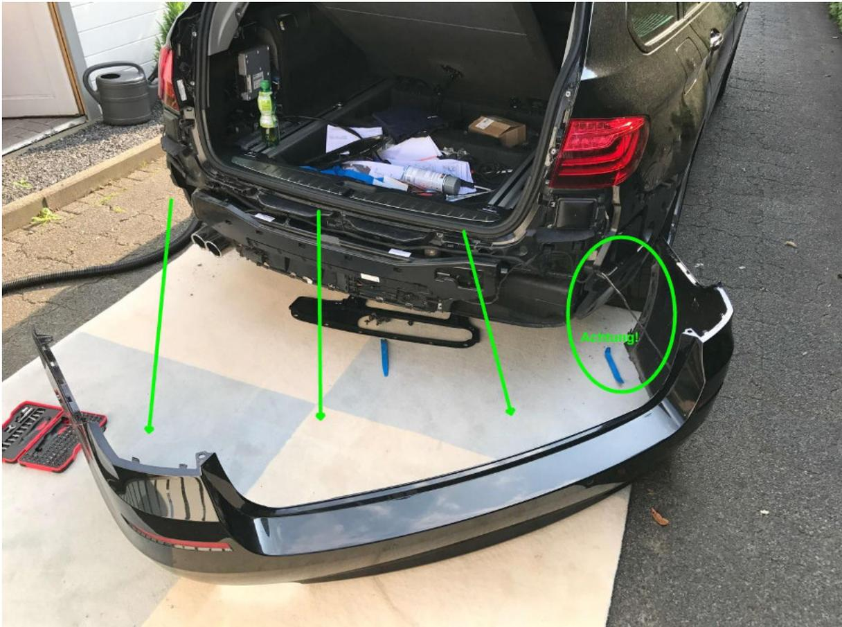
Ist die Stoßstange entnommen, muss der hintere Kunststoffhalter, der u.a. auch die Aufnahme für die Antenne der Komfortöffnung der Heckklappe bildet, entnommen werden. Dazu die eingekreisten Klipse nach unten drücken und gleichzeitig die Abdeckung nach vorne ziehen
