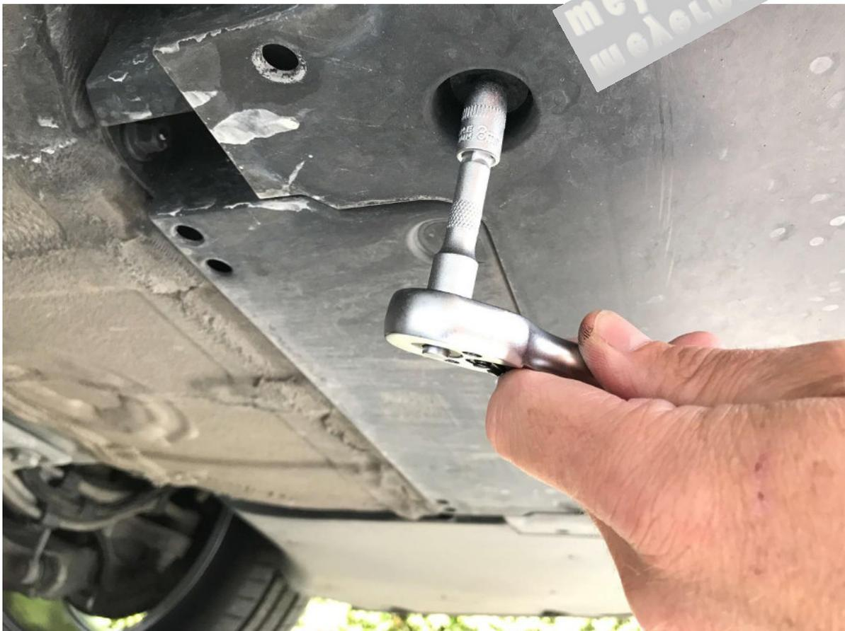
Vom Radlauf weg in Richtung Heck ist die Stoßstange zusätzlich mit dem Unterbodenschutz verbunden; diesen am besten vorsichtig aushebeln (auf beiden Seiten!)
