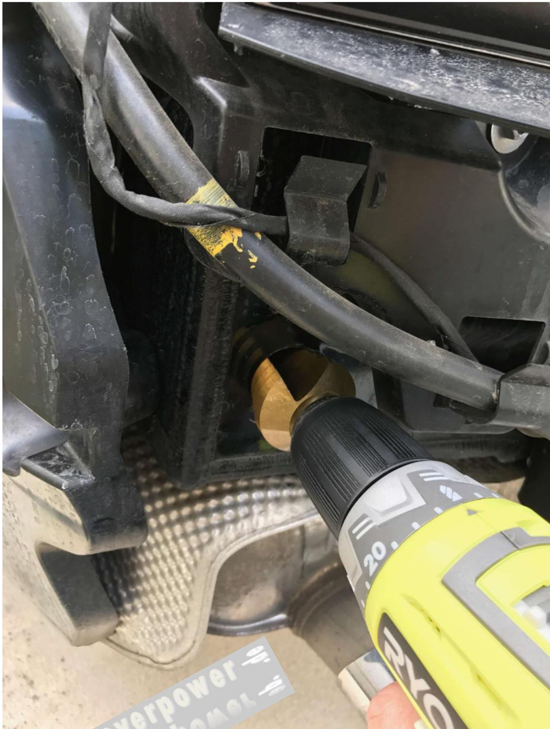
Anschließend entgraten, alle Späne mit einem Sauger entfernen, vor allem im inneren Bereich.
