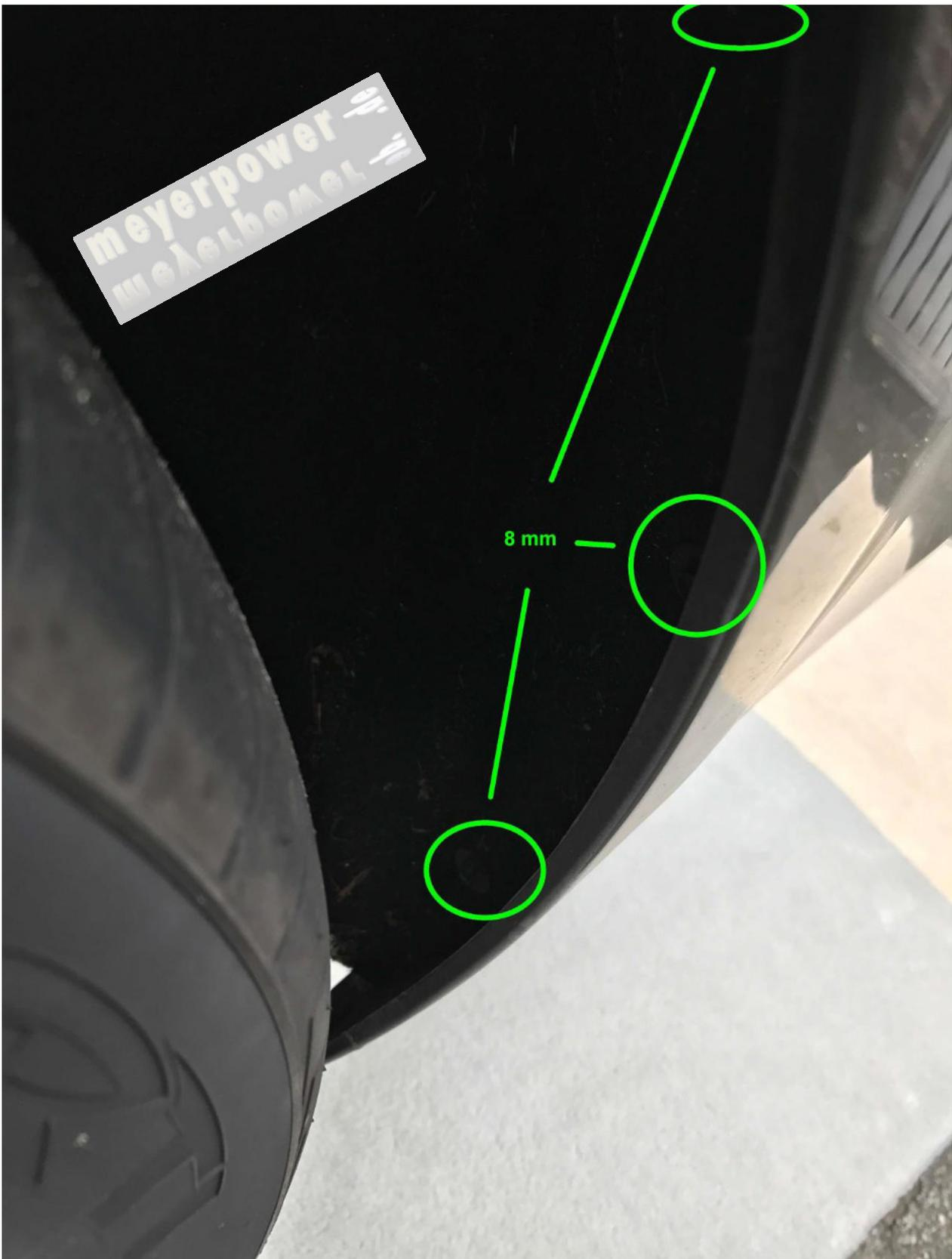
Schrauben in beiden Radläufen lösen und entnehmen.
