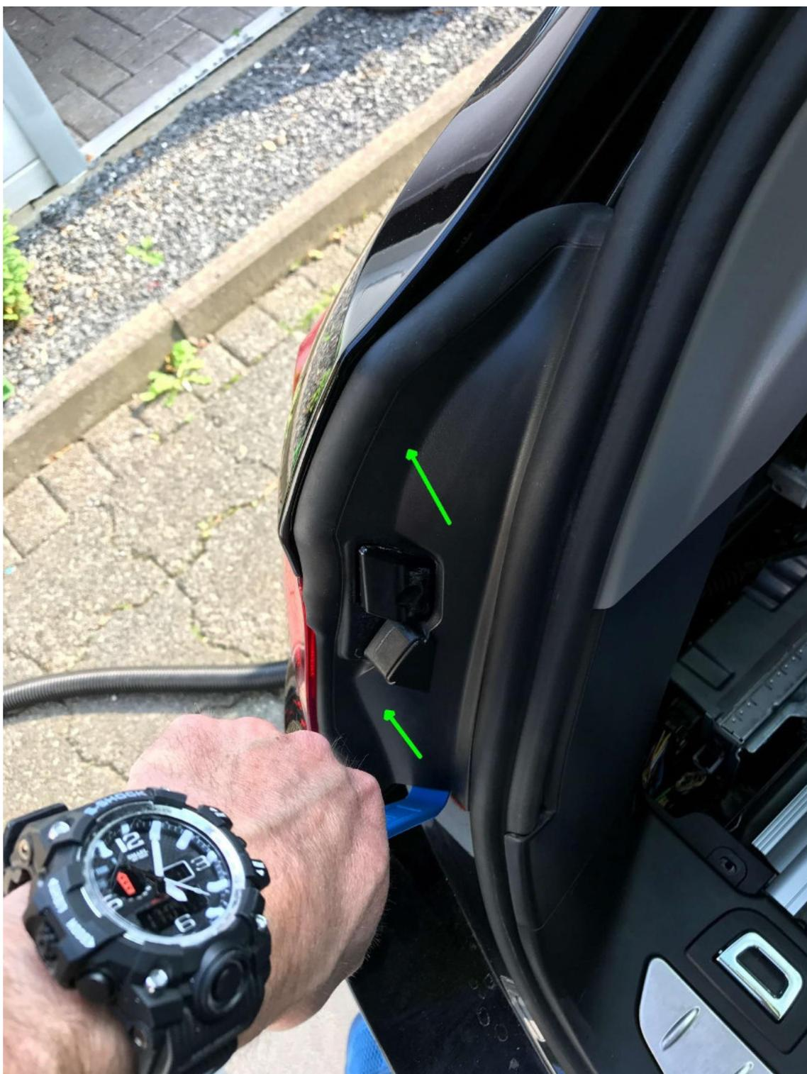
Nun die Schraube mit einer 8er Nuss lösen....den gleichen Vorgang auf der rechten Seite wiederholen!
