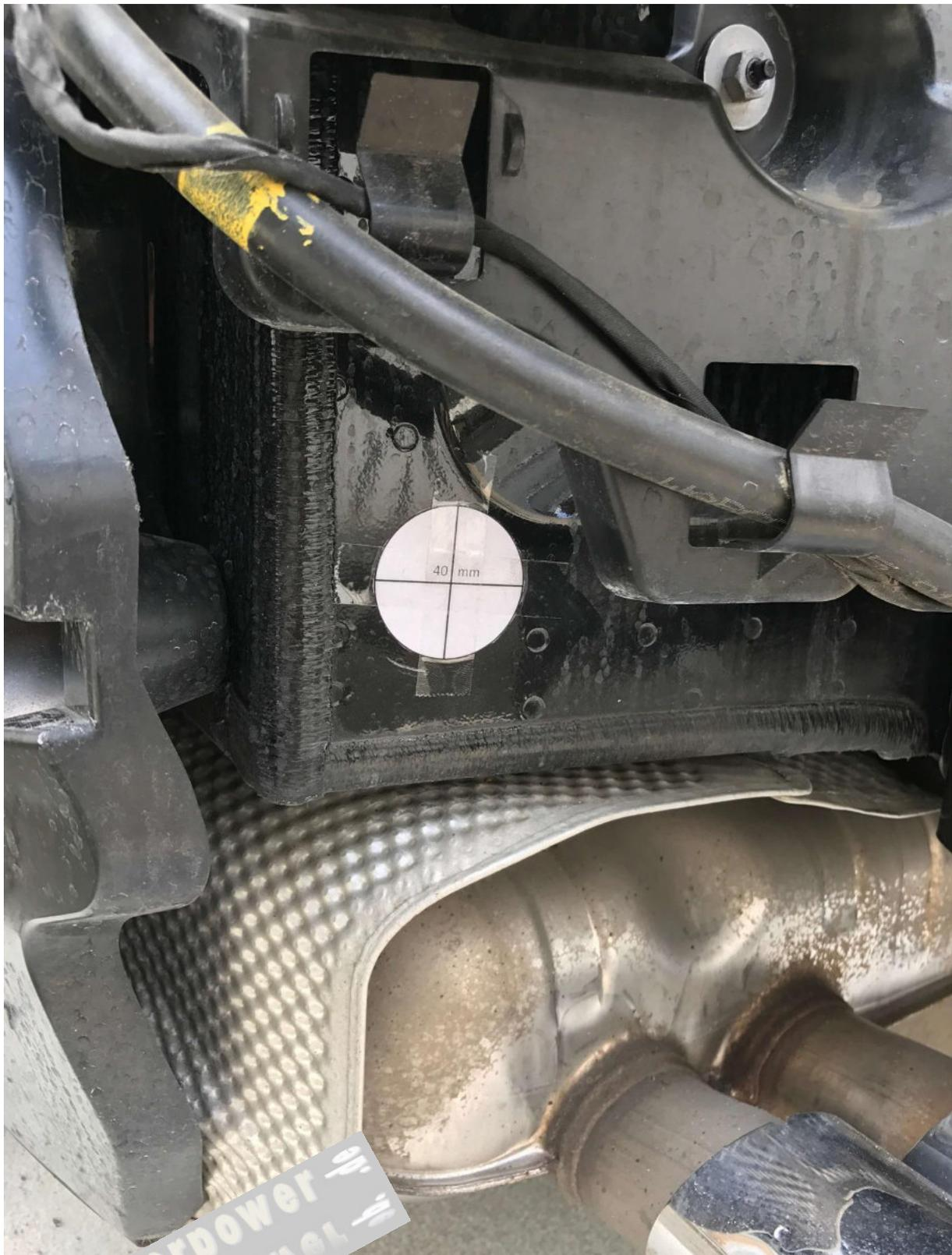
Die Bohrung setzt man idealer Weise mit einem Stufenbohrer....in meinem Fall ein 45mm Bohrer.
