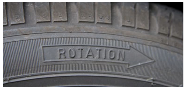
Beispiel einer Kennzeichnung der Laufrichtung
