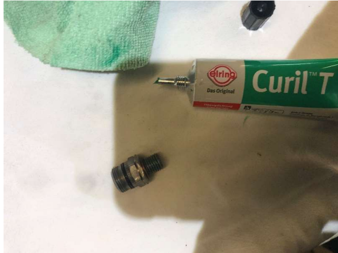
Abb. 80: Curil T zum abdichten der Schrauben
