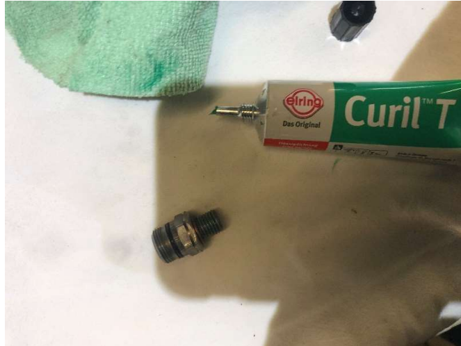
Abb. 77: Curil T zum abdichten des Stahlbusventils mit Stahlbusventil
