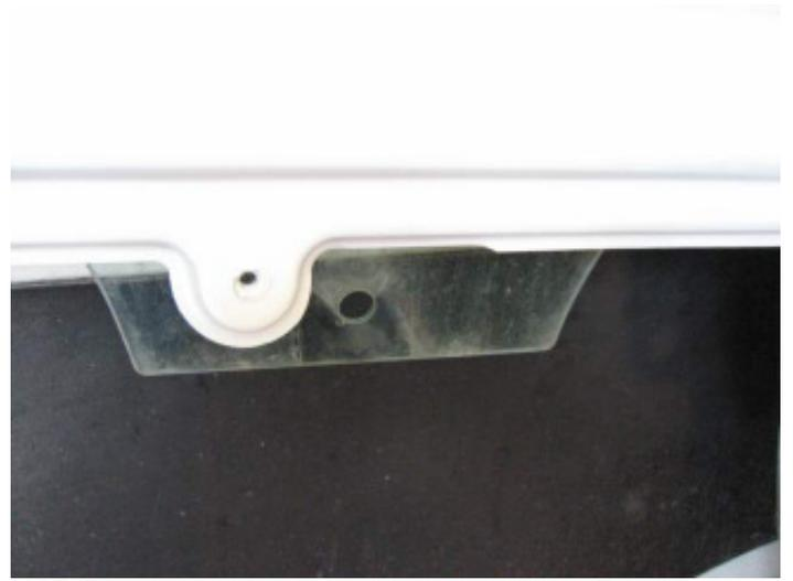
VOR Einbau des Aggregatträgers muss das Fensterglas vorbereitet werden
