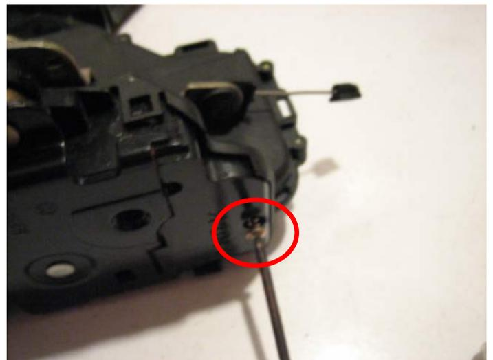
Verriegelungseinheit mit Elektrikeinheit verschrauben
