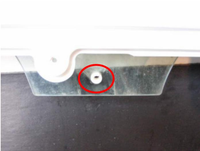
äußeren Kunststoffspannstift so tief einsetzen, dass das Fensterglas mittig auf dem Spannstift sitzt
