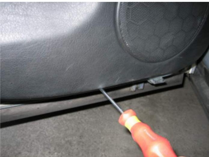
Schraube lösen (Torx 20)
