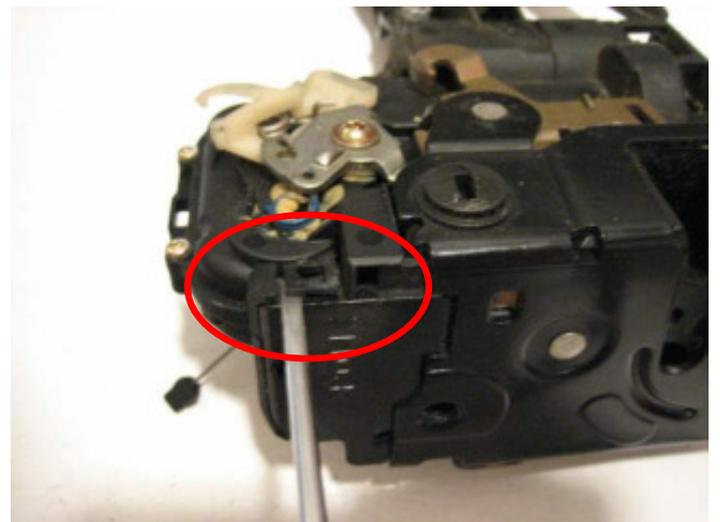
Durch Anheben der Kunststoffnase Verbindung lösen
