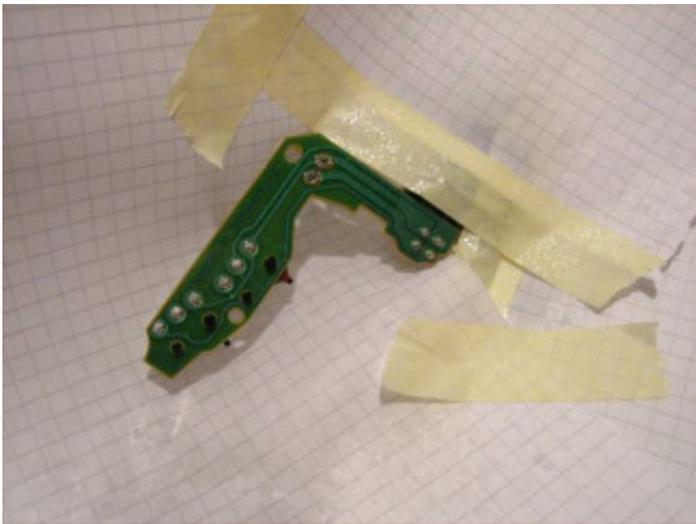
Mechanik abkleben und Platine mit Schutzlack versehen, um Oxidation zu vermeiden
