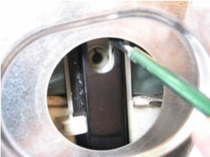
Äußeren Kunststoffspannstift mit Flachzange herausziehen bzw. -drehen. Alternativ kann dieser auch ins Türinnere gedrückt werden und später aus dem Türboden entnommen werden.
