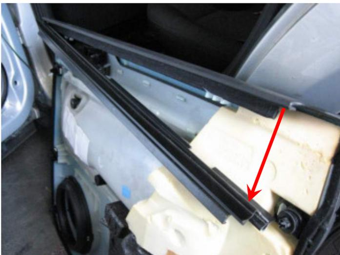
Führungsleiste von Türinnenverkleidung lösen
