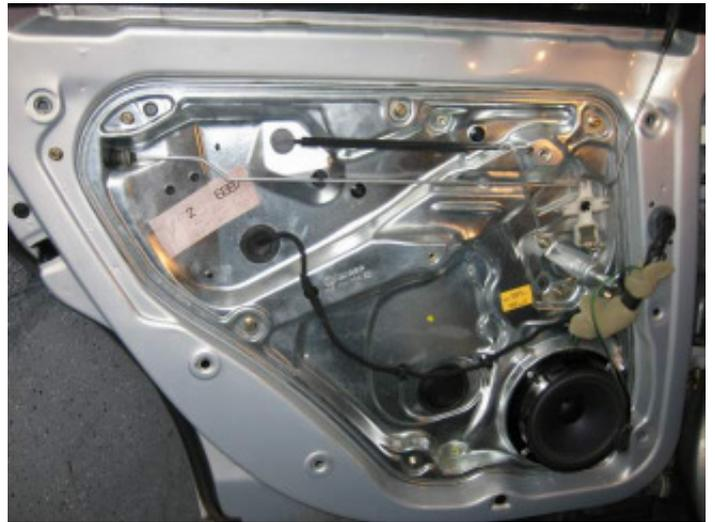
Schritt für Schritt wird nun der Aggregatträger (verzinktes Blech) demontiert.
