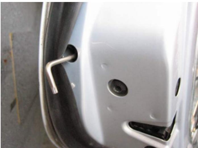
Schraube etliche Umdrehungen herausdrehen, bis sich auf Türaußenseite Metallteil herausziehen lässt (siehe folgendes Bild). Dazu Vielzahnschlüssel "M4" verwenden.
