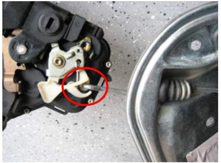
Schubstange in Türschlossmechanik einsetzen
