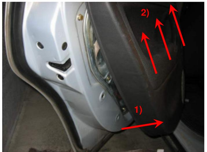
Türinnenverkleidung (Snap-in-Verbindung) von unten her wegklappen, anschließend nach oben heben.
