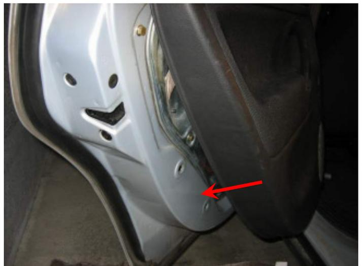
anschließend Türverkleidung an die Tür drücken und ringsum einrasten
