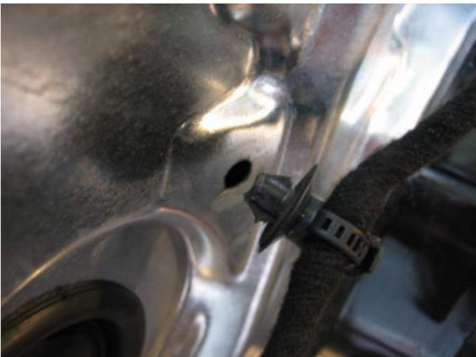
Alle Kabelhalterungen vom Aggregatträger demontieren
