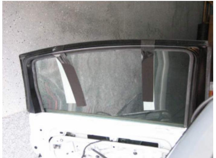
Fensterglas per Hand nach oben ziehen und gegen Heruntergleiten sichern.
