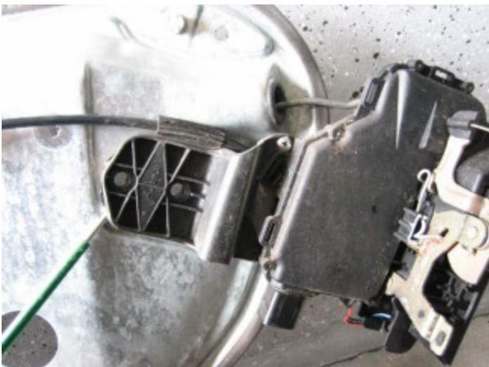
Angeklebte Türschlosshalterung abhebeln, dabei Schloss festhalten, da es anschließend noch immer mit dem Aggregatträger verbunden ist
