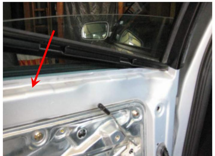
Führungsleiste an Tür montieren
