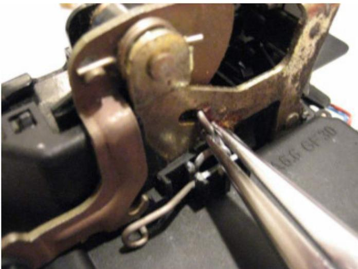
Feder einsetzen (wie schon oben erwähnt hat diese nur Befestigungsfunktion)
