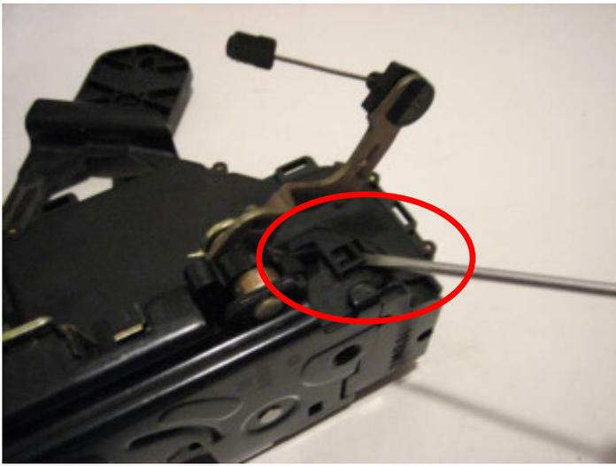
Durch Anheben der Kunststoffnase Verbindung lösen und vorsichtig Verriegelungseinheit von Elektronik trennen
