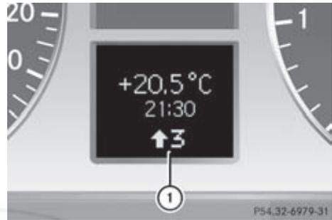
▶ In den empfohlenen Gang schalten, wenn im Multifunktionsdisplay des Kombiinstrumentes die entsprechende Schaltempfehlung **1** erscheint.
