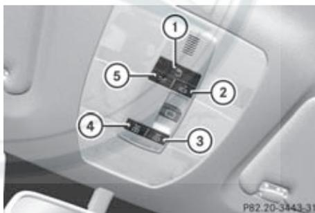
Vordere Dachbedieneinheit (Fahrzeuge mit Tasten)
