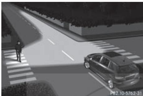
Das Abbiegelicht verbessert die Ausleuchtung der Fahrbahn in Abbiegerichtung weitwinklig, sodass z. B. enge Kurven besser einsehbar werden. Es kann nur aktiviert werden, wenn das Abblendlicht eingeschaltet ist.
