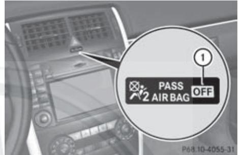
Das Sensorsystem der automatischen Kindersitzerkennung im Beifahrersitz erkennt, ob ein spezieller Mercedes-Benz Kindersitz mit automatischer Kindersitzerkennung montiert ist. In diesem Fall leuchtet die Kontrollleuchte PASSENGER AIRBAG OFF
