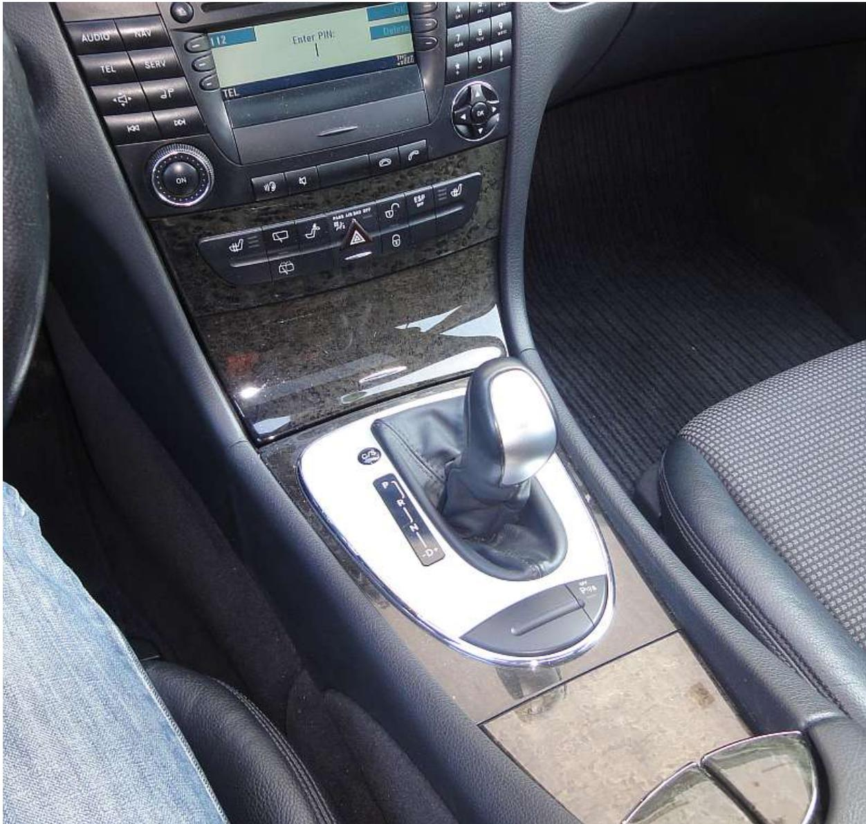
Raus nehmen der Abdeckung um den Knauf ist ganz einfach. Das hintere kleine Fach (Getränkehalter) öffnen. Den Aschenbecher vorne raus nehmen und das Fach offen lassen. Dann mit beiden Händen die Abdeckung vorne anfassen, leicht nach hinten ziehen und kräftig nach oben ausklinken.
