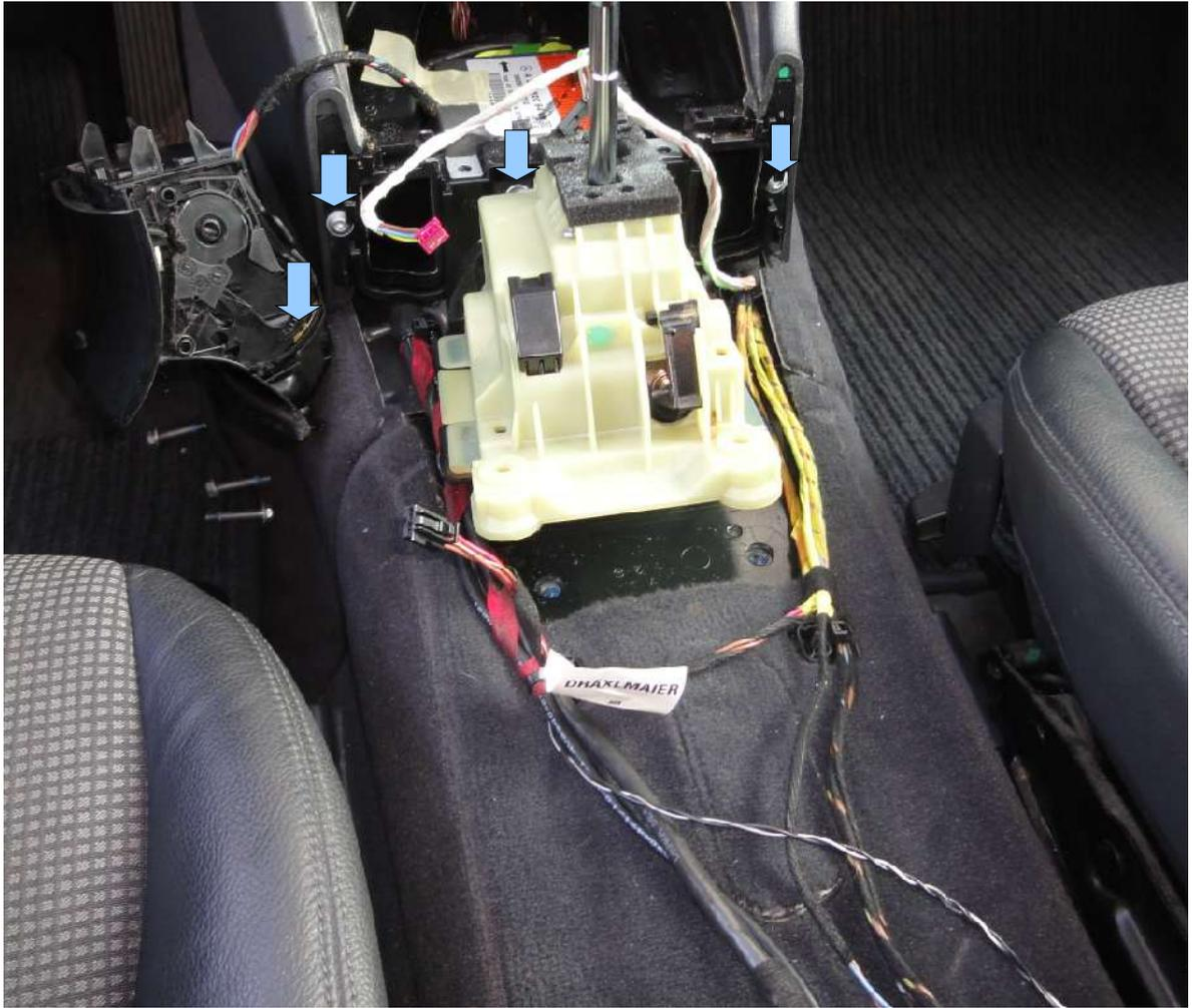
Die drei Schrauben lösen und den Stecker vom Aschenbecher abziehen (Achtung der Stecker geht um 90 Grad versetzt ab.) Dann kann man die Schwarze kleine Blende wegmachen. Das muss man nicht unbedingt, macht es aber leichter. Jetzt muss man vorne rechts am EMW nach den Bowdenzug abmachen. Dazu die kleine weiße Lasche mit Schraubendreher leicht anheben und das Aluteil 90 Grad drehen und rausziehen. Das ist ein Bajonettverschluss.
