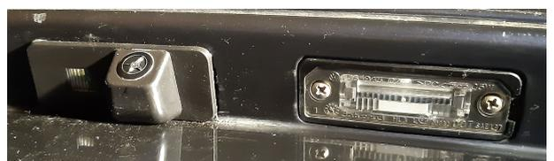
Die Verlegung in den Innenraum geht relativ problemlos an der vorhandenen Gummidurchführung. Da ist genügend Platz für ein weiteres Loch. Sicherheitshalber habe ich auf der Außenseite das Kabel mit etwas Silikon abgedichtet.
