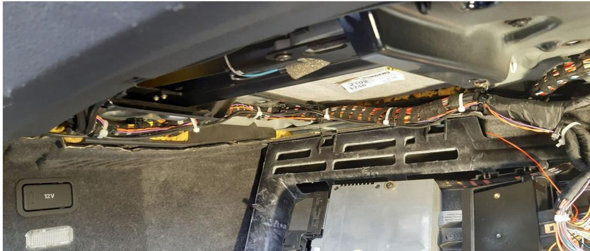
An der Seite oben links wird der Schaum durchstoßen wobei dann die Kabel unter der Hutablage auftauchen und am Kabelbaum bis nach unten geführt werden können.
