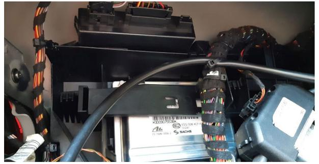
Die Abdeckung der Reserveradmulde hochheben dann ist man direkt an der Gummidurchführung. Schräg nach links geschoben kommt man hinter der Komfortbatterie in den Innenraum. Um mögliches Durchscheuern zu verhindern, hab ich über beide Kabel (Stromversorgung und Video) einen 40cm langen, 10mm Plastikschauch geschoben. Im oberen Bereich kann der Schlauch dann gut am vorhandenen Kabelbaum fixiert werden.
