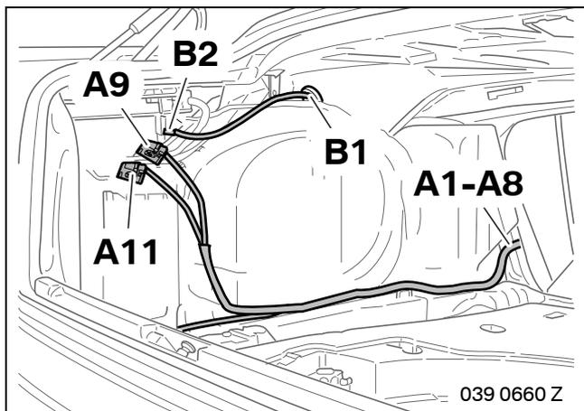
Nachrüstkabel Navigationssystem **A** und Antennenleitung GPS **B** entlang des Fahrzeugkabelbaums wie folgt verlegen:
