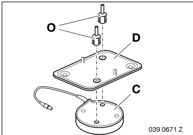
GPS-Antenne **C** mit Spreiznieten **O** am Halter GPS-Antenne **D** anschrauben.
