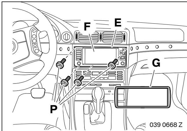
Bordmonitor **F** mit Linsenschrauben **P** am Funktionsträger Bordmonitor **E** anschrauben.
