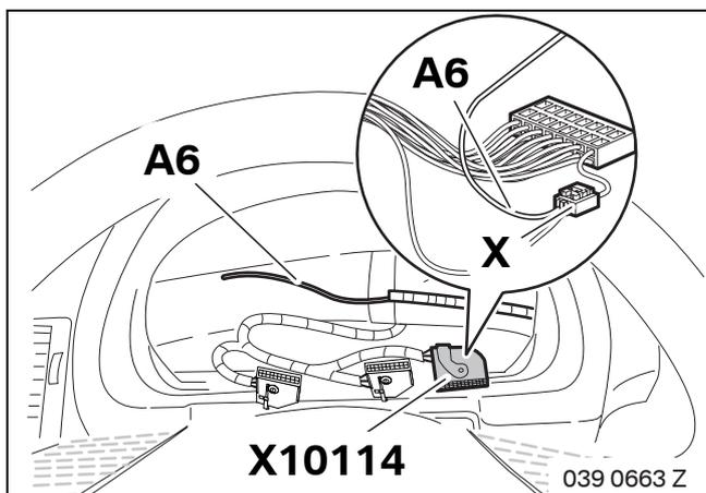
Abzweig **A6** mit Miniverbinder **X** an Leitung BR/RT vom 26-poligen Stecker BL **X10114** PIN 1 anschließen.
