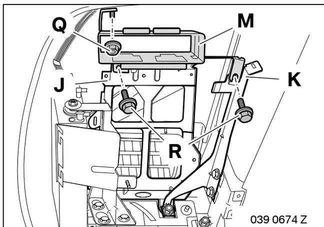
Halter Navigationsrechner **M** mit Sechskantmutter **Q** am Stehbolzen (1) anschrauben.
