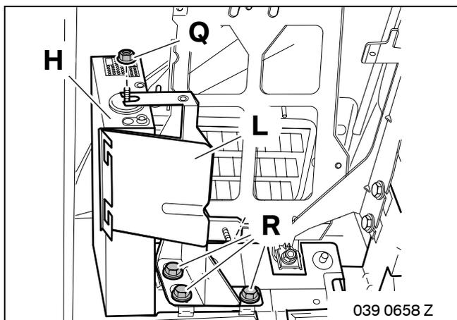
Halter Bordmonitorradio **L** mit Sechskantschrauben **R** am Grundträger **I** anschrauben.
