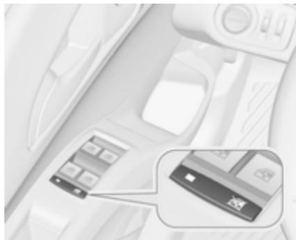
Zur Deaktivierung der elektrischen Fensterbetätigung der Hintertüren Schalter
