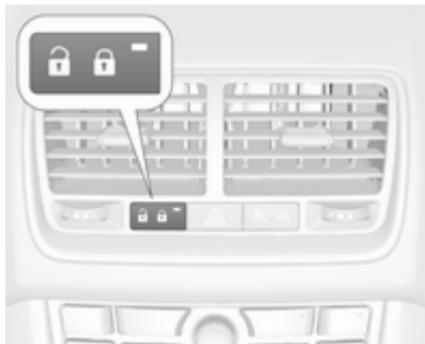
In der Zentralverriegelungstaste befindet sich eine Status-LED.
