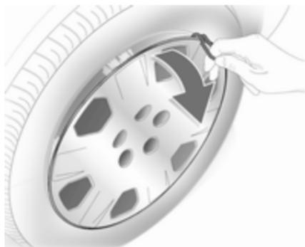
1. Radabdeckung mit dem Haken abziehen. Wagenwerkzeug
