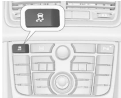
Für extremes Hochleistungsfahren kann ESC deaktiviert werden: Taste
