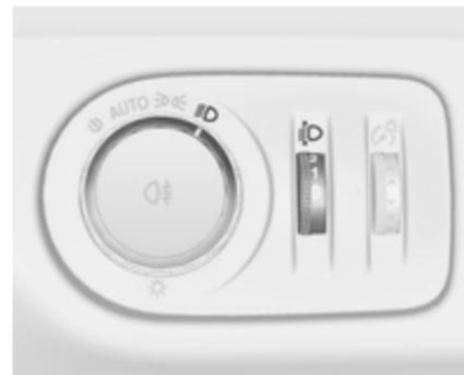
Zur Anpassung der Leuchtweite an die Fahrzeugbeladung, um Blendwirkung zu reduzieren: Daumenrad
