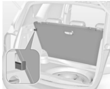
Die hintere Bodenabdeckung kann angehoben werden.
