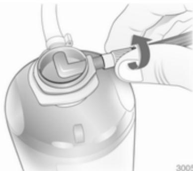
2. Den Luftschlauch von der Halterung lösen und auf den Anschluss der Dichtmittelflasche schrauben.
