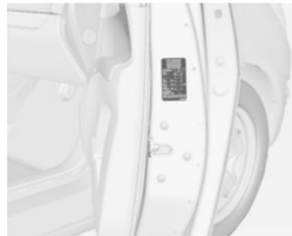
Reifendruck ⇨ 211 und auf dem Aufkleber an der Beifahrertür.
