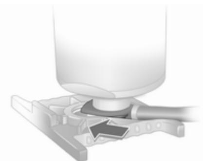
3. Die Dichtmittelflasche auf der Halterung platzieren. Sicherstellen, dass die Flasche nicht herunterfällt.
