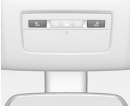
Wird mit den Tasten ☀️ und ☀️ der vorderen und hinteren Innenleuchte bedient.
