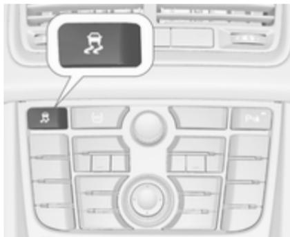
Die Traktionskontrolle kann ausgeschaltet werden, wenn ein Durchdrehen der Antriebsräder erwünscht ist: Taste
