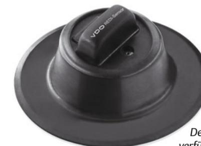
Der seit Sommer 2014 verfügbare neue Mehrmarkensensor VDO REDI deckt mit nur drei Varianten eine Vielzahl der mit direkten Reifendruckkontrollsystemen ausgestatteten Fahrzeuge ab. Die Sensoren präsentieren sich dabei in völlig neuer Form. Lediglich so groß wie eine 50-Cent-Münze, befinden sie sich in einem Gummi-Container, der auf den Innerliner (Innenseite des Reifens) geklebt wird.
