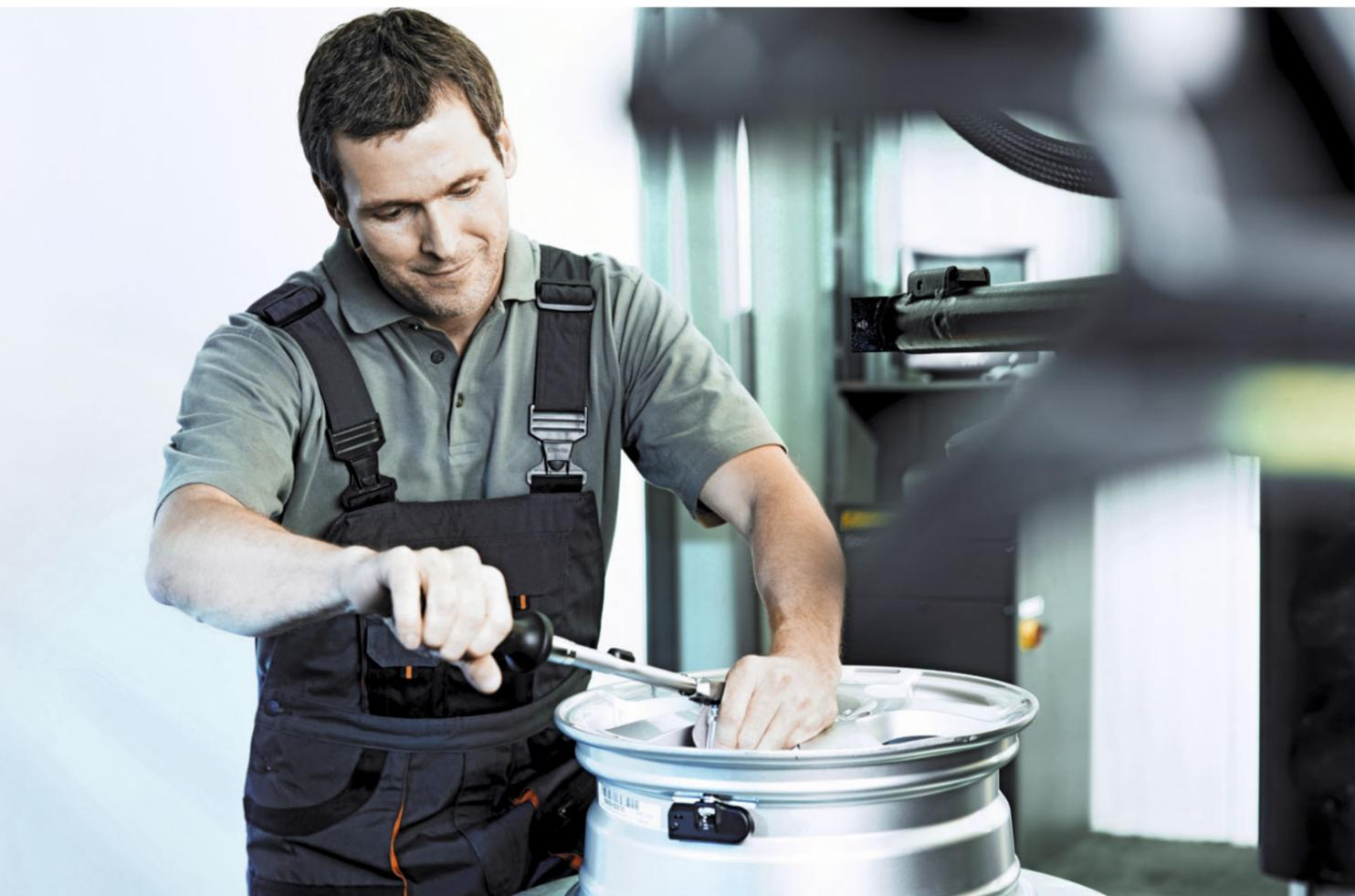
Montage eines RDK-Sensors
