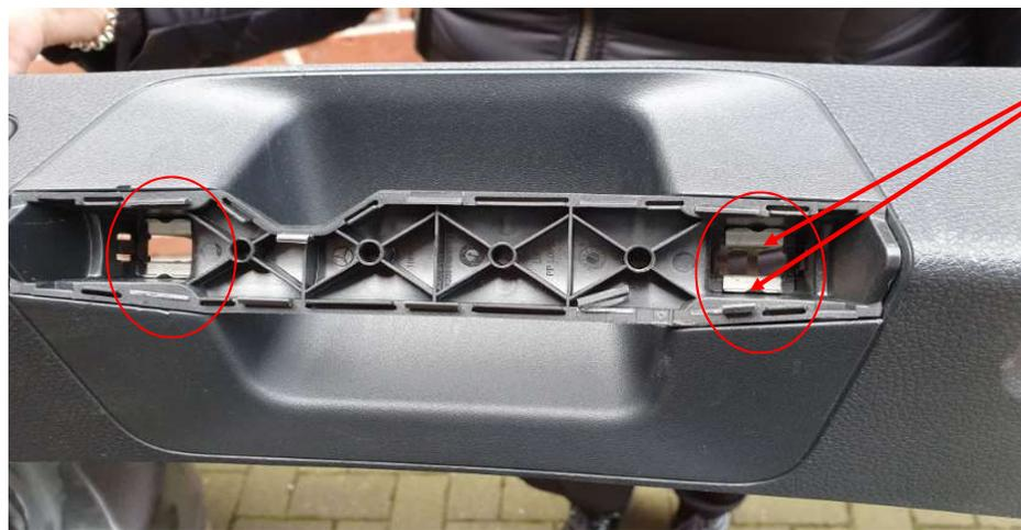
Halbschalen Griffe mit Hebel ausklipsen
