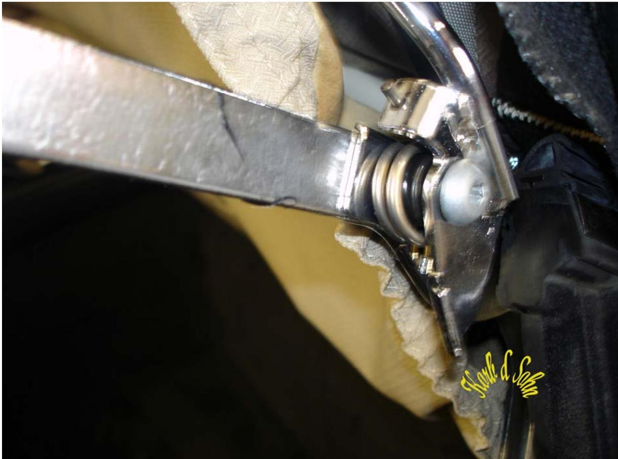
Die vorderen seitlichen Dichtungen sind durch verschiebbare Mutternschächte variabel. Je tiefer diese montiert werden umso höher ist der Anpressdruck an die Seitenscheiben.
