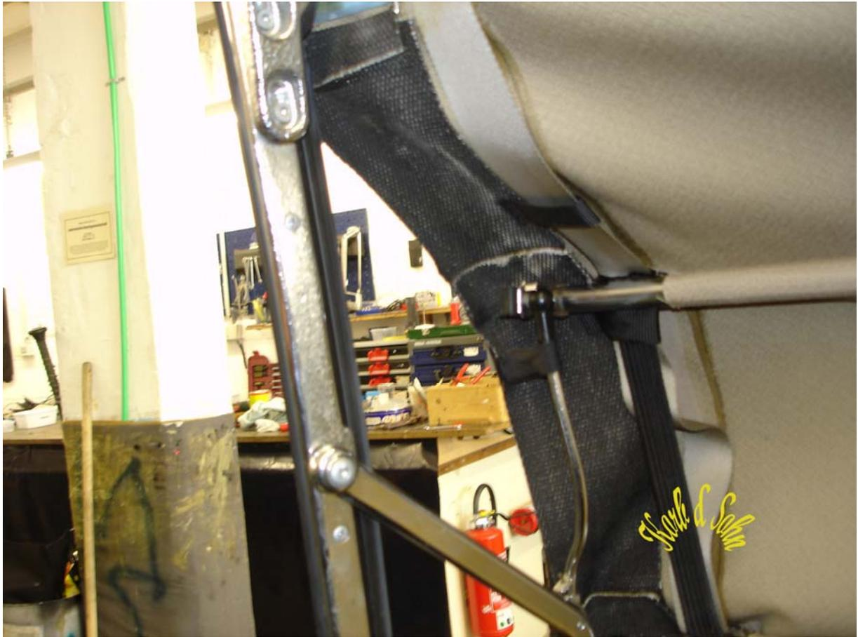
Feder zur Vorspannung der Himmelfaltmechanik.
