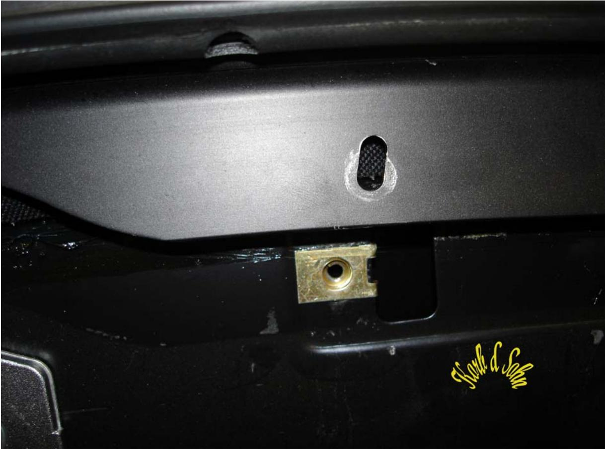
Seitlicher Auflagegummi. Wenn dieser fehlt oder defekt ist, hat man bei geöffnetem Verdeck ein tiefes Klappergeräusch !!
