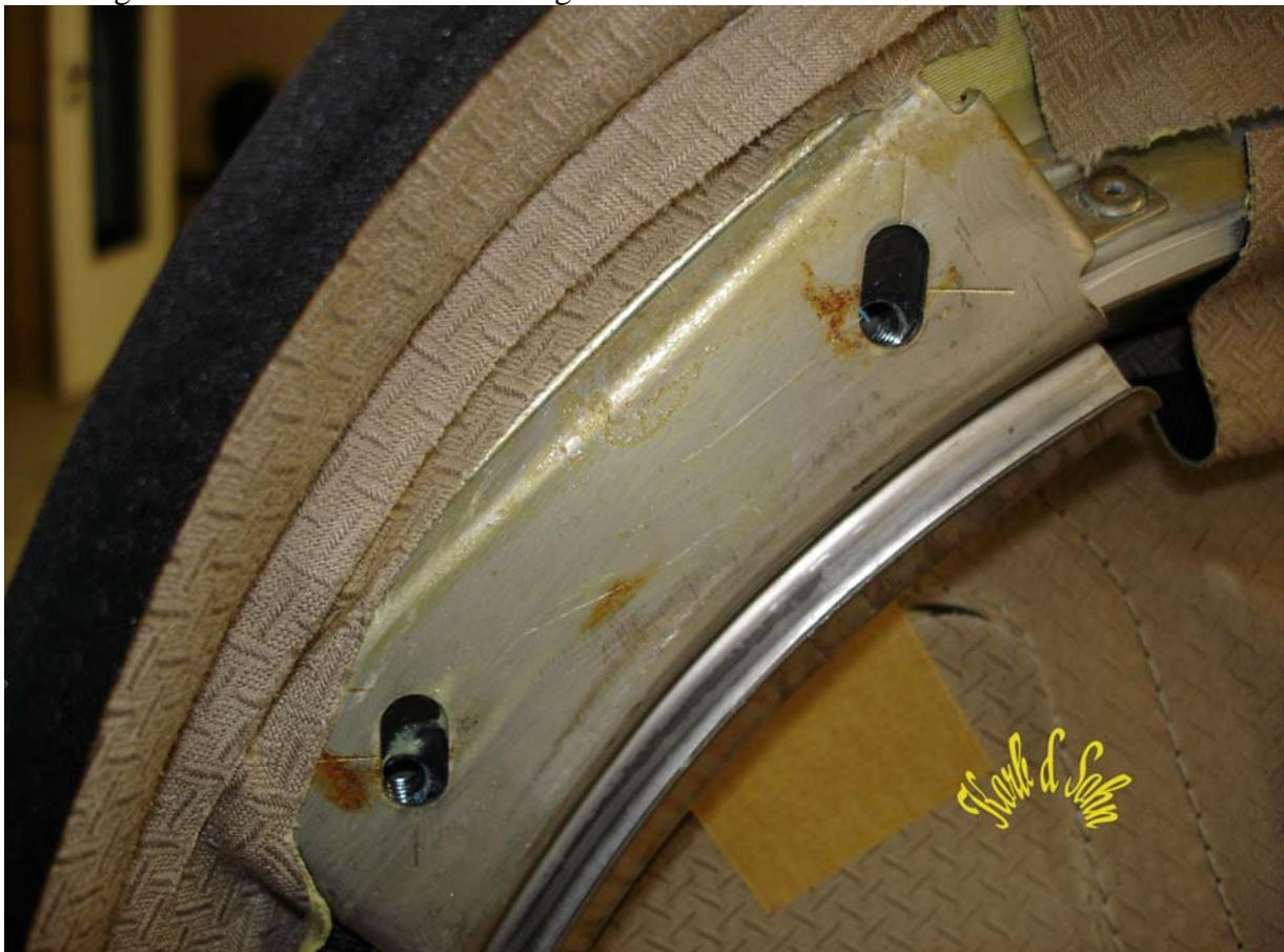
Hier wird die Spannung des unteren seitlichen Spanndrahtes eingestellt.
