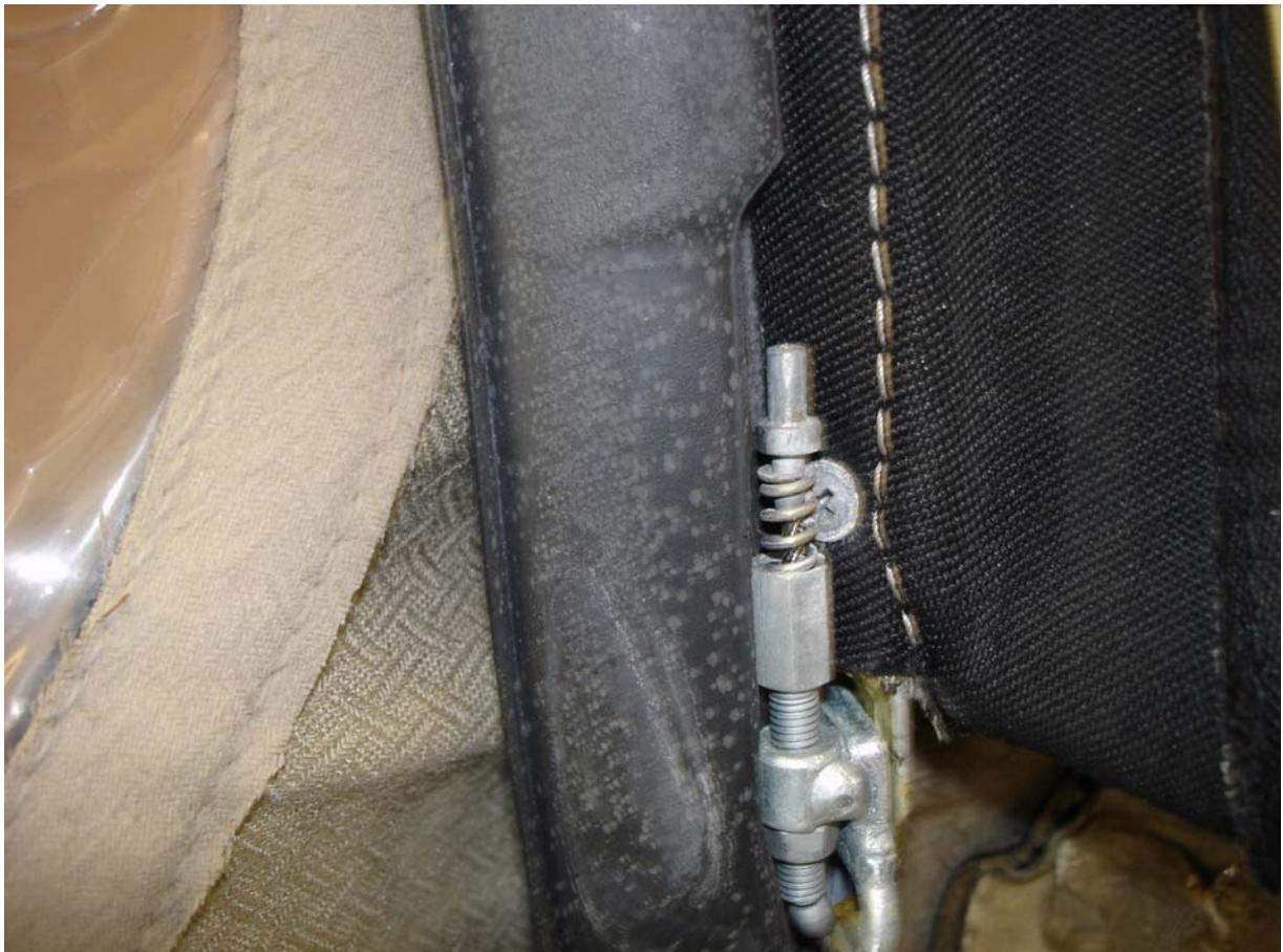
Hier wird die Spannung für die oberen seitlichen Spanndrähte eingestellt.
