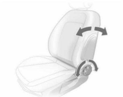
Handrad drehen. Zum Einstellen Rückenlehne entlasten.
