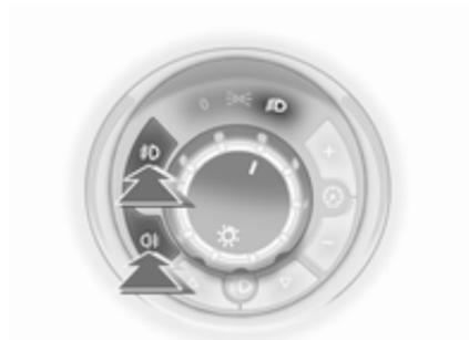
Die Nebelscheinwerfer lassen sich nur bei eingeschalteter Zündung und eingeschalteten Scheinwerfern einschalten.
