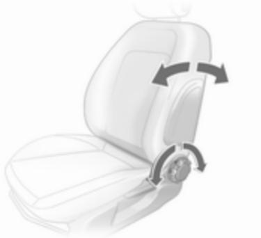
Handrad drehen. Zum Einstellen Rückenlehne entlasten.
