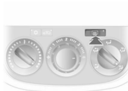
Die Heizung wird durch Drücken der Taste
