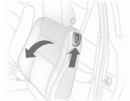
Entriegelungshebel anheben und Sitzlehne nach vorn klappen. Entriegelungshebel absenken, die Lehne rastet in nach vorn geklappter Lage ein. Sitz nach vorn schieben.
