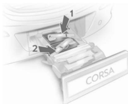
Lampenträger an den Rückseiten der Rückleuchten einklappen.
