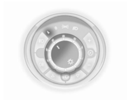
Lichtschalter auf **A**: Bei laufendem Motor werden die Scheinwerfer abhängig von den äußeren Lichtverhältnissen eingeschaltet.
