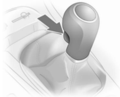
Zum Einlegen des Rückwärtsgangs nach dem Treten des Kupplungspedals bei stehendem Fahrzeug 3 Sekunden warten, anschließend den Knopf am Wählhebel nach oben ziehen und Gang einlegen.
