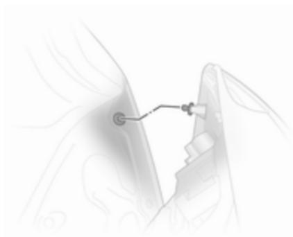
9. Lampengehäuse in Karosserie einsetzen, Befestigungsmuttern von Hand festziehen. Kabelstecker einrasten. Abdeckung schließen.
