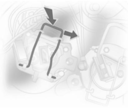
3. Federdrahtbügel aus den Haltenasen ausrasten und zur Seite schwenken.
