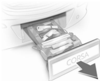
Das Heckträgersystem vollständig bis zum Einrasten herausziehen.
