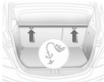
Top-Tether Kindersicherheitssysteme an den Befestigungsösen an der Rückseite der Sitzlehnen der Rücksitze und im hinteren Fußraum an der Sitzschiene des Beifahrersitzes befestigen. Der Gurt muss zwischen den beiden Führungsstangen der Kopfstütze verlaufen.
