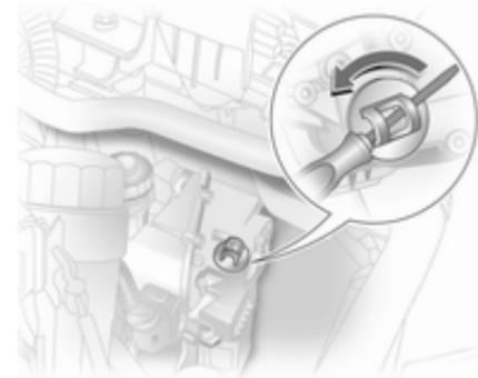
Muss das Fahrzeug aus dem fließenden Verkehr entfernt werden, wie folgt auskuppeln:
