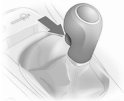
Rückwärtsgang: Nach dem Treten des Kupplungspedals bei stehendem Fahrzeug 3 Sekunden warten, anschließend Knopf am Wählhebel nach oben ziehen und Gang einlegen.
