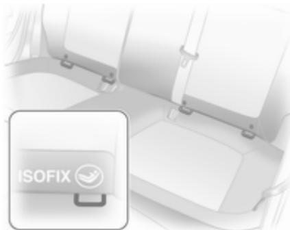
Für das Fahrzeug zugelassene ISOFIX Kindersicherheitssysteme an den Befestigungsbügeln befestigen.
