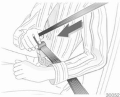
Gurt aus dem Aufroller herausziehen, unverdreht über den Körper legen und die Schlosszunge in das Gurtverschluss einrasten. Den Beckengurt während der Fahrt durch Ziehen am Schultergurt regelmäßig spannen.
