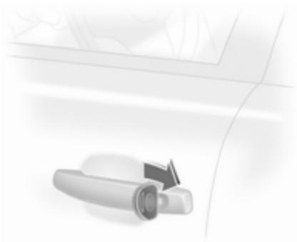
Schlüssel im Fahrertürschloss in Richtung Fahrzeugheck drehen.
