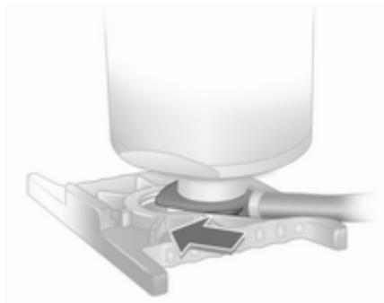
3. Dichtmittelflasche auf Halter stecken. Sicherstellen, dass die Flasche nicht umfällt.
