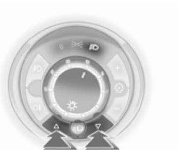
Leuchtweite der Fahrzeugbeladung anpassen, um das Blenden anderer zu vermeiden: Taste Δ oder ∇ schrittweise drücken, bis die gewünschte Einstellung im Kilometer-Display angezeigt wird. Die Anzeige erscheint bei Einschalten des Abblendlichts oder bei jeder Veränderung der Leuchtweite 4 Sekunden lang zusammen mit dem Symbol
