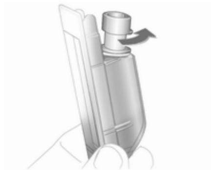
4. Lampenträger links herumdrehen und austragen.
