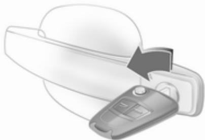
Den Schlüssel im Fahrertürschloss bis zum Anschlag drehen. Bei Öffnen der Fahrertür wird das gesamte Fahrzeug entriegelt. Zum Öffnen der anderen Türen die Zündung einschalten und die Zentralverriegelungstaste drücken.
