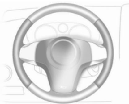
Das Lenkrad wird bei laufendem Motor in dem in der obigen Abbildung gezeigten Bereich beheizt.
