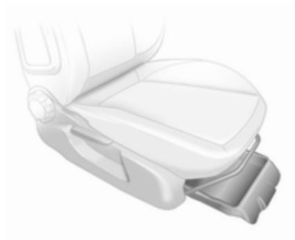
An Griffmulde anheben und herausziehen. Maximale Belastung: 1,5 kg. Zum Schließen einschieben und einrasten.
