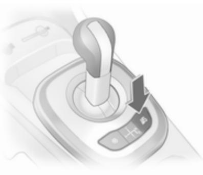
Bei eingeschaltetem Sport-Modus werden die Schaltzeiten verkürzt und die Gänge bei höheren Drehzahlen geschaltet, jedoch nicht bei eingeschaltetem Geschwindigkeitsregler.
