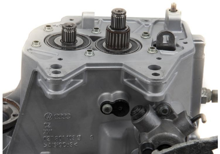
Brillen- und Nadellager eines 02T Getriebes
