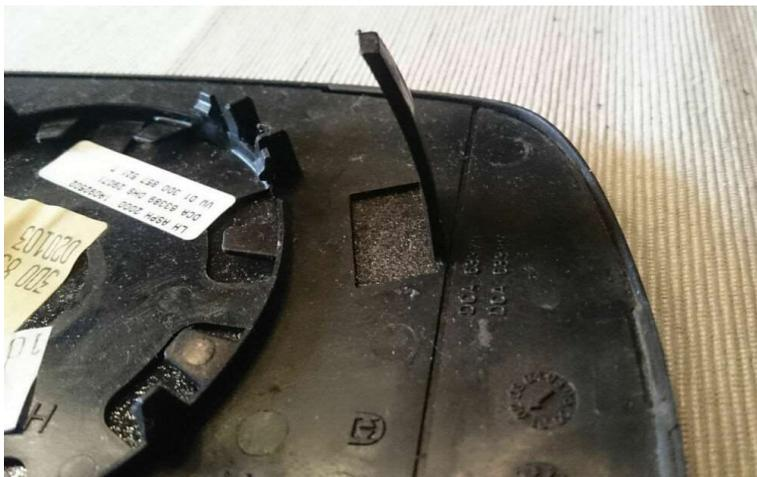
2. Am Spiegel ist ein Stecker für die Abdunkelung und zwei Einzelkontakte für die Heizung. Wer sichergehen möchte kann den Spiegel abstecken, es reicht aber, wenn er mit Klebeband am Gehäuse fixiert wird.
