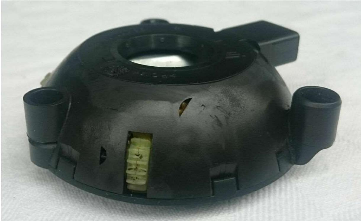
4. Schon beim Anfassen wird deutlich wo das Problem liegt: Schmutz. Der kriecht natürlich überall hin, weil weder der Spiegel noch die Antriebseinheit dicht sind. Die zentrale Schraube entfernen und an einer großen Lücke beginnend, den Deckel an den Rastnasen rundherum abhebeln.
