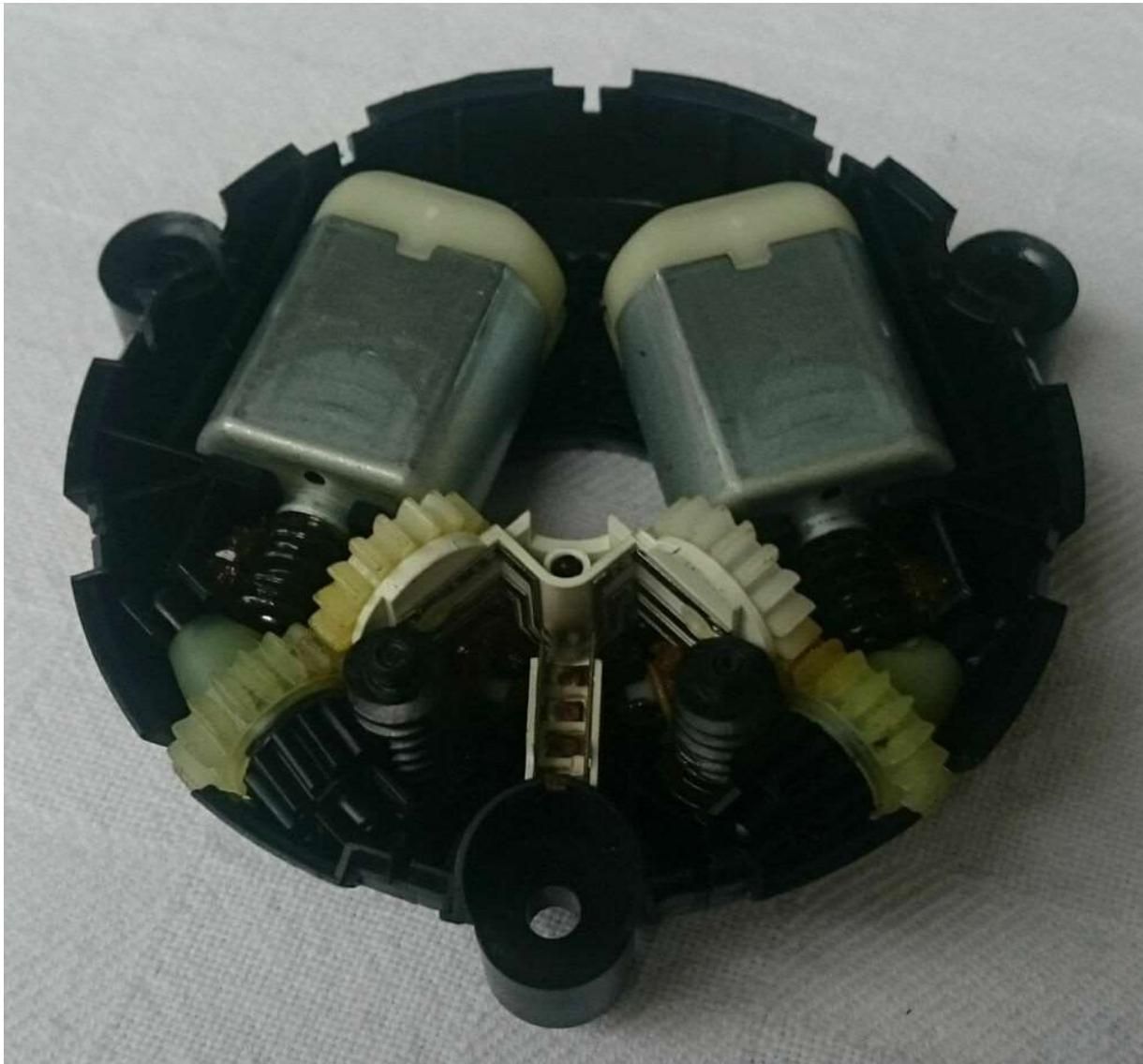
9. Zusammenbauen: das Gleitstück in der Mitte aufsetzen und die Motoreinheit wieder zusammenschnappen. Anstecken und wieder in das Spiegelgehäuse einschrauben. Der Spiegel wird vorsichtig eingeführt (Federklemme) und dann festgedrückt.
