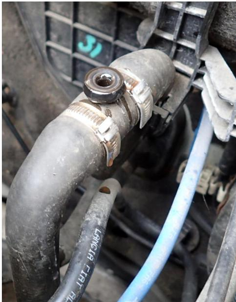
*Entlüftungsschraube am Wasserschlauch, der in Richtung Innenraum führt. Es ist nicht nötig, die Entlüftungsschraube ganz herauszudrehen, so wie im Bild.*
