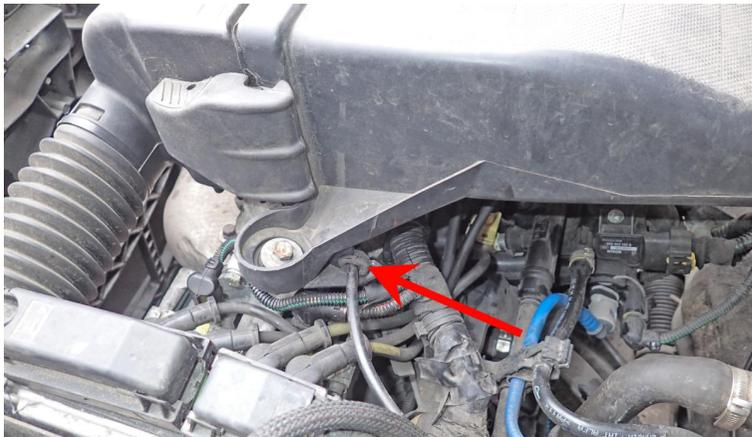
*Halterung des Gaszugs am Luftfilter*
