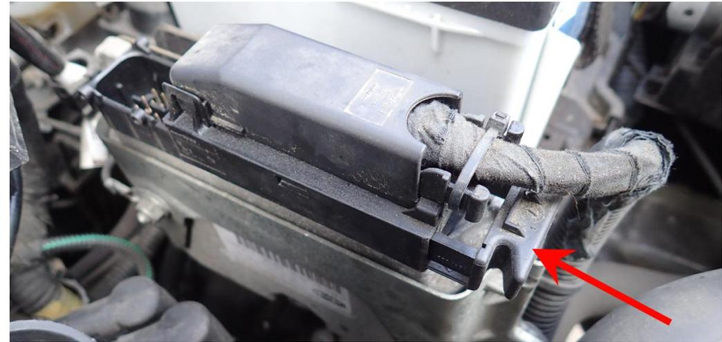
*An der Verriegelung ziehen, um den Stecker zu lösen.*
