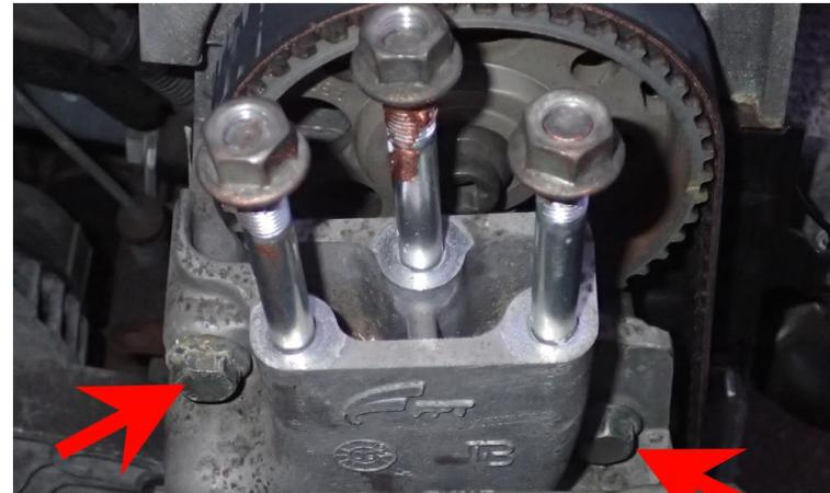
*Fester Teil des zweiteiligen Motorlagers. Im Bild sichtbar die beiden oberen Schrauben. Zwei weitere sind unten.*
