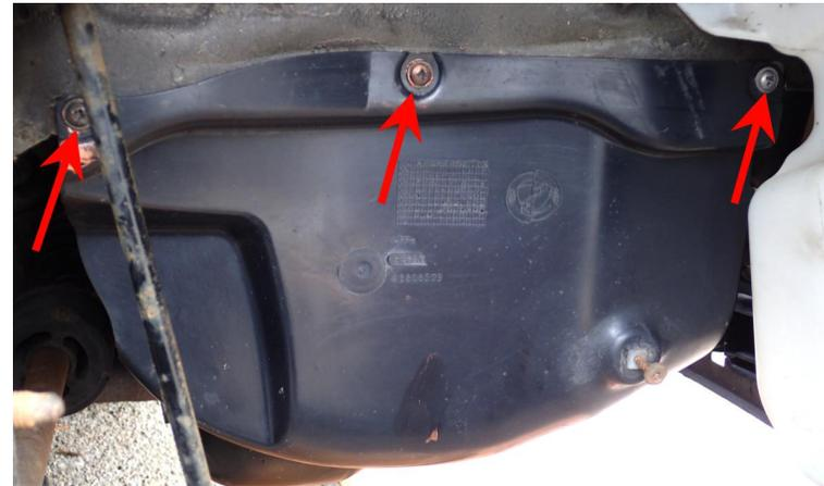
*Staubschutzabdeckung des Motors.*
