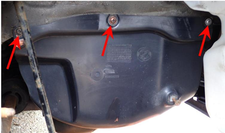
*Staubschutzabdeckung des Motors*
