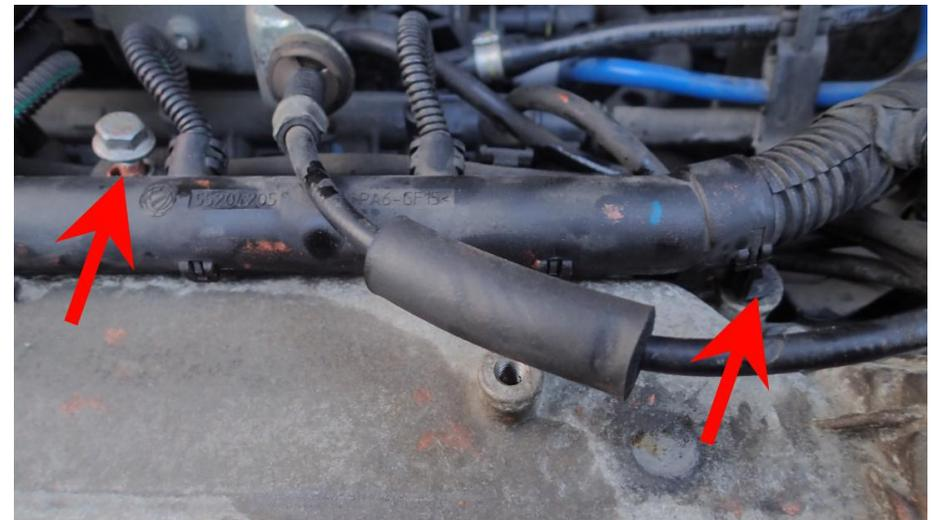
*Befestigung des Rohres mit den Kabeln. Links eine Schraube, rechts das kleine Plastikteil in das Loch stecken.*
