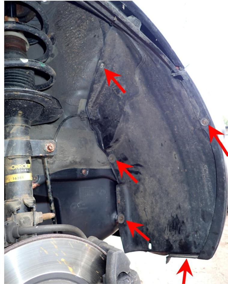
*Die Mutter (oben) und die vier Schrauben der vorderen Hälfte der Radhausverkleidung (die untere ist im Bild nicht sichtbar)*
