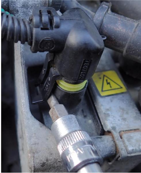
*Lösen der Stecker der Zündspulen-Stromversorgung*
