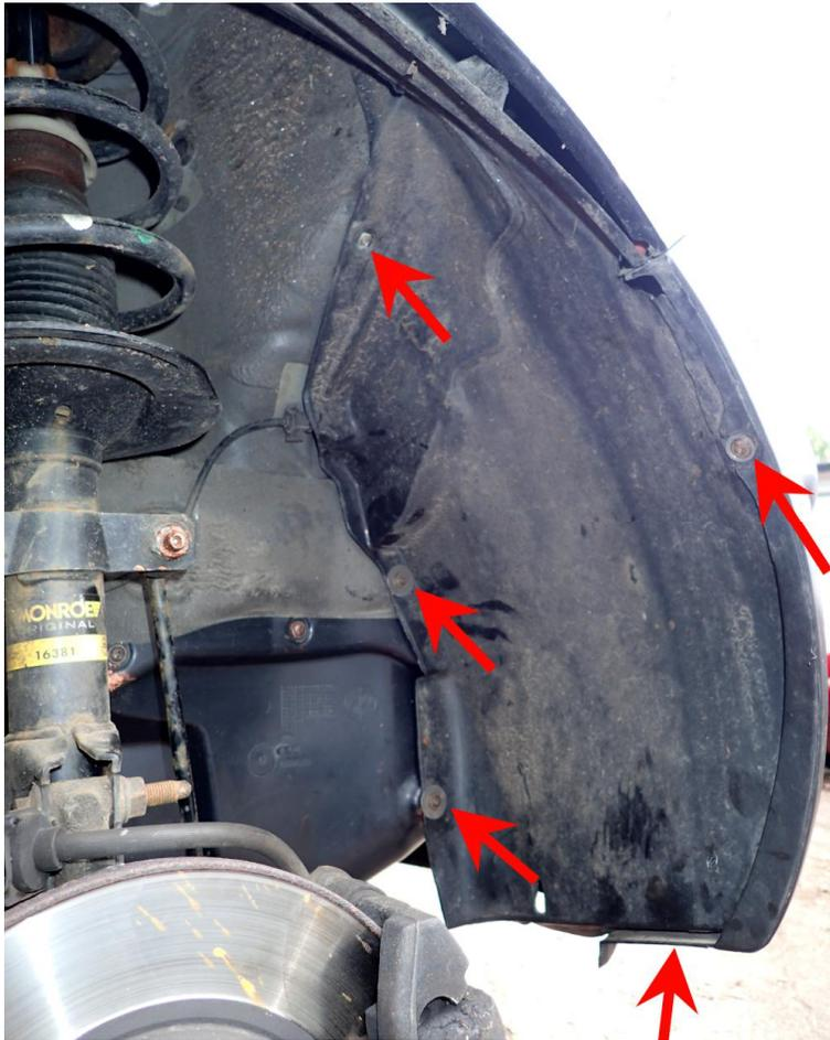
*Die Mutter (oben) und die vier Schrauben der vorderen Hälfte der Radhausverkleidung (die untere ist im Bild nicht sichtbar)*
