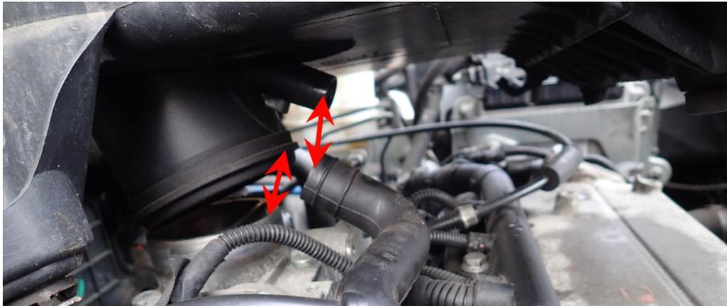
*Die beiden Anschlüsse des Luftfilterkastens (oben) zum Motor.*
