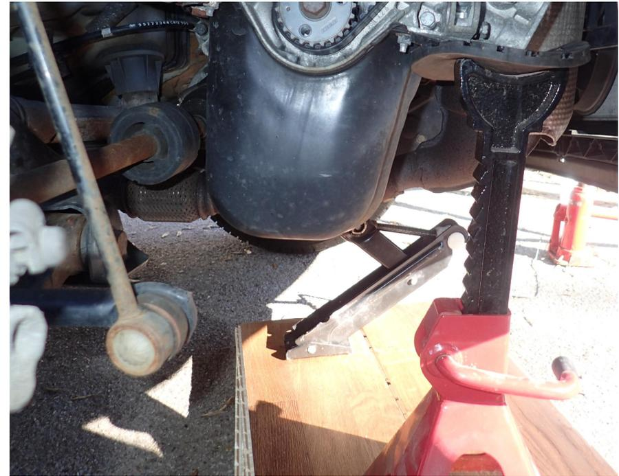
*Stütze unter dem Motor (Vordergrund) und Wagenheber unter dem Getriebe (Hintergrund)*
