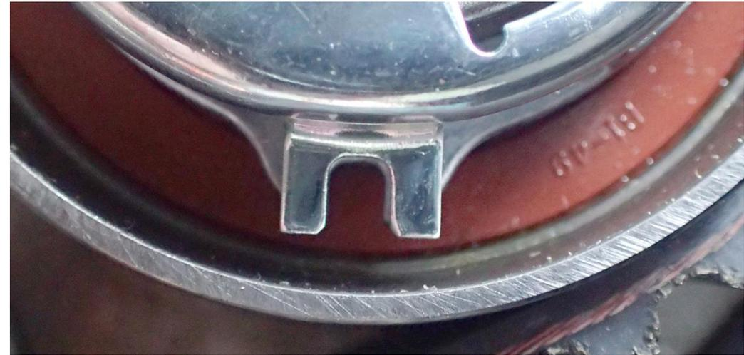
*Position der Markierungen der Spannrolle beim zweiten Spann-Durchgang.*
