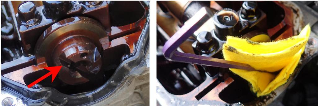
*Schlitz Nockenwellen-Ende (links) und Arretierung mittels Inbusschlüssel im Lappen (rechts)*
