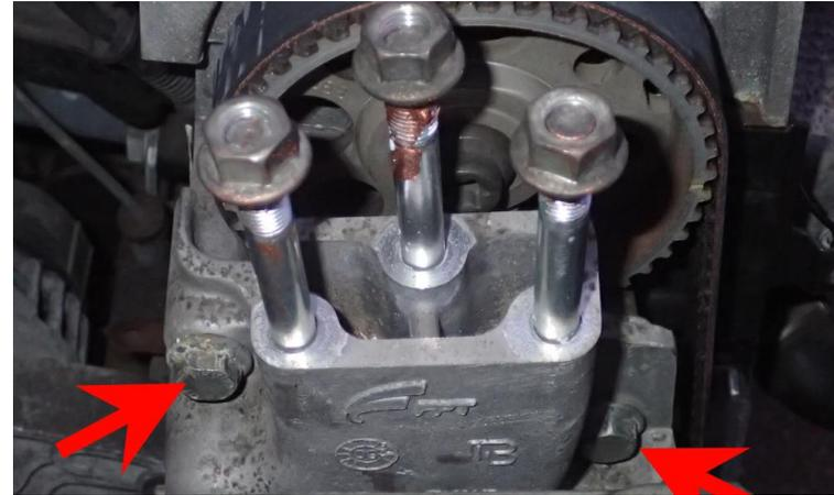
*Fester Teil des zweiteiligen Motorlagers. Im Bild sichtbar die beiden oberen Schrauben.*
