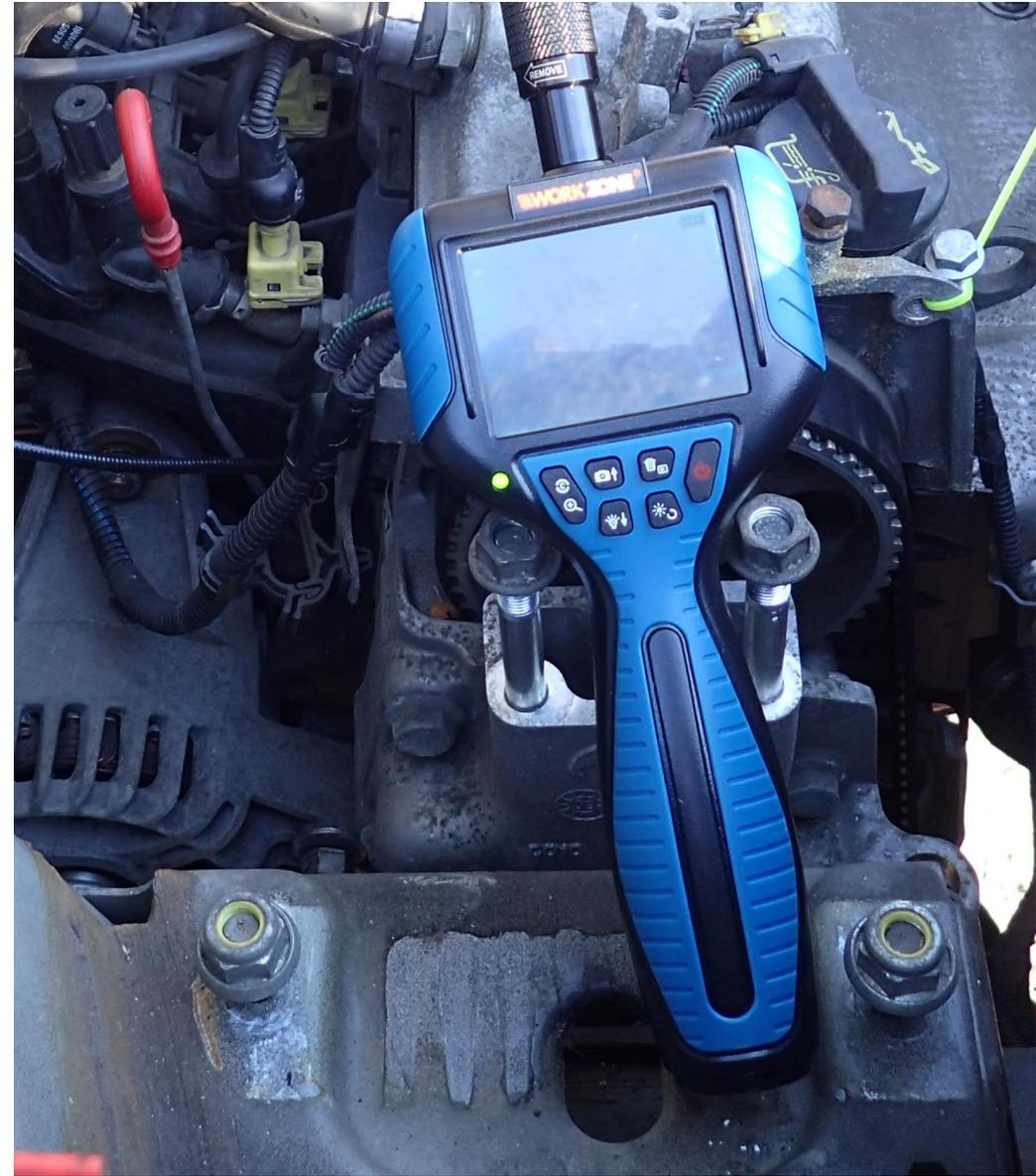
*Oberen Totpunkt mittels Inspektionskamera ermitteln*
