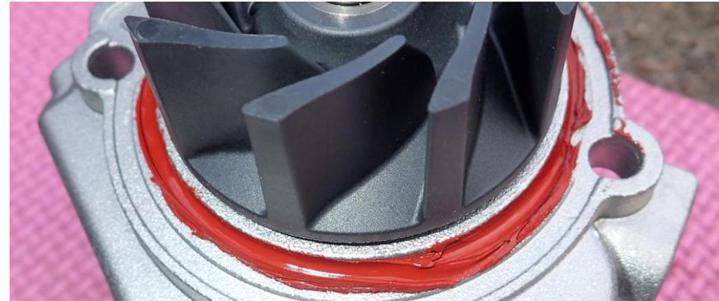
*Neue Dichtmasse an der neuen Wasserpumpe*
