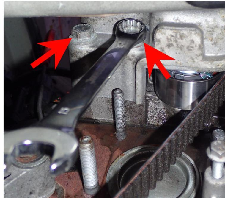
*Von unten zieht man die beiden unteren Schrauben des festen Teils des Motorlagers fest.*
