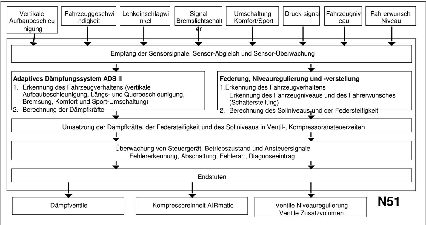
Das Steuergerät AIRmatic mit ADS ist funktionell wie folgt aufgeteilt:
