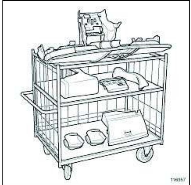
Die ausgebauten Teile in Rangierkästen verstauen, um sie nicht zu beschädigen oder zu verlegen.
