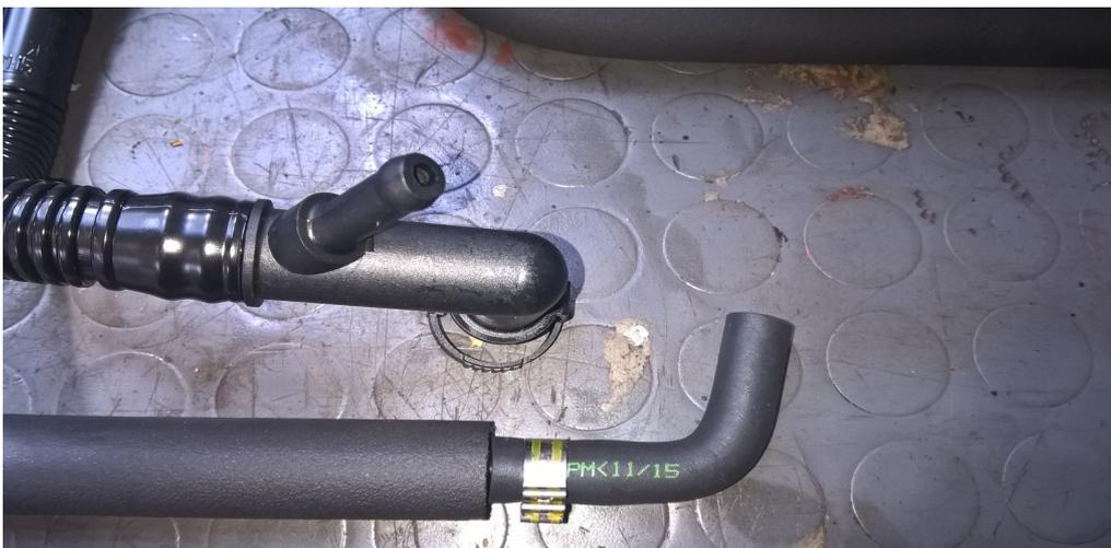
Die KGE ist vor allem bei vielen Kurzstrecken und bei kaltem Wetter sehr anfällig. Das Öl verschlammte und friert bei sehr niedrigen Temperaturen ein. Dann entsteht ein sehr hoher Druck im Kurbelgehäuse was zu einem kapitälen Motorschaden führen kann. Die Kunststoffrohre unterliegen durch das Öl ebenfalls einer Versprödung und brechen. Die Membran im Druckregelventil reißt und der Motor hört sich an wie eine fahrende Hupe.
