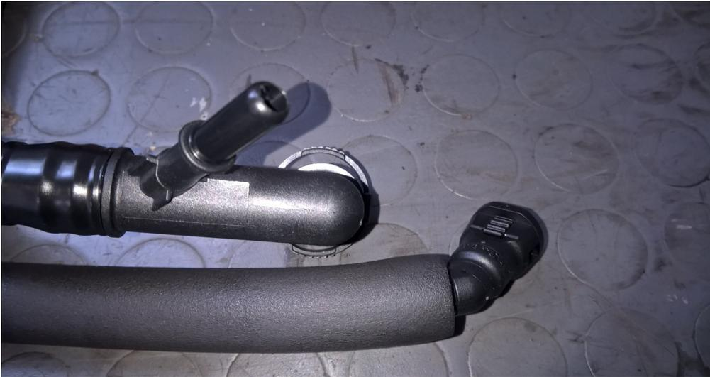
Bei der "älteren" Variante ist die Rücklaufleitung teilweise aus Gummi und dieser altert deutlich schneller als das Kunststoffrohr.
