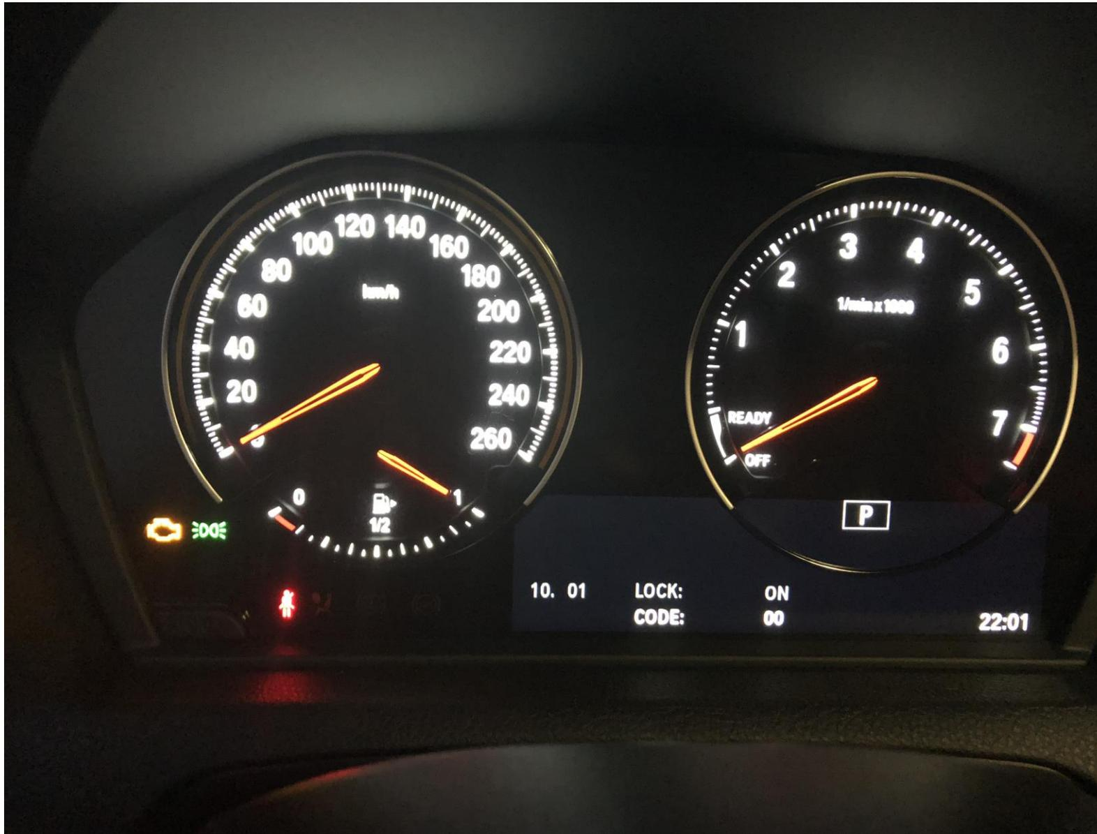
Nun musst du die Quersumme aus den letzten 5-6 Stellen deiner Fahrgestellnummer (FIN/VIN) ausrechnen, also wird z.B.aus „...8B12015“ „9“. Das Ergebnis wird durch kurzes Drücken auf den „Krsk“ eingegeben und durch langes Drücken bestätigt.
