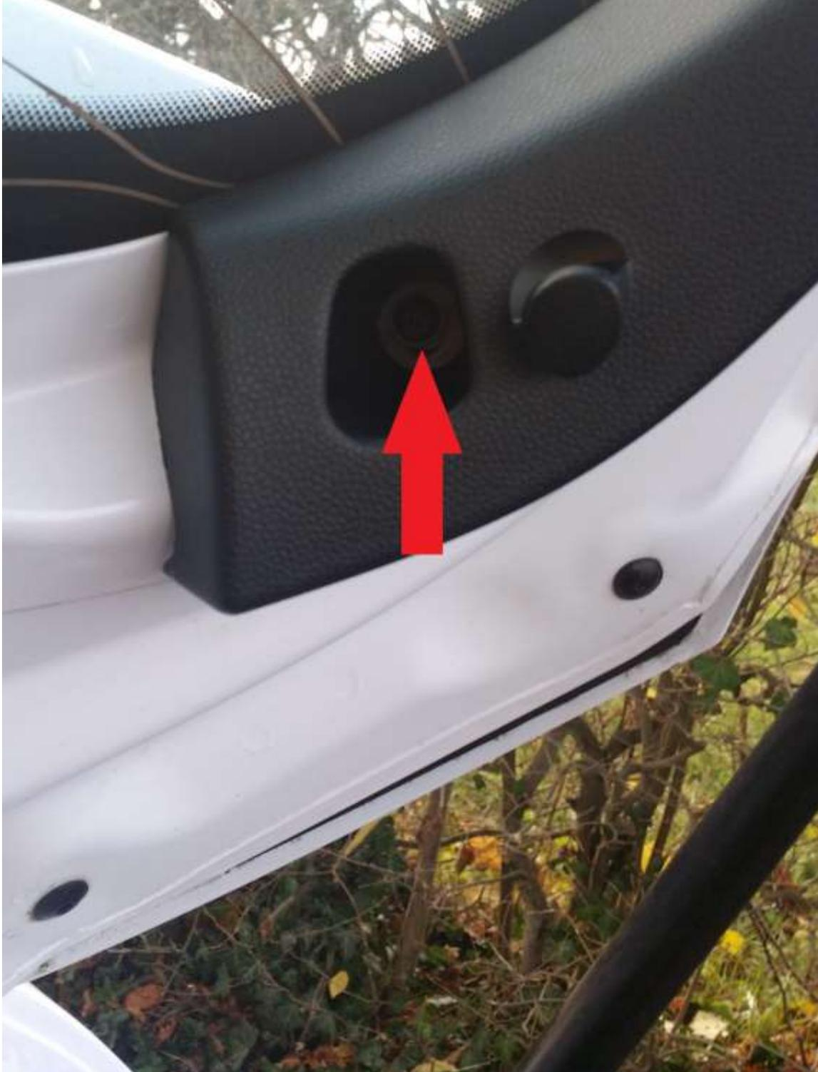
Danach kann die große Kunststoffabdeckung entfernt werden. Dazu muss eine Schraube in der Griffmulde entfernt werden. Nun kann die Abdeckung mit etwas Kraft abgezogen werden.(auch geklipst)
