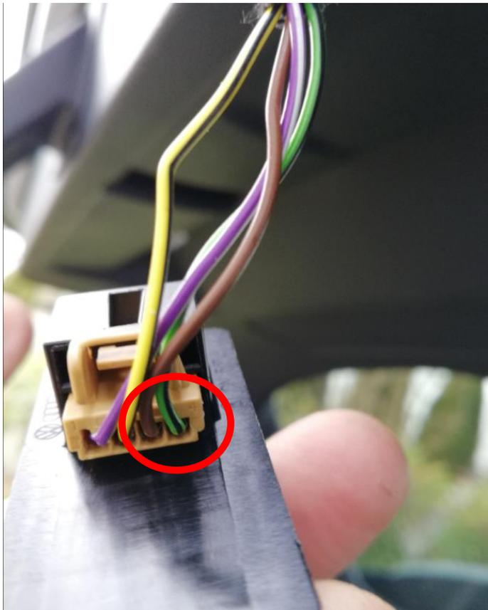
Diese vorhandene Durchföhrung habe ich für die Kabel der Aussensensoren verwendet:
