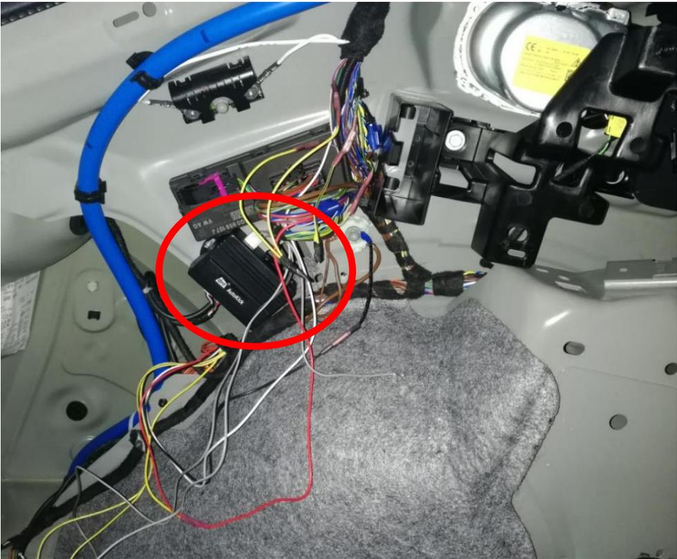
Montage Box und Schraube für die Befestigung der Massen:
