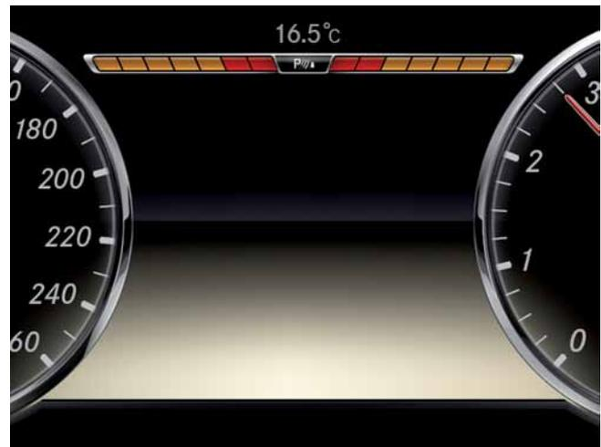
Warnanzeige Einparksystem Kombiinstrument
