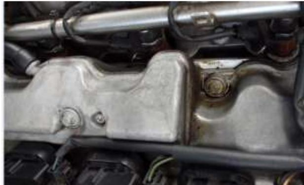
Als nächstes den Entlüftungsschlauch und die hinteren 3 Stecker von den Zündspulen abziehen und auf die Seite legen. (Blaue Pfeile) Aufpassen, Rastnasen an den Steckern nicht abbrechen!
