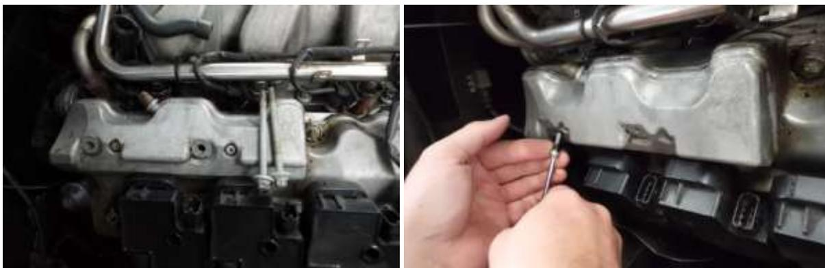
Nun kann man den Deckel herunternehmen. Eventuell muss man ihn vorsichtig /sanft mit dem Schlitzschraubendreher oder einem Plastikkeil abhebeln. Darauf achten, dass dabei die Dichtfläche nicht beschädigt wird. **ACHTUNG:** Aufpassen, dass keine Stücke der alten Dichtmasse in die offenen Ölkanäle gelangen!! Mit Dichtmittel verstopfte Ölkanäle können zu Motorschäden führen!
