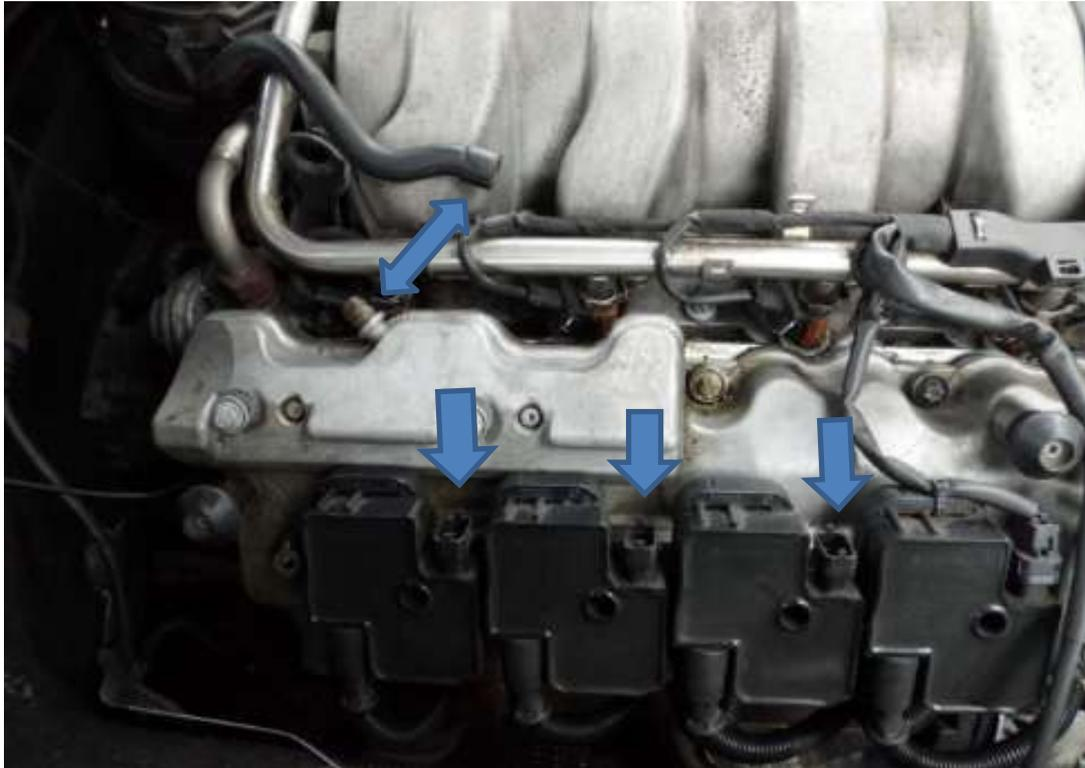
Danach die 2 Torx E11 Schrauben (lang) und die 2 Torx T25 Schrauben (kurz) lösen.
