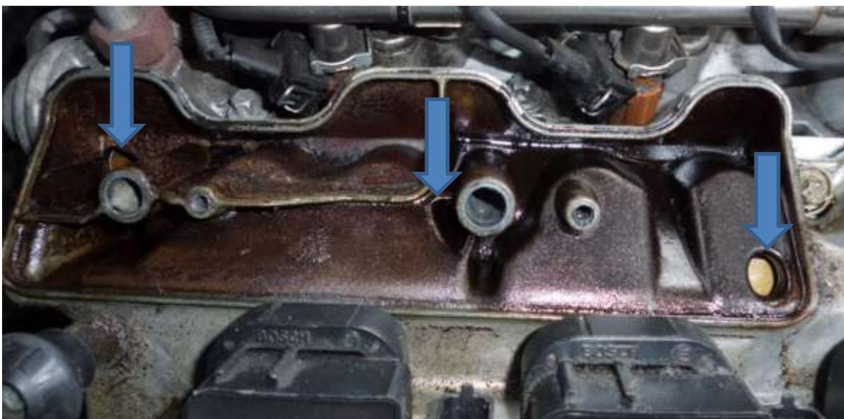
Zum Reinigen des Gehäuses die offenen Ölkanäle mit einem fusselfreien Lappen o.ä. abdecken bzw. verschließen, damit keine Reste des alten Dichtmittels oder Ablagerungen hineingelangen können.
