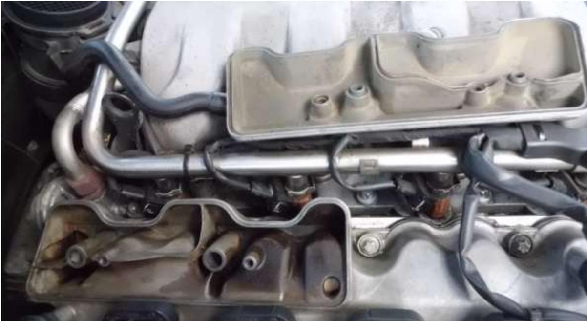
Jetzt kann es auch schon an das Aufbringen der speziellen Dichtmasse LOCTITE 5970 gehen. Bitte nur dieses Dichtmittel verwenden, um wiederholte Undichtigkeiten zu vermeiden. Es kann bei MB bestellt oder im freien Handel bezogen werden. Für die kleine Abdeckung auf der rechten Seite (wie hier beschrieben) genügt eine halbe Kartusche, für die größere Abdeckung auf der linken Seite braucht man wohl die ganze Kartusche (50ml).
