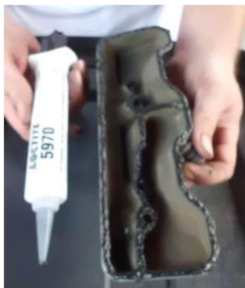
Den Deckel mit der Hand in die Passung (Nut- und Feder-System) einlegen und gleichmäßig leicht andrücken. Die 4 neuen Schrauben zuerst gleichmäßig mit der Hand einschrauben und dann mit einem Drehmoment von 4 Nm anziehen. ACHTUNG: 4 Nm sind nicht viel !!
