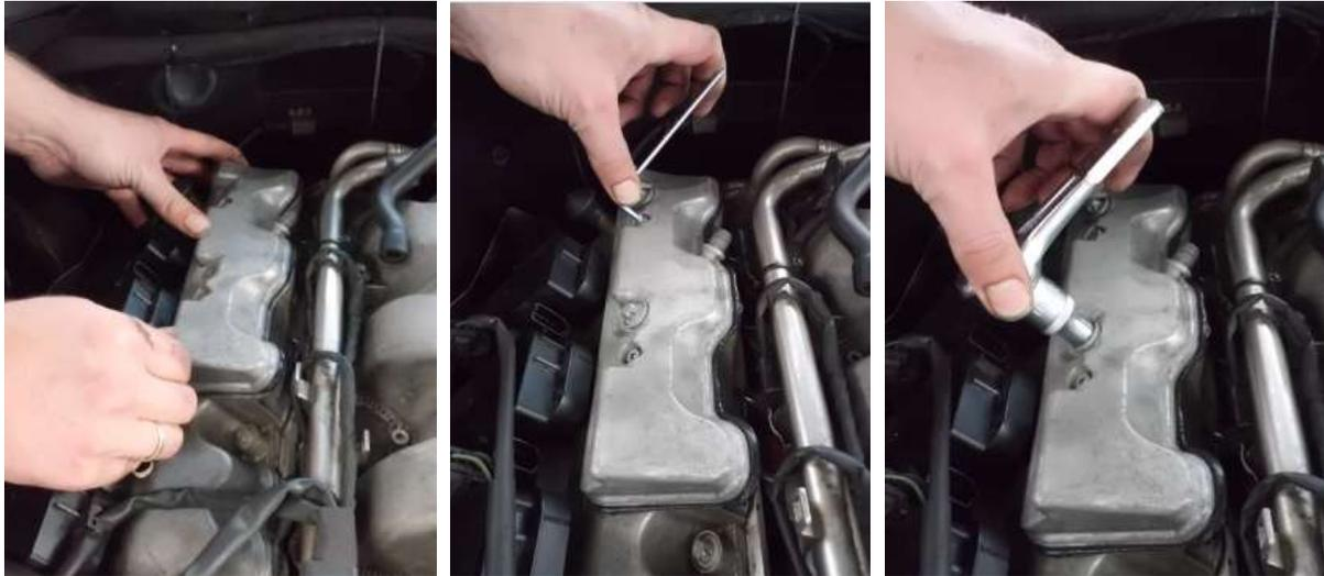
Nun noch die 3 Stecker auf die Zündspulen (Rastverschlüsse) sowie den Entlüftungsschlauch aufstecken.
