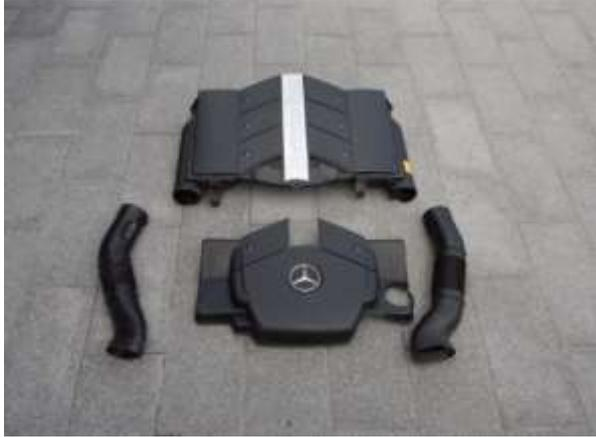
Dann die vordere Plastikverkleidung sowie das Luftfiltergehäuse inklusive Ansaugrohre abbauen.
