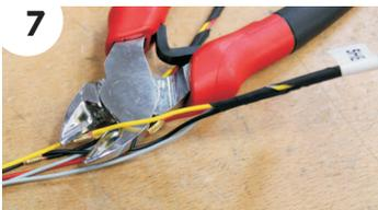
Schneiden Sie die Drähte von den flachen Kabeln ab.
