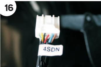
Stellen Sie sicher, dass die Anschlüsse im Stecker fest sitzen und schließen Sie die Sperrklinke ab. Setzen Sie den Stecker zurück an die Stelle auf.
