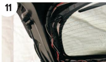
Führen Sie den Strang durch den originellen Kabelstrang zum Steckverbinder in der Mitte auf der Oberseite vom Kofferraumdeckel. Befestigen Sie das Kabel angemessen.
