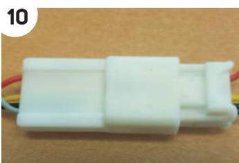
Verbinden Sie den Kabelstrang und die Kamera mit den Steckverbindern.
