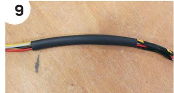
Ziehen Sie das große Wärmeschrumpfrohr über die kleine Wärmeschrumpfrohre aus dem Schritt 8 und schrumpfen Sie alle Drähte zusammen.
