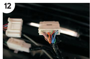
Ziehen Sie den Steckverbinder C-16 aus. Nehmen Sie das Band zum Teil aus und öffnen Sie die Sperrklinke.
