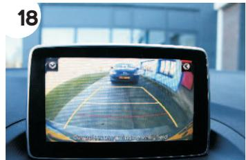
Test de werking van het systeem door de auto op contact te zetten en de achteruit in te schakelen.
