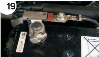
Setzen Sie die Kofferraumdeckelverkleidung sowie Kofferraumdeckelleiste zurück und schließen Sie den Deckel ab. Verbinden Sie den Minuspol der Batterie wieder.
