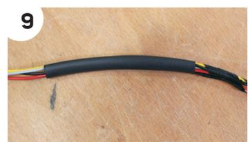
Ziehen Sie das große Wärmeschrumpfrohr über die kleine Wärmeschrumpfrohre aus dem Schritt 8 und schrumpfen Sie alle Drähte zusammen.
