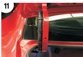
Nehmen Sie die Durchführungstülle aus und entfernen Sie das schwarze Klebeband und den Beginn sowie das Ende.
