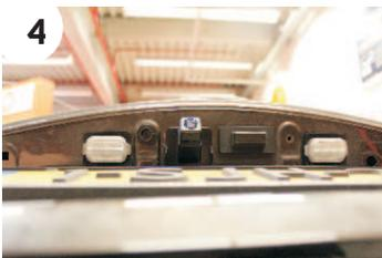
Führen Sie das mit der Kamera verbundene Kabel durch die Öffnung und rasten Sie die Kamera an der richtigen Stelle ein.
