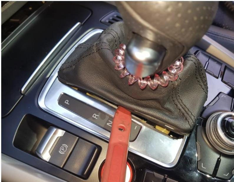
Diese ist nur gesteckt und kann mit dem Plastikkeil gelöst werden. Es reicht diese aus der Mittelkonsole zu lösen und muss nicht komplett ausgebaut werden.
