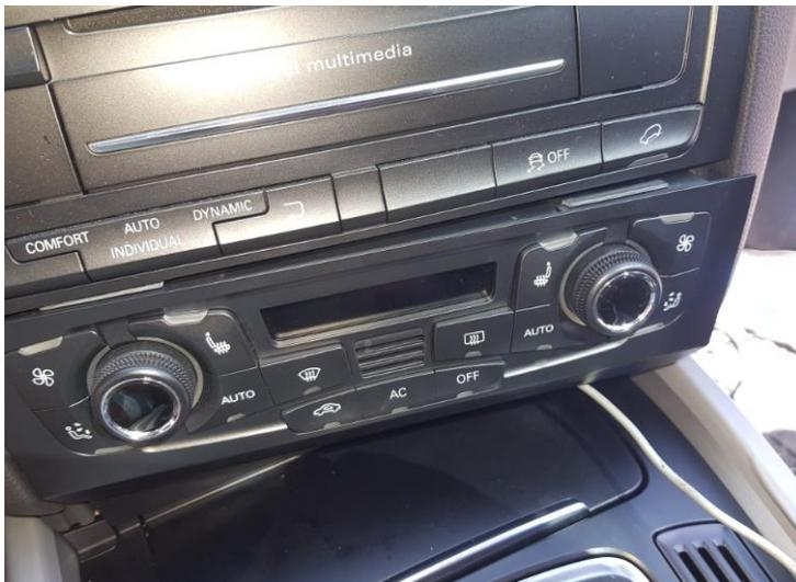
Dazu den Drahtstaken in einer der Öffnungen an der Unterseite ansetzen und Steuergerät herausziehen. Es ist nur gesteckt und kann herausgezogen werden. Eventuell mit dem Plastikkeil rundherum zusätzlich herausdrücken und ziehen. Danach abstecken und ablegen.
