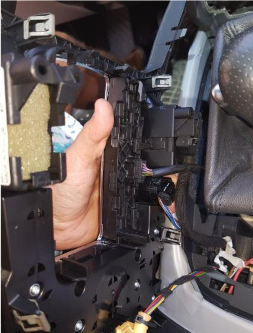
Den Multimediaeinsatz über den Getriebewählhebel ausfädeln (Ledermanschette kann etwas zusammengedrückt werden, damit man sie durch die Öffnung bringt), dann Stecker lösen und Multimediabedieneinsatz ablegen.
