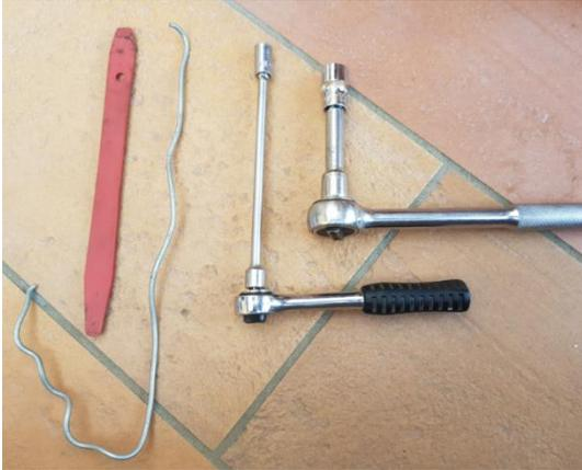
Plastikkeil, Drahthaken (zum Rausziehen des Klimasteuergeräts und der hinteren Lüftungsgittereinheit), 8mm und 13mm Nuss
