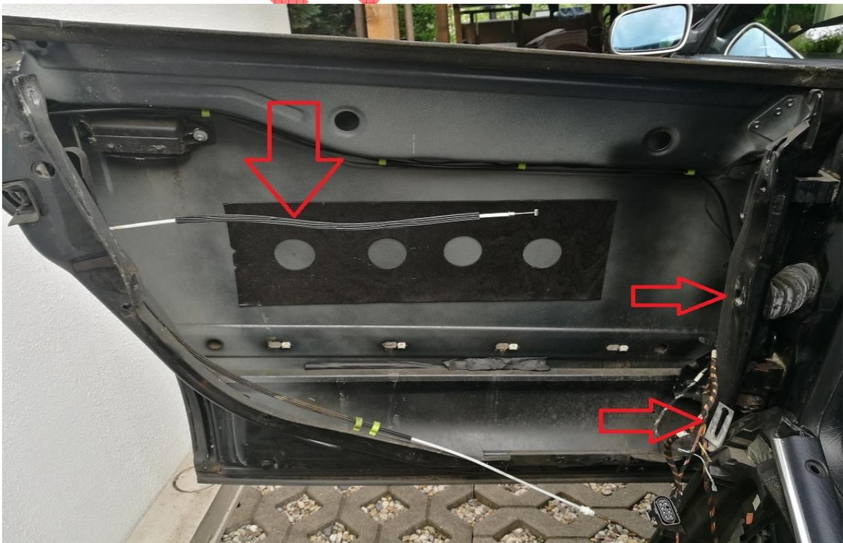
Seid Ihr soweit gekommen können wir uns nun dem Schloss widmen, dieses mit einem 30 bzw. 35 Torx lösen und gut aufheben, nachdem wir noch den Vacuumschlauch (roter Pfeil nach unten) von der Druckeinheit und die Verbindungsstange (roter Pfeil nach oben) zum Außentürgriff gelöst haben, kann das Schloss von innen herausgezogen werden, um nun endlich an die Verbindung (Bild 3 roter Pfeil) des Micro Schalters zu kommen (o;
