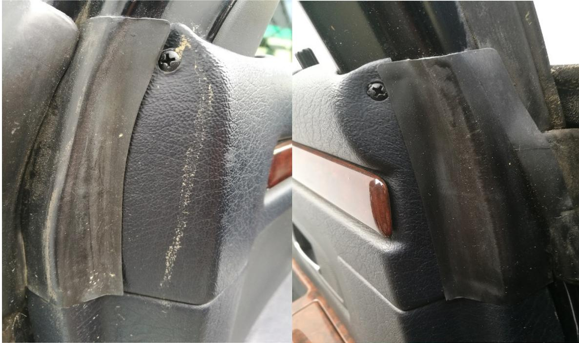
Diese Schrauben lösen wir nun alle und verstauen Sie in einem Aufbewahrungsbehälter (alternativ der nie benutzte Aschenbecher), damit nichts verloren geht (o:
