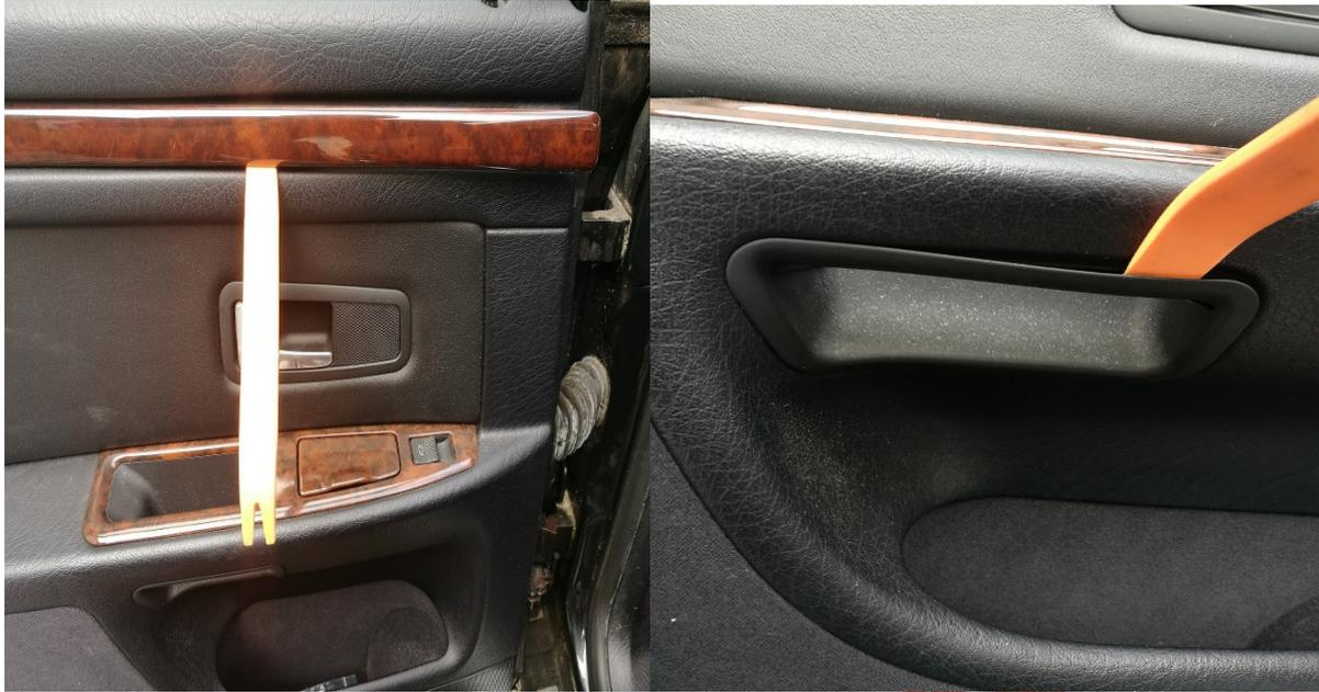
Die Zierleiste hat 5 Klipse und die Griffschale 4 Rastpunkte, nach dem entfernen sollte es so aussehen.
