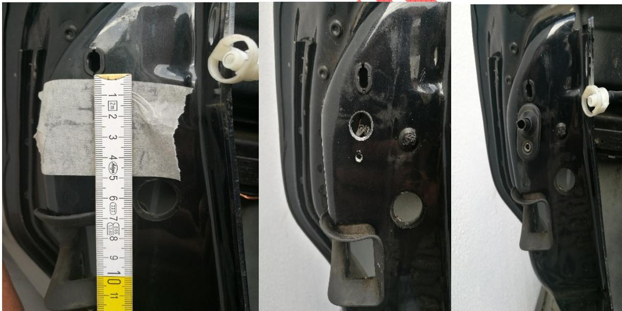
Danach setzt Ihr Euren neuen Türkontaktschalter ein, schließt das Kabel an und freut Euch nach dem umgekehrten Zusammenbau auf eine funktionierende Fußraum und Innenbeleuchtung.
