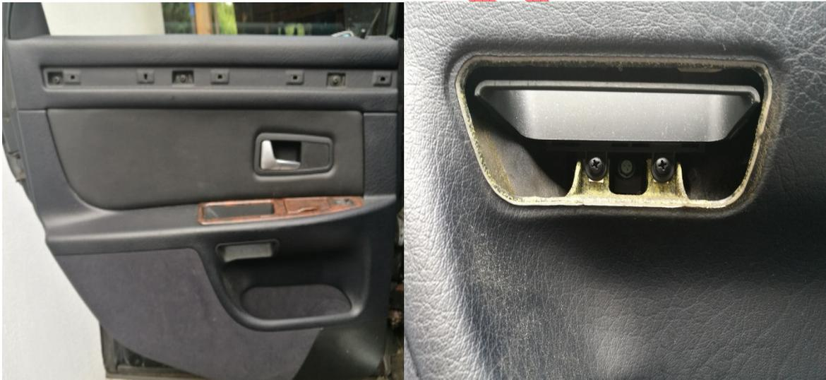
Hier sieht man jetzt auch schön die 3 Kreuzschrauben hinter der Zierleiste sowie die 2 Kreuzschrauben der Griffschale, sowie der etwas vertieften 8mm Schraube welche die Einheit der FH-Schalter hält.
