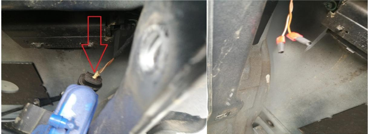
Nachdem dies erfolgt ist kommen wir jetzt zum Zerstörungswahn und Bohren ein Loch um den Türkontaktschalter in die Türkarosserie zu bekommen (o; , das Bohrmaß ist von der Halterung für die Türdichtung ca. 1,3 - 1,5cm (13mm bis 15mm) ich würde nach jetzigem Stand die 1,3cm (13mm) nehmen damit über dem Pumpengehäuse noch ein wenig mehr Platz ist. Mein Bohrmaß ist eine 26mm mit Stufenbohrer gewesen und ich habe gleich das Loch für die Verschraubung des Schalters mitgemacht.
