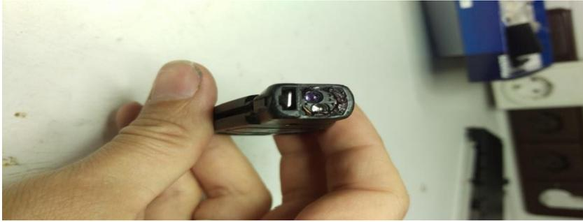
Hier im Beispiel ein Schlüssel aus dem W220, das Gehäuse ist vorne schon so beschädigt das man die IR Dioden sieht.
