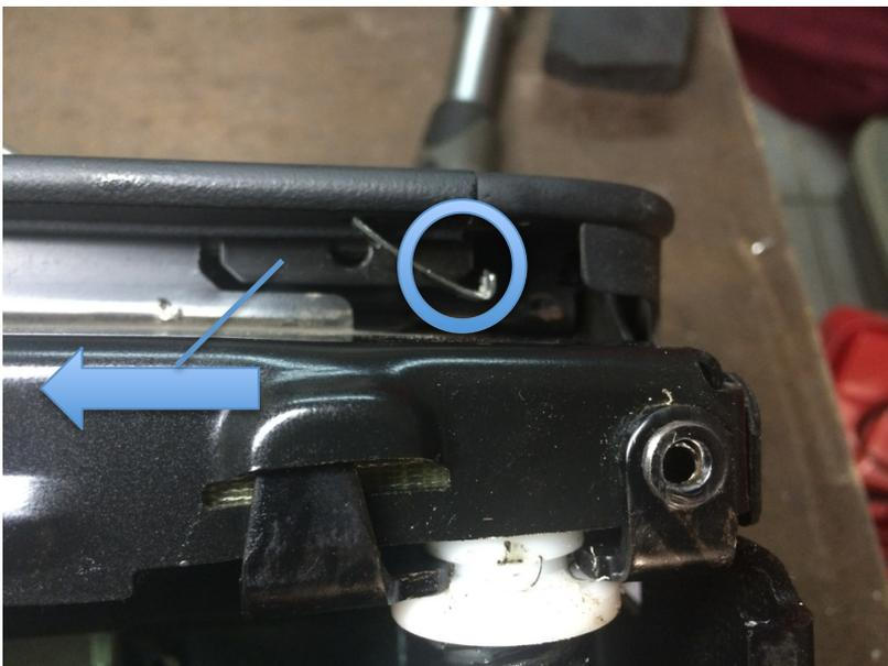
Danach kleinen Schraubenzieher in das Loch des L-Winkels stecken und das Teil in Wagenmitte schieben.
