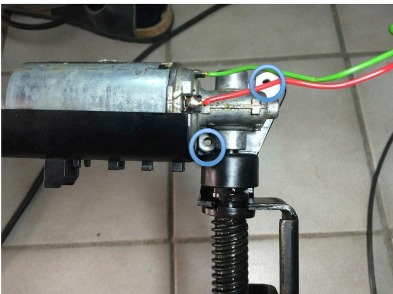
Falls das nicht klappt, den Motor vom Kunststoffträger abschrauben. Dazu zwei 8er Schrauben entfernen. Geht am besten mit einem 8er Gelenk-Ratschen-Schlüssel.
