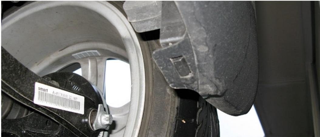
Nun ist die Blende nur mehr am Heckpanel eingesteckt/eingehakt. Auf beiden Seiten von aussen nach innen vorarbeiten, wobei die Blende zuerst in Richtung Rad ausgehängt werden muss - dann ist sie nur mehr eingesteckt. Die Bilder zeigen, was ich meine:
