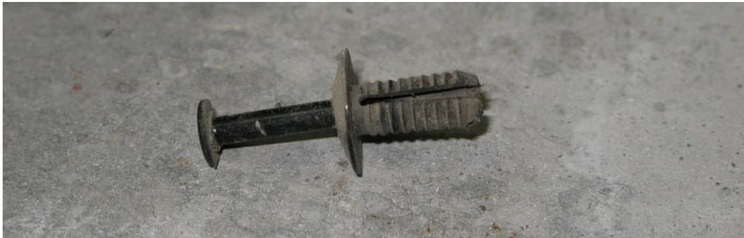
Im eingebauten Zustand steckt der Spreizstift ganz in der Niet drinnen und drückt sie dadurch auseinander. Ihr müsst zuerst mit einem kleinen Schlitzschraubenzieher versuchen, den Stift etwas aus der Niet herauszuhebeln, dann verwende ich immer eine kleine Zwickzange, mit der ich dann unter den Kopf hineinfahre - leicht! zusammendrücke und den Stift dann heraushebel - so wie hier bei einer anderen Niet dargestellt:
