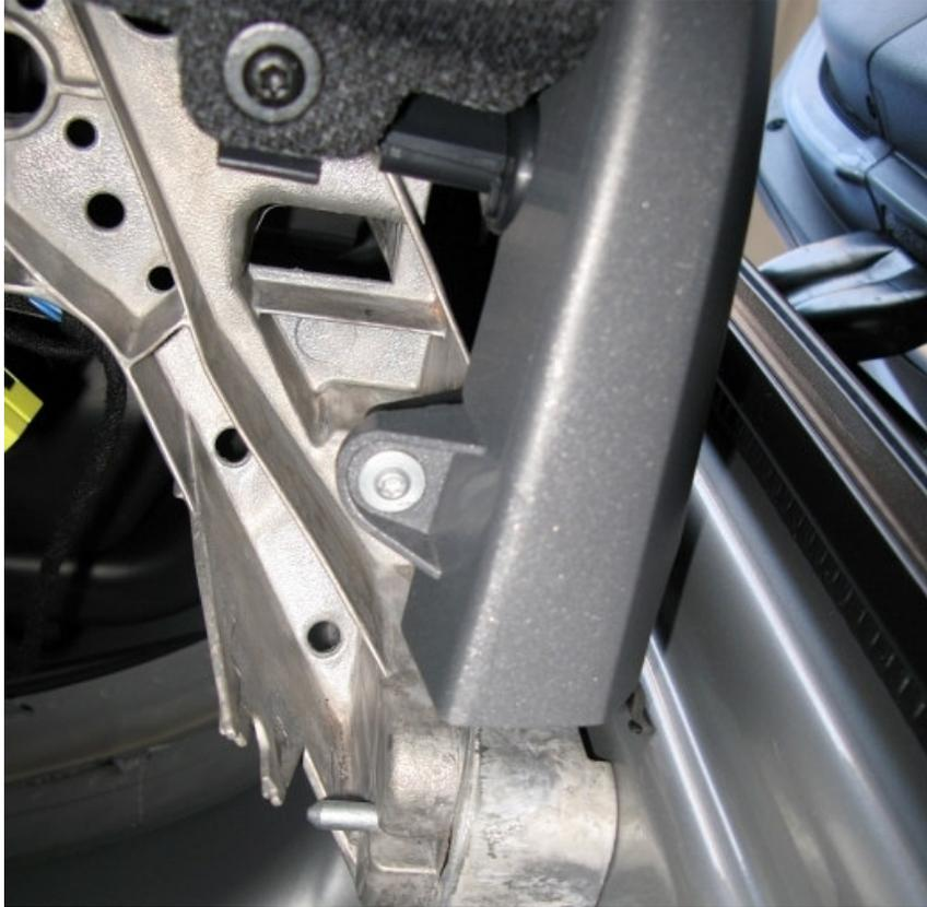
Der Rest der Blende ist nun nur mehr geklipst. Zuerst unten beginnen, indem die Blende nach unten und in Richtung (offener) Tür herausgeholt wird.
