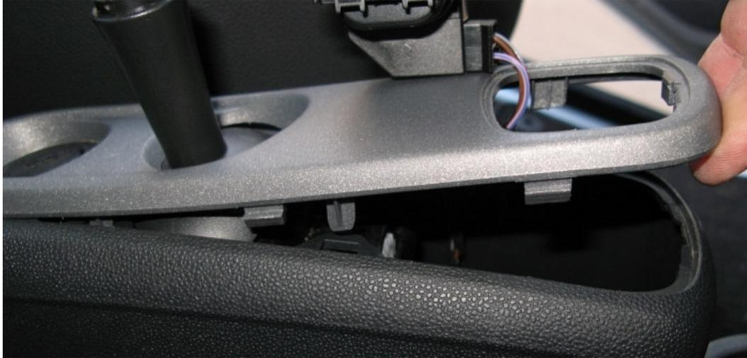
Hier nun ein Photo der demontierten Blende. Auch wieder gut zu erkennen, dass die Haltenasen massiv sind und eigentlich bei der Demontage nicht abgebrochen werden können. Die vier längeren Zungen dienen nur der Führung.
