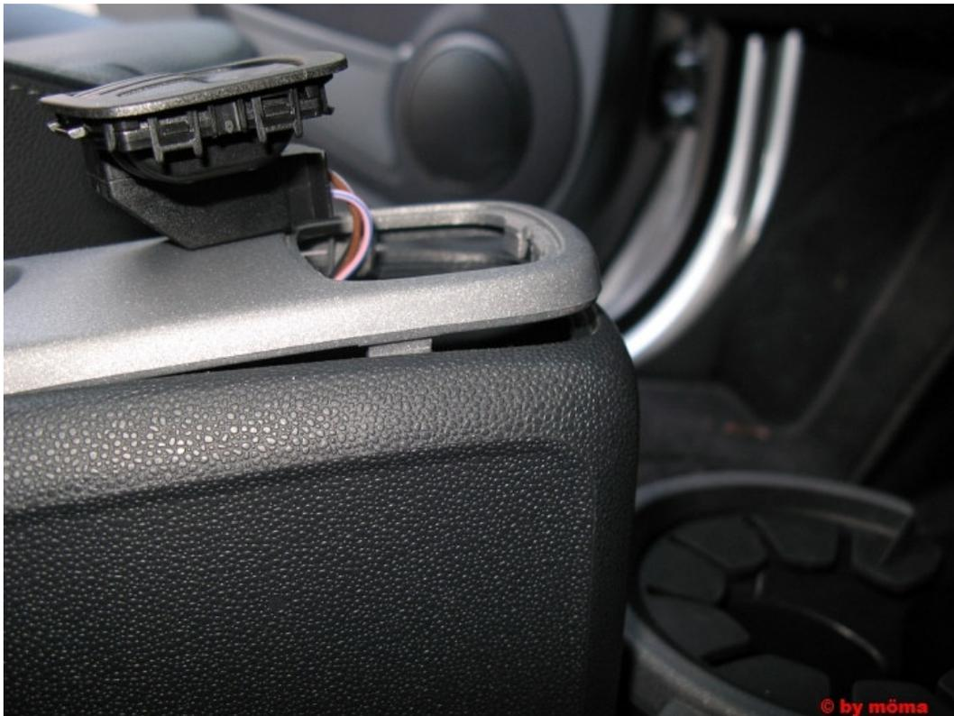
Nun kann die Blende ohne weitere Probleme bis nach hinten ausgeklipst werden. Letztendlich wird die Blende hinten ausgehängt.
