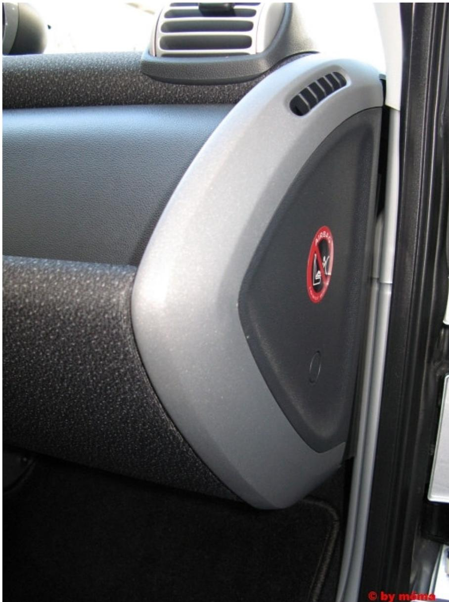
Zuallererst vom Fußraum aus unterhalb des Armaturenbrettes die einzige Torxschraube lösen, mit der die Blende angeschraubt ist (am Photo ist es die silberne Schraube).
