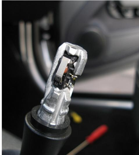
Zweite Vorarbeit ist das Entfernen des Münzfaches / Verdeckschalters:
