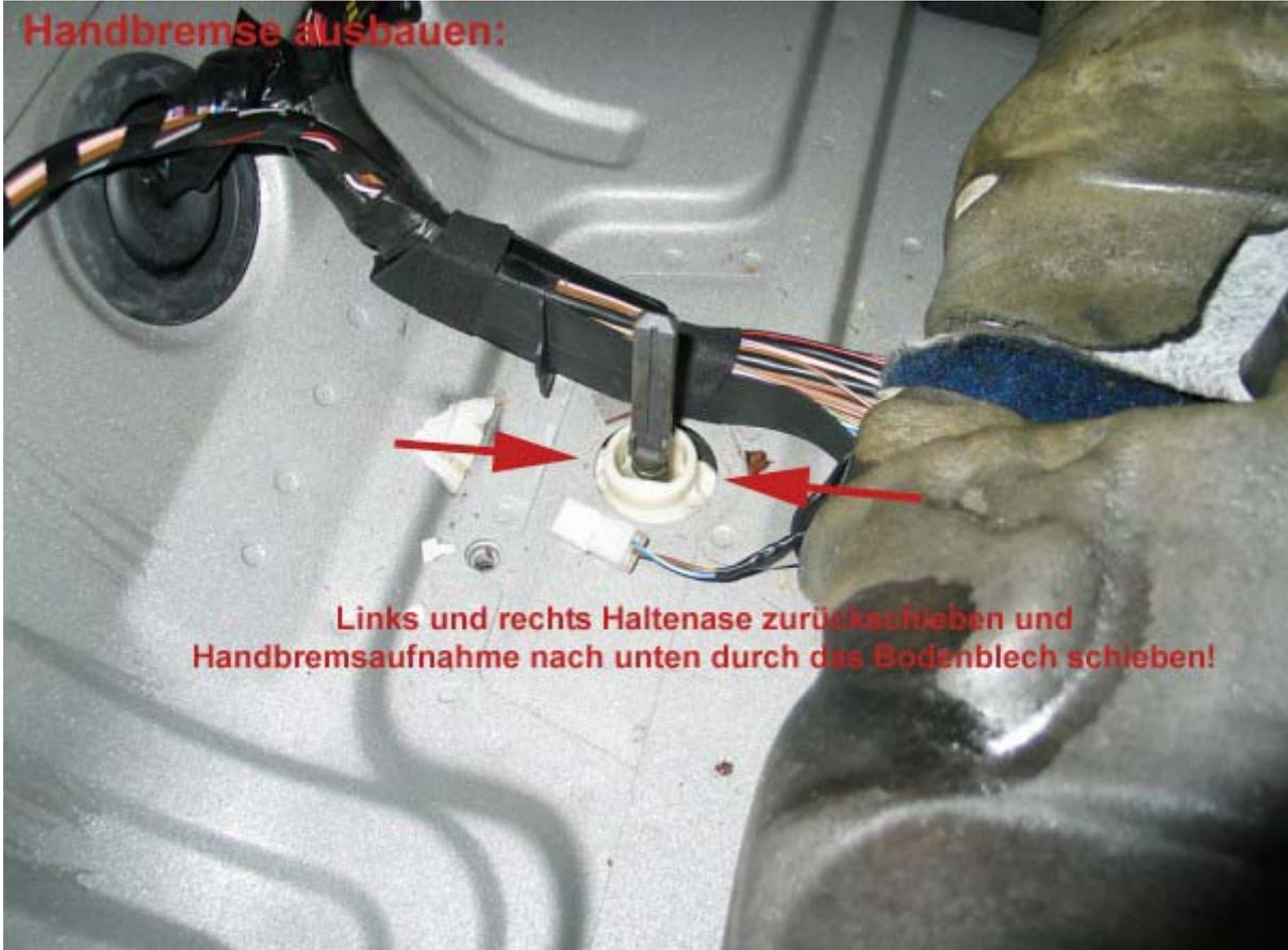
**Links und rechts Haltenase zurückziehen und Handbremsaufnahme nach unten durch das Bodenblech schieben!**
