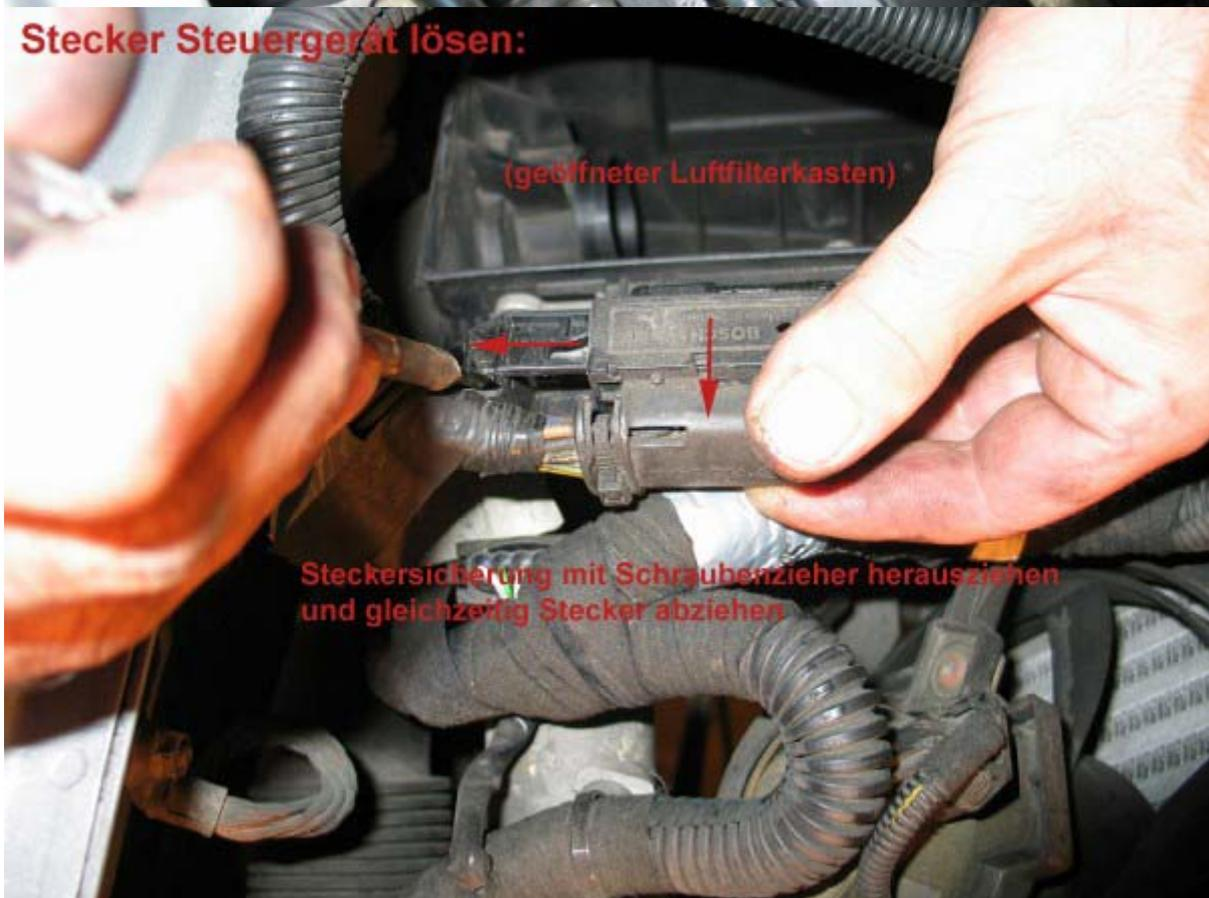
**Steckersicherung mit Schraubenzieher herausziehen
