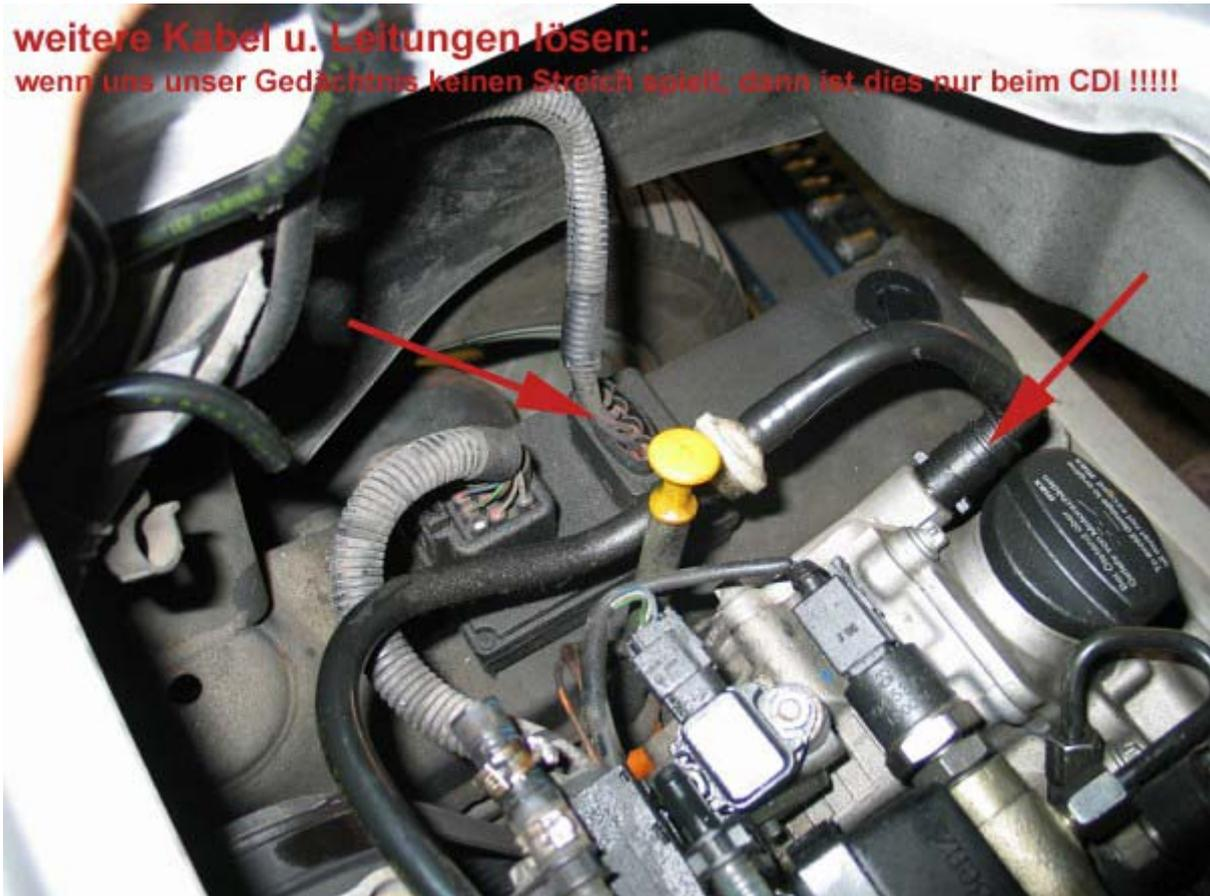
**Stecker Steuergerät lösen:**
