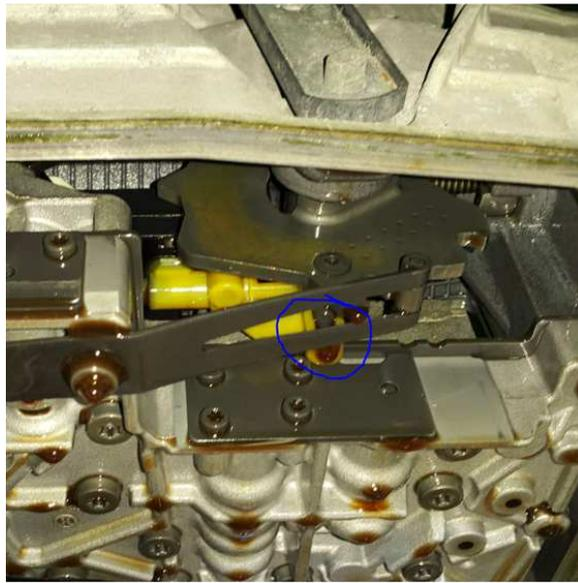
(3) Steckrohr- zwischen EHS und Getriebegehäuse(sieht man nicht solange die EHS an Getriebe ist)
