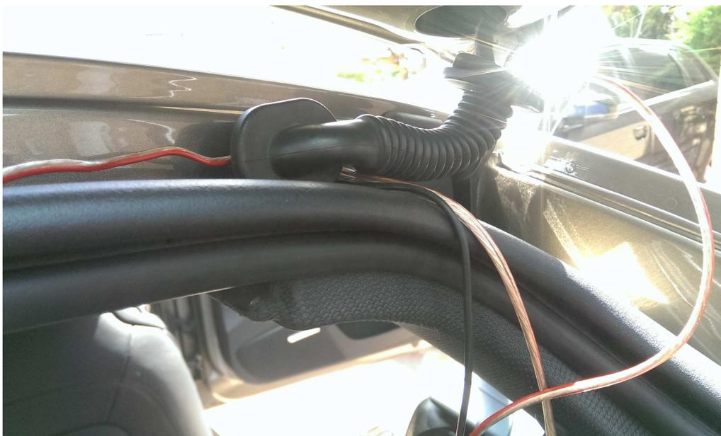
*Bild 9 - Heckklappe -Kabelführung durch die Gummitülle.*
