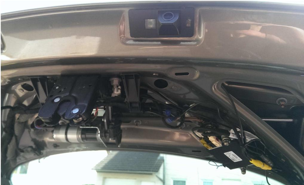
*Bild 11 - RFK in der Heckklappe mit richtigem Winkel :-)*
