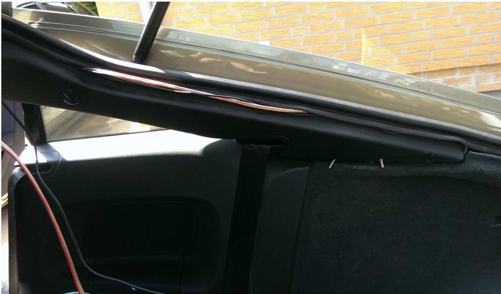
*Bild 8 - Heckklappe -Kabelführung bis hoch zur Gummitülle.*
