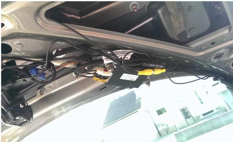
*Bild 12 - Ordentlich verlegte und befestigte Kabel in der Heckklappe*
