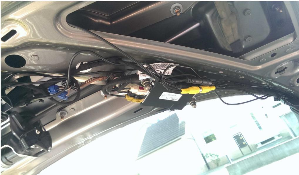
*Bild 4 - Heckklappe ohne Verkleidung und mit Kabeln der Kamera*
