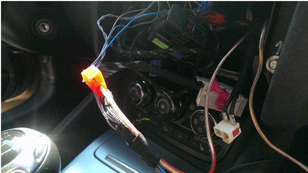
*Bild 2 - Kameraleitung an PIN3 des Kufatec Kabelsatzes (blaue Leitung)*
