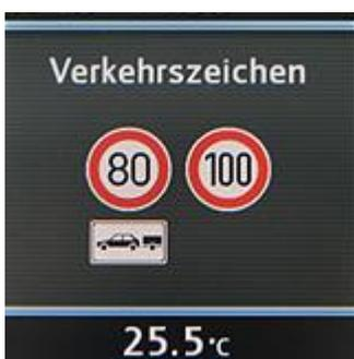
Die Verkehrszeichen werden mit den Daten der Kamera und des Navis abgeglichen und angezeigt.
