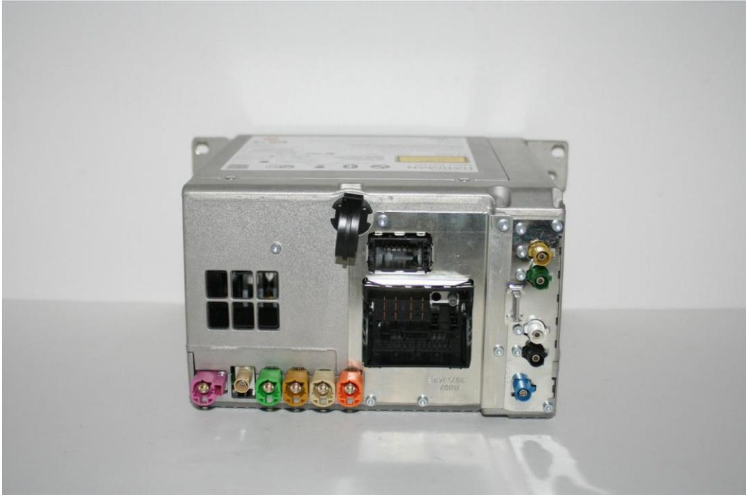
Der orange Anschluss unten in der Mitte ist für der Ethernet Anschluss für den RSE Rechner.
