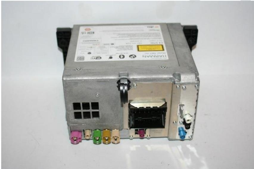
Das nächste Bild zeigt eine HU die sowohl den TV/DVD Anschluss (A42\*3B über dem Quadlock) als auch die 2 DAB Eingänge (gelb und grüner Anschluss rechts oben) besitzt. Der orange Anschluss ist für das Fond Entertainment System.
