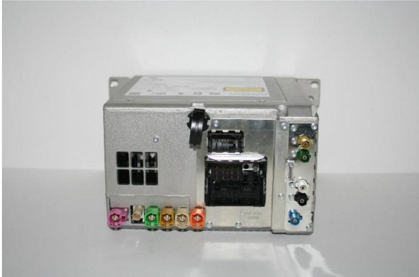
Nach dem Tausch der HU müssen alle FSC's der alten HU in die neue übertragen werden damit die bisher verwendeten Funktionen wieder laufen. Wenn das erledigt ist sollte man noch im Connected Drive Menü eine Aktualisierung der Dienste anstoßen, weil bei mir z.B. sämtlich Dienste nicht nutzbar waren RTTI z.B. . Danach sollte alles wie bisher funktionieren.
