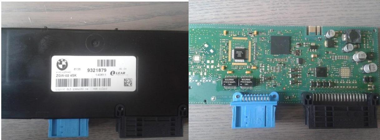
Beim ZGW 8SK mit allen 8 Flexray Ports sind die fehlenden 4 IC's rechts über dem schwarzen Buchsengehäuse verbaut plus der Koppler über den vier Ports.
