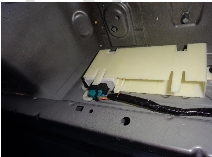
Den entsprechenden Kabelbaum habe ich selbst angefertigt. Das Flexray Bus Kabel geht in den linken vorderen Fußraum zum ZGW Pin 1&2 (Flexray-Port 0x07).
