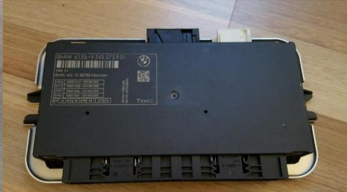
Also FRM ausgebaut und neues (gebrauchtes) rein. Danach normal das FRM mit dem FA codieren und Fehlerspeicher löschen.
