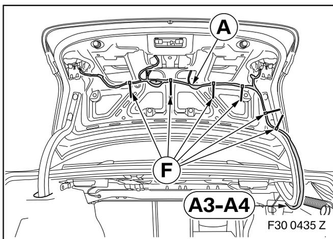
⏏ Falls notwendig, bei Fahrzeugen F31 können die Leitungen mit werkstattüblichen Mitteln, unter Beachtung der BMW Richtlinien für den Umgang mit Kabelbäumen, verlängert und zum Einbauort REM A174 verlegt werden. ◀
