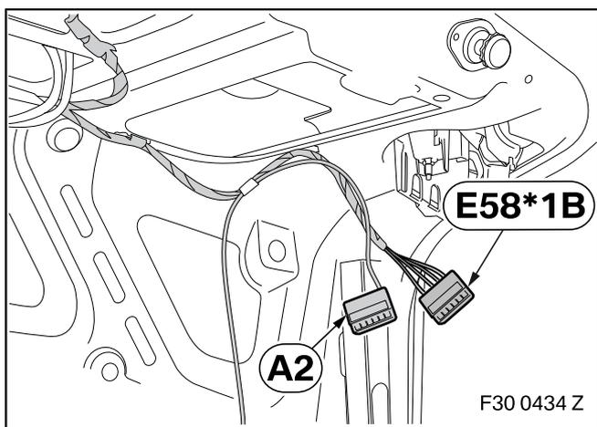
Alle Leitungen wie folgt aus fahrzeugseitigen Stecker **E58\*1B** Heckleuchte Heckklappe rechts ausspinnen und in Buchsengehäuse **A2** einpinnen:
