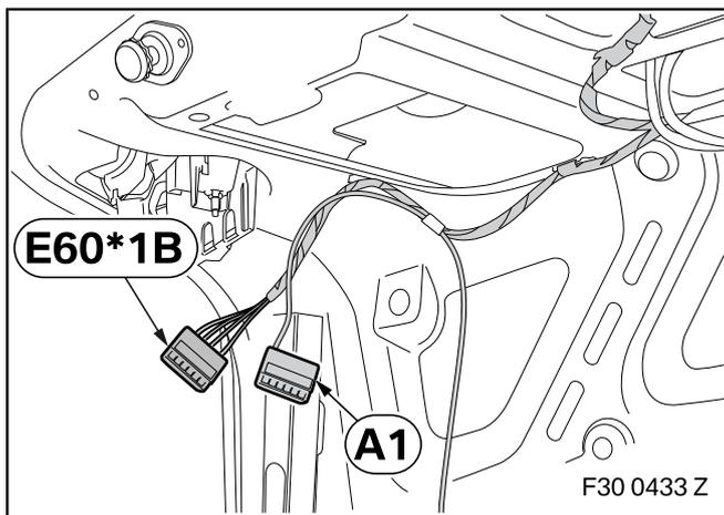
Alle Leitungen wie folgt aus fahrzeugseitigen Stecker **E60\*1B** Heckleuchte Heckklappe links ausspinnen und in Buchsengehäuse **A1** einpinnen:
