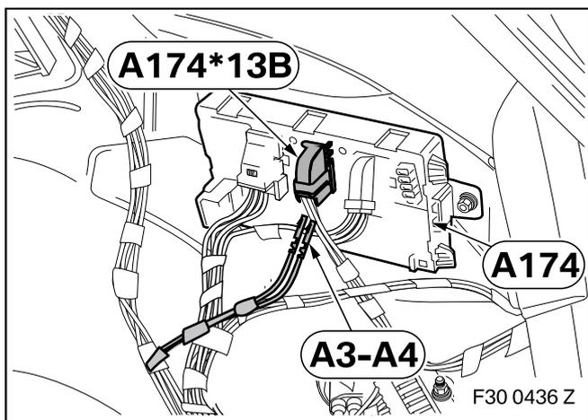
Abzweige **A3-A4** wie folgt in Stecker **A174\*13B**, Buchsengehäuse 26-pol. WS, des Steuergeräts REM **A174** einpinnen:
