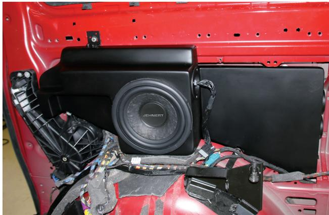
Abb.: Subwoofer im Heckbereich Beifahrerseite hinter der Seitenverkleidung
