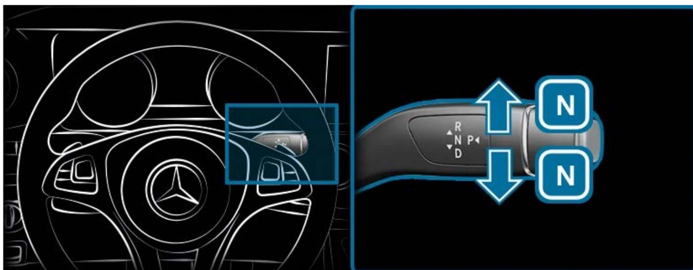
Auf das Bremspedal treten und den DIRECT SELECT Wählhebel bis zum ersten Widerstand nach oben oder unten drücken.
